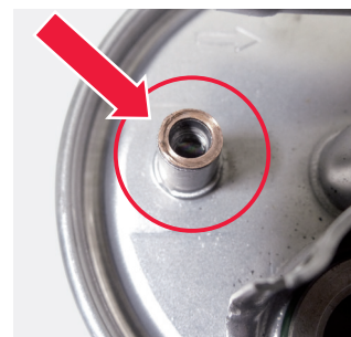
Abbildung 2: Dichtung der Entwässerungsschraube am Dieseldieselkraftstofffilter KL 154
