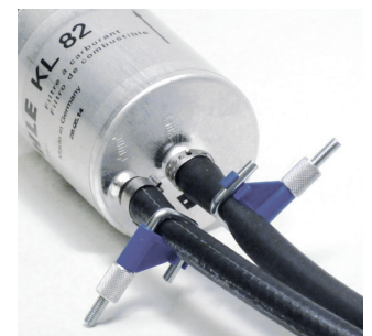
Abbildung 3: Ein Abklemmen der Leitungen verhindert das Eindringen von Luft in das Kraftstoffsystem
