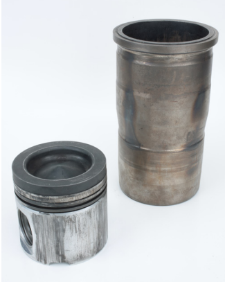
Resim 1: Aşınma izleri gösteren, aşırı ısınmış Ferrotherm piston (piston kafası çelikten, piston eteği alüminyumdan) ve buna ait silindir gömleği
