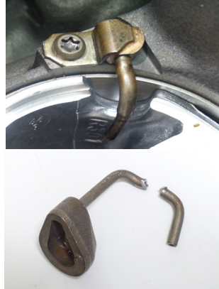
Resim 2: Monte edilmiş (üstte) ve kırılmış (aşağıda) soğutma nozulu
