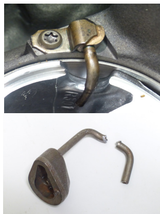
Figura 2: Boquilla de refrigeración montada (arriba) y rota (abajo)
