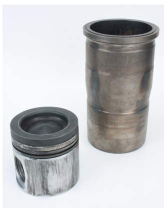
Figura 1: Pistón Ferrotherm sobrecalentado (cabeza de pistón de acero y falda de aluminio) con marcas de gripado y la camisa correspondiente
