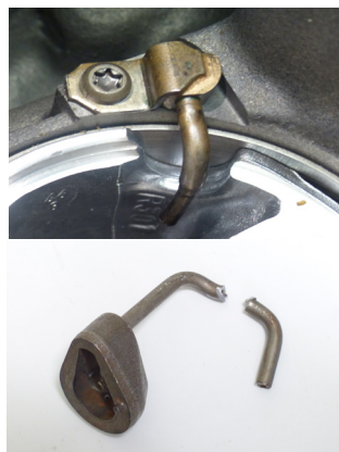
Ilustracja 2: Zamontowana (na górze) i ułamana (na dole) dysza chłodząca
