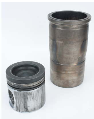
Figure 1: Piston Ferrotherm (tête en acier et jupe en aluminium) surchauffé avec traces de grippage et chemise correspondante.
