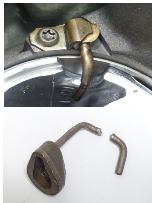
Figure 2: Gicleur de refroidissement monté (haut) et cassé (bas)
