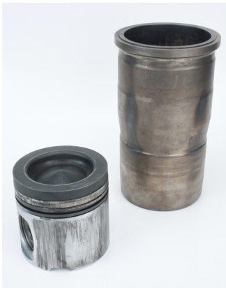
Abbildung 1: Überhitzter Ferrotherm-Kolben (Kolbenkopf aus Stahl und Schaft aus Aluminium) mit Fressspuren und dazugehöriger Laufbuchse
