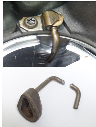
Abbildung 2: Kühldüse eingebaut (oben) und abgebrochen (unten)
