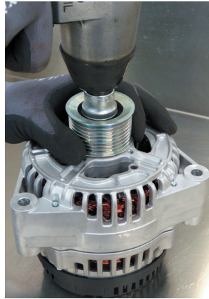
Resim 2: Darbeli anahtar, yalnızca alternatör kasnağını sökmek için kullanılmalı ve sıkılmak için KULLANILMAMALIDIR!
