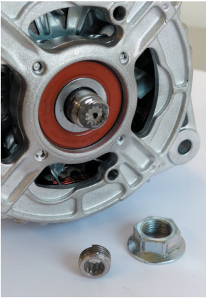
Resim 1: Kırılmış vida dişi
