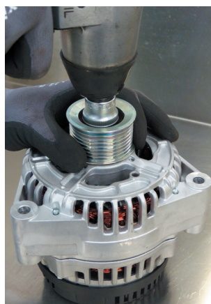
Ilustracja 2. Wkrętaki udarowe mogą być używane tylko do luzowania koła pasowego, NIE do dokręcania!
