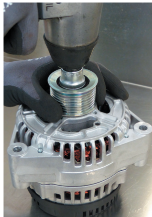
Figure 2 : Utilisez une visseuse à percussion uniquement pour desserrer la poulie, PAS pour la serrer !
