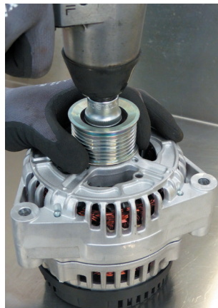
Figura 2: ¡Los destornilladores percutores solo se pueden usar para soltar la polea, NO para apretarla!
