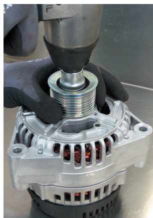
Abbildung 2: Schlagschrauber dürfen nur zum Lösen der Riemenscheibe benutzt werden, NICHT zum Festziehen!
