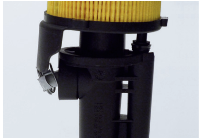
Abbildung 4: Detailansicht des folgeschädigten Bypassventils.
