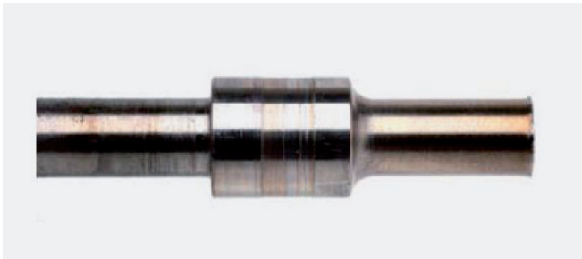
Resim 2: Milin yataklama noktalarında belirgin aşınma izleri
