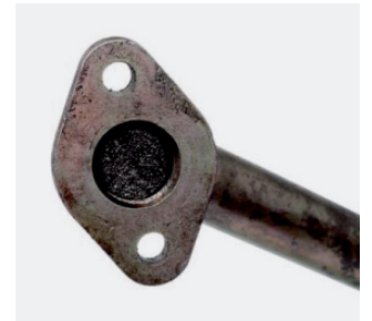
Resim 4: Kurumlanmış yağ geri dönüş borusu
