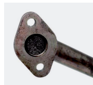
Ilustracja 4: Przewód powrotny oleju, zanieczyszczony nagarem
