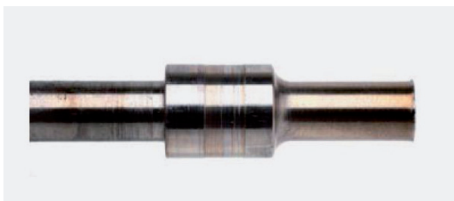
Ilustracja 2: Wyraźne ślady zużycia na wale w łożyskowaniu
