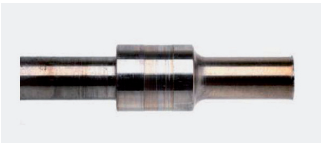
Photo 2 : Traces d'usure évidentes de l'arbre sur les surfaces de coussinets
