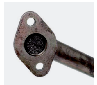
Photo 3 : Canalisation de retour d'huile carbonisée
