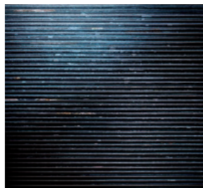
Bild 2: Nach 12 Monaten bzw. einem Jahr: Der Innenraumluftfilter ist so verstopft, dass auch die Aktivkohle nicht mehr wirken kann.
