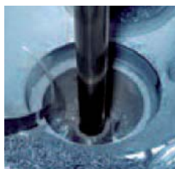
Bild 2: Nach dem Ausfräsen bleibt ein Reststück des Rings sichtbar.
