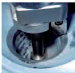
Bild 1: Der Ventilsitzring wird ausgefräst.
