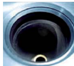
Bild 6: Das optimale Montageergebnis mit erneuertem Ventilsitzring.
