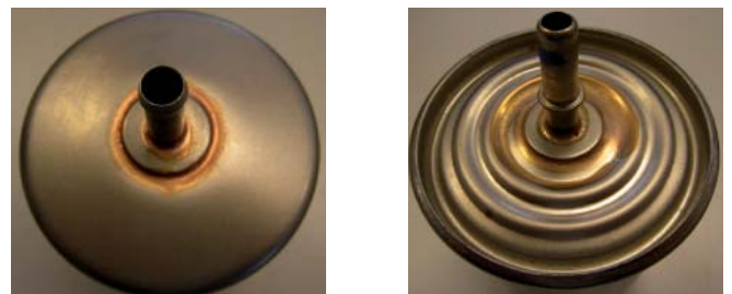
Bild 2 und 3: Kraftstofffilter mit Lötückständen
