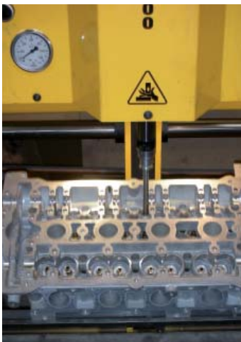
Bild 1: Auspressen der Ventilverführung
