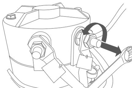
**3.3** Je nach Anwendung kann der Elektromotor als Pumpen- oder Traktionsmotor eingesetzt werden. Lösen Sie in beiden Fällen die Befestigungsschrauben, und entfernen Sie den Elektromotor von der Pumpe bzw. dem Getriebe. Befolgen Sie die Anweisungen des Maschinen- bzw. Systemherstellers.
