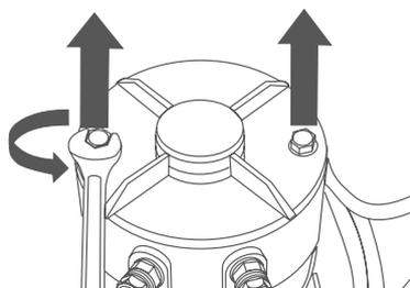
**3.4** Stellen Sie sicher, dass der zu installierende Motor dem ausgebauten Motor entspricht. Überprüfen Sie anhand des Katalogs die Elektroteilennummer, die Drehrichtung, die Nominalspannung, die Nominalstromstärke, die Einbaumaße, die elektrischen Anschlüsse usw.
