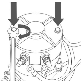
**3.8** Schließen Sie die Elektrokabel am Elektromotor an. Achten Sie auf eine korrekte Kabelführung und darauf, dass die Kabel keinen Kontakt mit heißen bzw. scheuernden Oberflächen haben.
