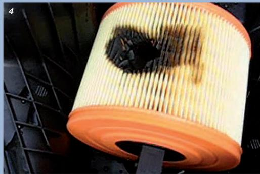
**ON TEST: NORMAL FILTER PAPER VS. FLAME RETARDANT FILTER MEDIA**
