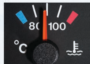
Le thermostat cartographique fonctionne discrètement, le conducteur n'est pas informé des variations de température et c'est intentionnel.
