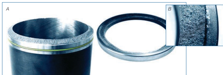
A: Гильза цилиндра с изломом по бурту, произошедшим по причине неправильного монтажа.
