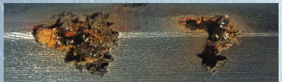
Im Schnitt wird das typische Kavitations-Schadensbild noch deutlicher: Einfressungen, die sich nach innen vergrößern.
