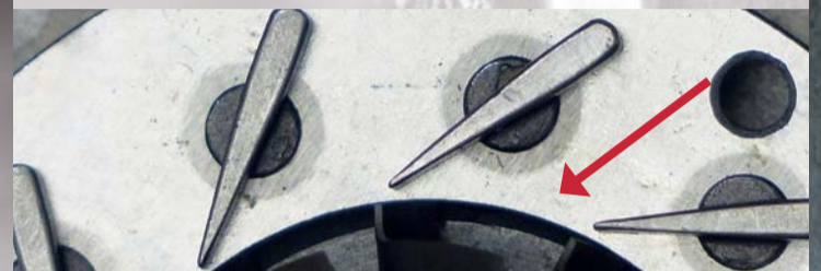
Bild 3: Bei höherer Motordrehzahl sind die Leitschaufeln des VTG-Turboladers geöffnet, damit die volle Energie des Abgasstroms auf die Turbinenfläche trifft.
