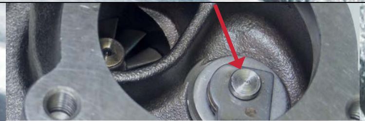
Bild 1: Pkw-Turbolader mit Wastegate zur Ladedruckregelung. Bei geöffneter Klappe strömen die Abgase am Turbinenrad vorbei – die Turbinendrehzahl und somit auch der Ladedruck sinken.
