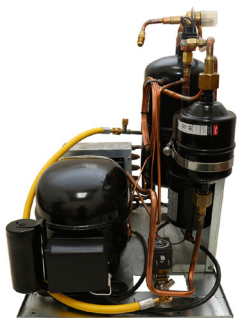
Equipamento com filtro antigo.
