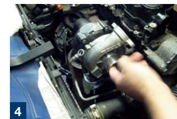
Montando a nova junta da flange de admissão.
