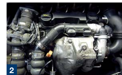
O turbocompressor é instalado na frente do motor.
