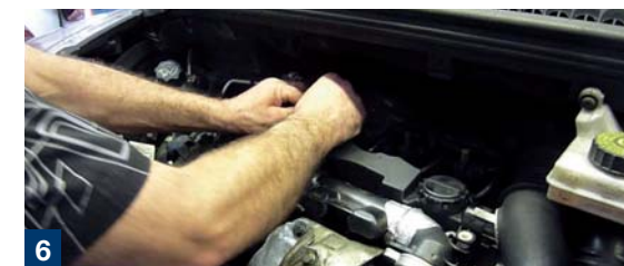
Antes da partida inicial: desconectar os plugues dos injetores e deixar o motor rodar somente com o motor de partida por 30 segundos. Então, recolocar os plugues de forma que eles se encaixem em seus lugares.
