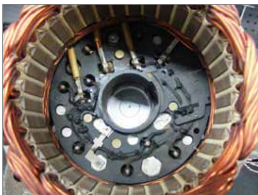
Fig. 3.02 – Queima ou rompimento dos diodos positivos.
