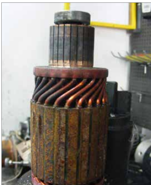
Fig. 5.01 – Oxidação da carcaça do induzido.
