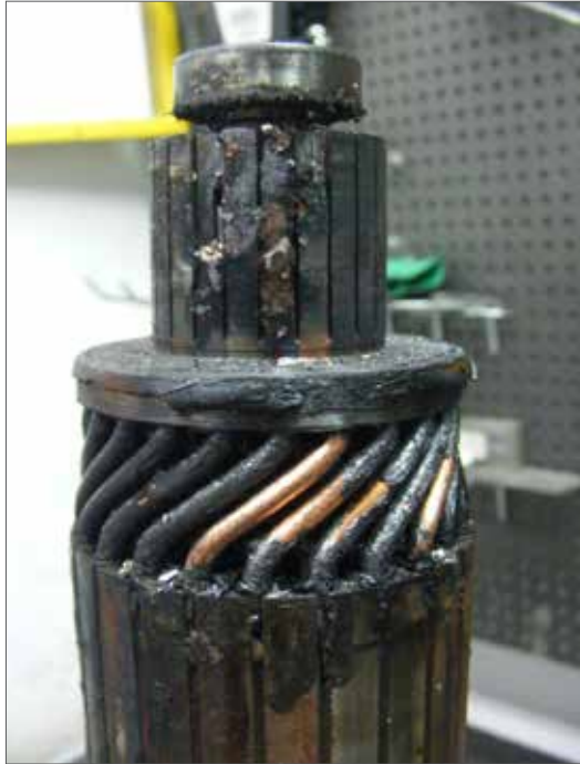
Fig. 3.03 – Expansão e perda da isolação dos filamentos do induzido.
