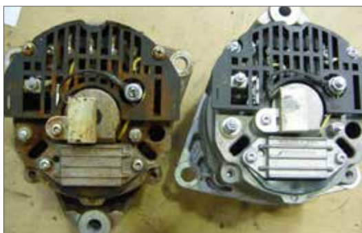
Fig. 4.06 – Componentes posicionados de forma incorreta.
