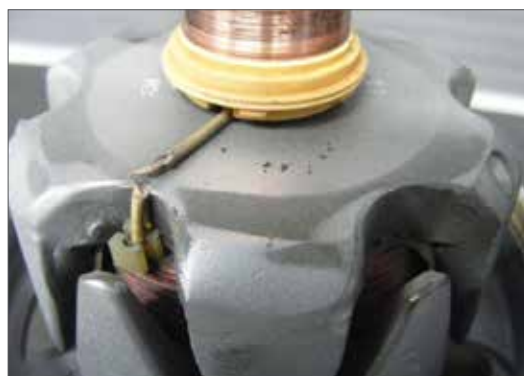
Fig. 1.04 – Rotação obstruída do rotor e rompimento de sua bobina.
