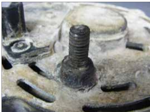
Fig. 5.04 – Oxidação dos terminais.
