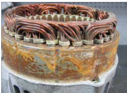
Fig. 5.02 – Oxidação no pacote do estator.
