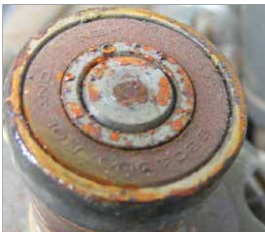
Fig. 5.02 – Oxidação dos rolamentos.
