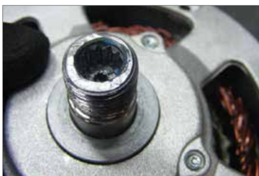
Fig. 4.07 – Rosca do eixo danificada.
