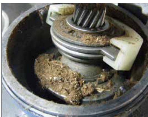
Fig. 4.04 – Bloqueio do movimento do solenóide e alavanca de acionamento.
