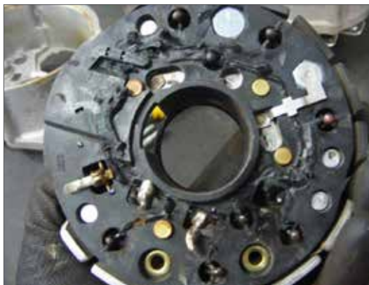
Fig. 1.02 – Curto circuito ou queima da ponte retificadora.
