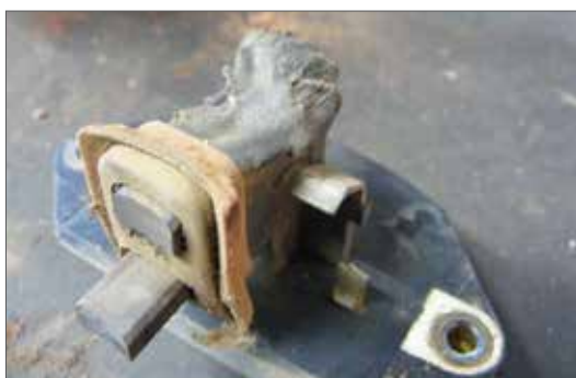
Fig. 3.01 – Queima do regulador de tensão.
