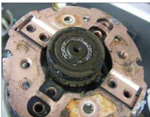
Fig. 4.01 – Ruídos e desgaste precoce dos rolamentos.
