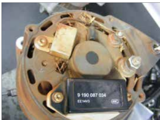
Fig. 4.05 – Instalação de componentes de outro fabricante.
