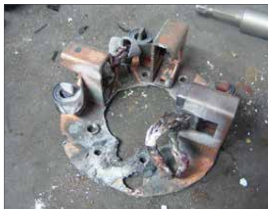
Fig. 2.02 – Coletor e porta escovas completamente destruídos.
