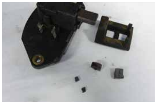
Fig. 4.03 – Quebra das escovas do regulador de tensão.
