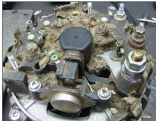
Fig. 1.03 – Curto Circuito ou queima da ponte retificadora.
