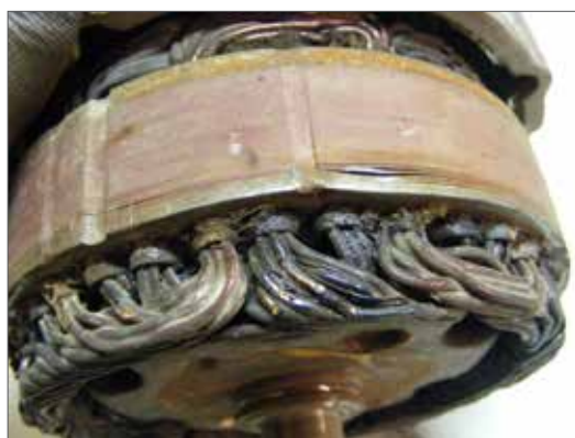
Fig. 3.05 – Queima da bobina do estator.
