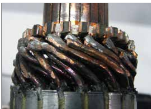
Fig. 3.02 – Rompimento dos filamentos do induzido.
