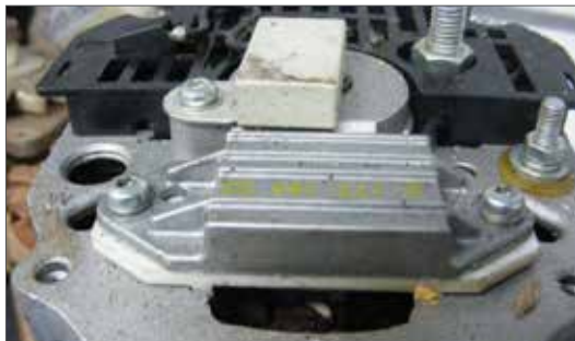
Fig. 4.04 – Falta de terminais no alternador.
