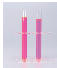
Ilustracja 3: Trudności w odróżnieniu na podstawie kolorów: na ilustracji płyn chłodniczy OAT (po lewej) i HOAT (po prawej).
