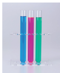
Ilustracja 2: Warianty płynów chłodniczych od lewej do prawej IAT, OAT, HOAT
