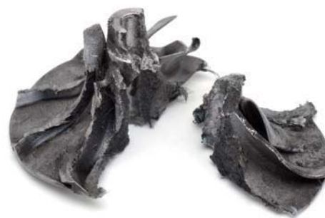
Zdj. 2 Rozerwany wirnik sprężarki
