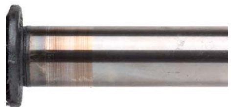
Zdj. 4 Napawany na wałku materiał łożyska
