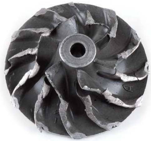
Zdj. 1 Wirnik sprężarki po uderzeniu w korpus
