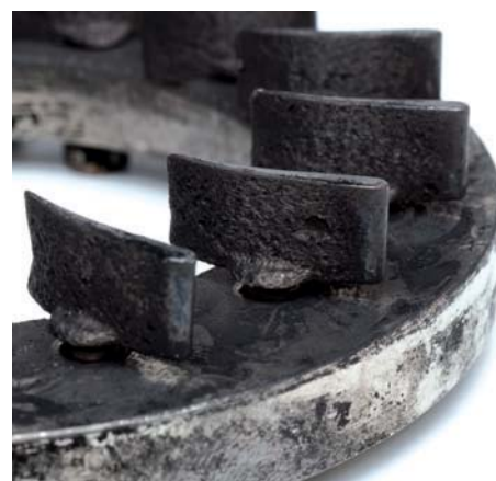
Zdj. 1 Uszkodzone kierownice powietrza w zespole VTG
