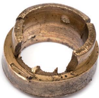
Zdj. 7 Zniszczone łożysko promieniowe
