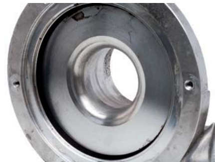
Zdj. 2 Ślady tarcia w korpusie sprężarki
