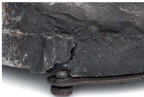
Zdj. 1 Pęknięcie korpusu turbiny
