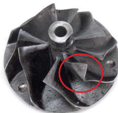
Zdj. 4 Uszkodzona tylko jedna łopata wirnika sprężarki
