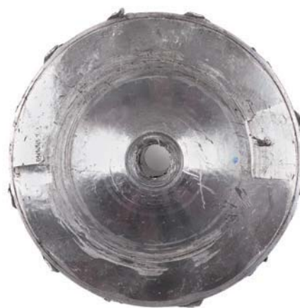
Zdj. 1 Wgniecenia od tyłu wirnika sprężarki
