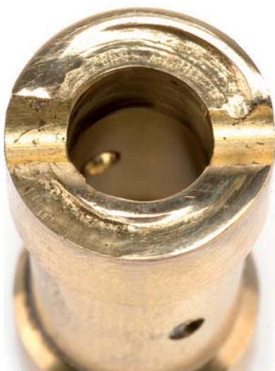
Zdj. 6 Obrócona tuleja łożyskowa
