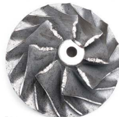
Zdj. 2 Wirnik sprężarki, uszkodzony przez ciała obce
