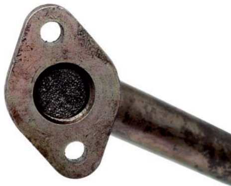
Zdj. 1 Przewód powrotny oleju, zanieczyszczony nagarem
