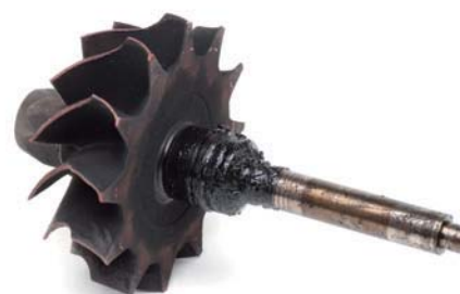
Zdj. 3 Nagar olejowy po stronie turbiny
