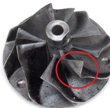
Fig. 4 Une seule ailette de la roue du compresseur endommagée
