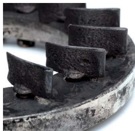
Fig. 1 Ailettes de l'unité TGV endommagées
