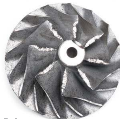
Fig. 2 Roue de compresseur endommagée par des corps étrangers
