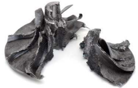
Fig. 2 Roue de compresseur cassée
