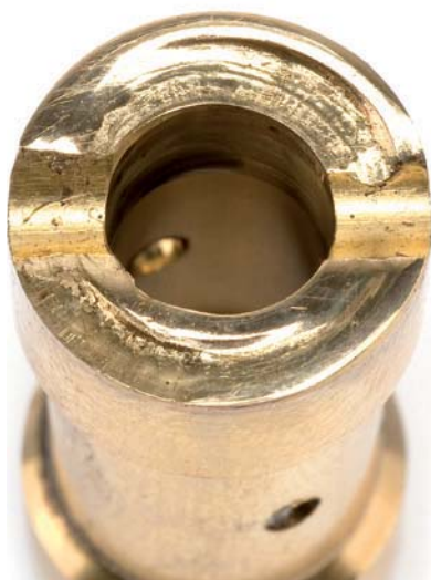
Fig. 6 Coussinet de palier déformé
