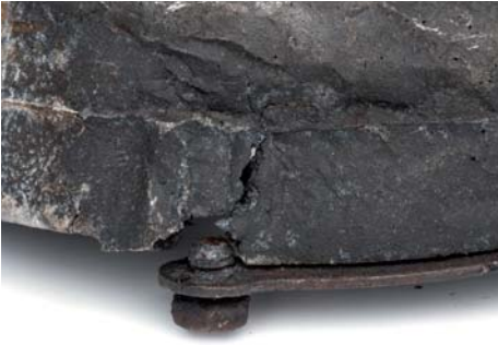
Fig. 1 Fissure dans le carter de turbine
