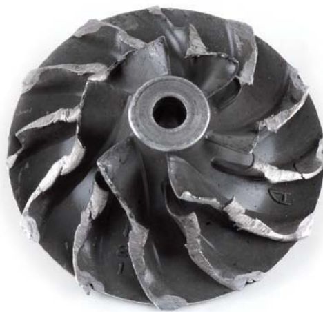
Fig. 1 Roue de compresseur ayant heurté le carter
