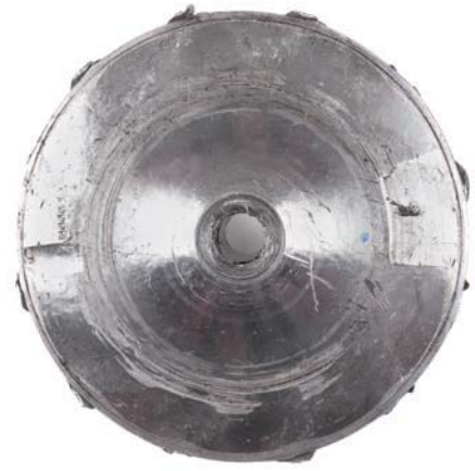
Fig. 1 Roue de compresseur bosselée (surface extérieure)
