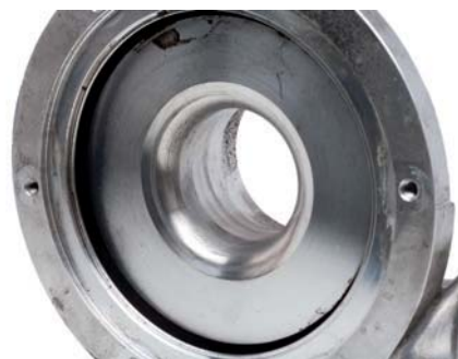
Fig. 2 Stries dans le carter du compresseur
