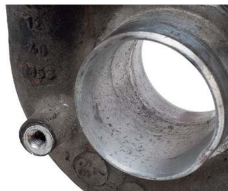
Fig. 3 Impacts de corps étrangers dans la conduite d'aspiration du carter du compresseur
