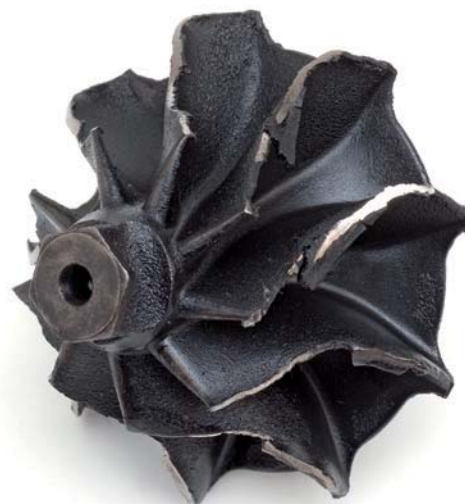
Fig. 2 Roue de turbine ayant heurté le carter
