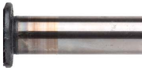
Fig. 4 Matériau de palier soudé sur l'arbre
