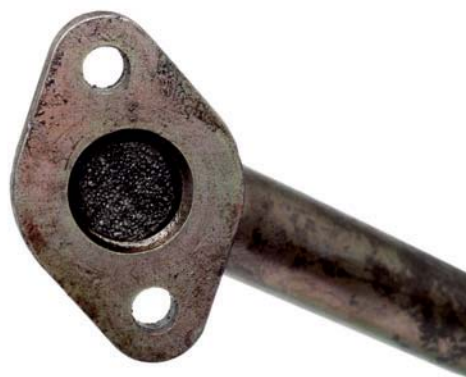
Fig. 1 Canalisation de retour d'huile carbonisée
