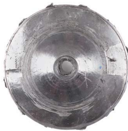
Fig. 1 Abolladuras en el lado trasero de la rueda del compresor
