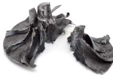
Fig. 2 Rueda del compresor partida
