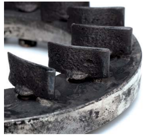
Fig. 1 Álabes del turbo de geometría variable dañados
