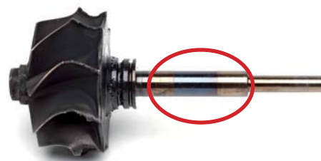
Fig. 3 Decoloración del vástago de eje
