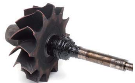
Fig. 3 Aceite carbonizado en el lado de la turbina
