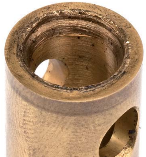
Fig. 1 Estrías en el cojinete radial
