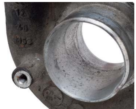
Fig. 3 Impactos de cuerpos extraños en el canal de admisión de la carcasa del compresor
