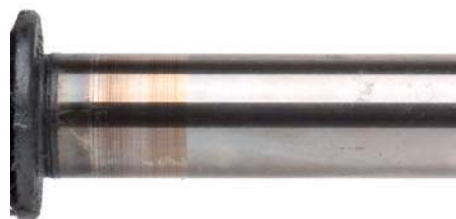
Fig. 4 Material de cojinete soldado sobre el eje
