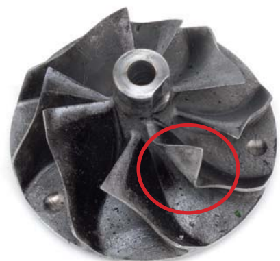
Fig. 4 Solo una aleta de la rueda del compresor dañada
