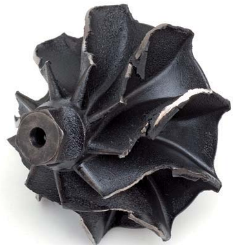
Fig. 2 Rueda de turbina que roza en la carcasa
