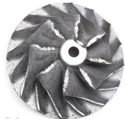
Fig. 2 Rueda de compresor dañada debido a partículas extrañas
