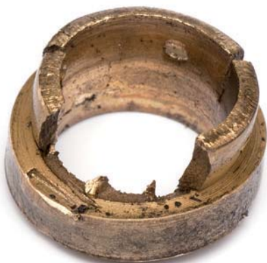
Fig. 7 Cojinete radial fracturado
