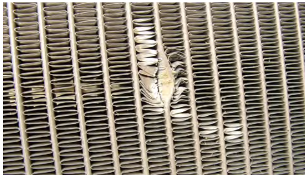
Resim 3 Radyatöre taş çarpması
