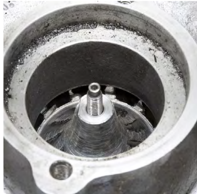
Resim 2 Turbo hasarından kaynaklanan talaşlar
