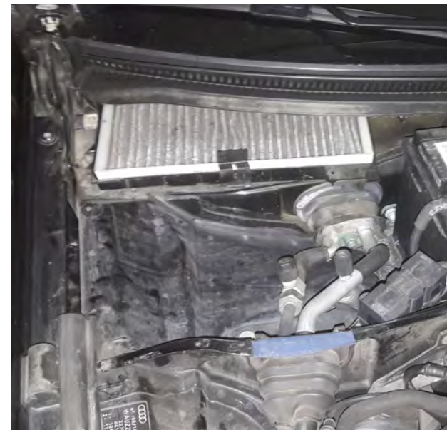
Resim 1 Aşırı kirlenmiş kabin filtresi
