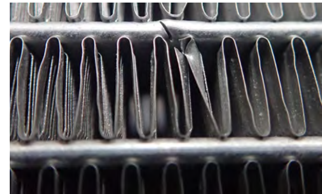
Resim 3 Mekanik hasar (kesik)
