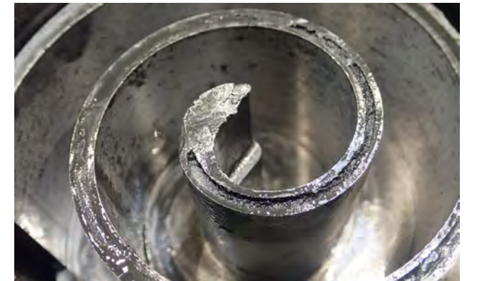
Resim 2 Salyangozda ön taraftaki conta tahrip olmuş
