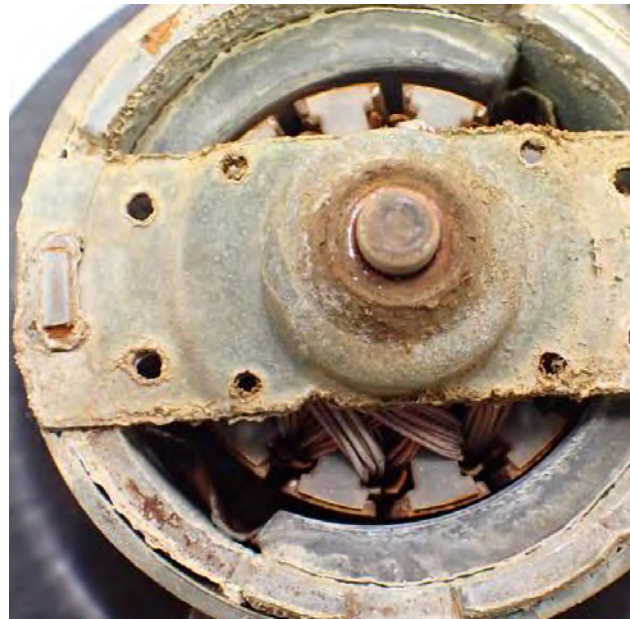
Resim 1 Fan motorunda yatak hasarı
