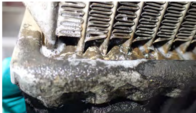
Resim 4 Radyatörün dış kısmında korozyon
