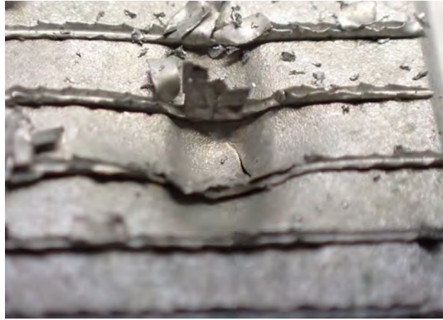
Resim 2 Deformasyon ve çatlak
