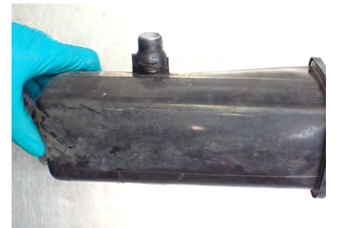
Resim 2 Patlamış genleşme haznesi
