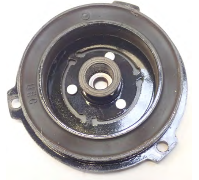
Resim 2 Göbekteki dişler kırılmış
