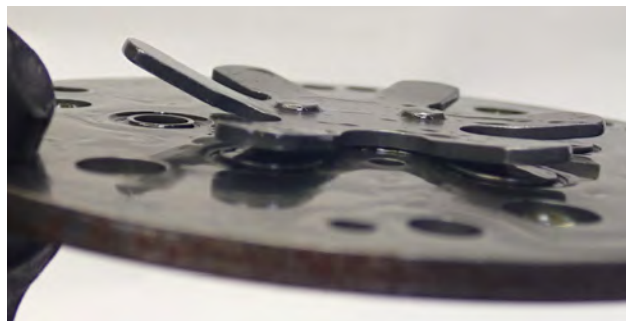
Resim 3 Sınırlama deforme olmuş
