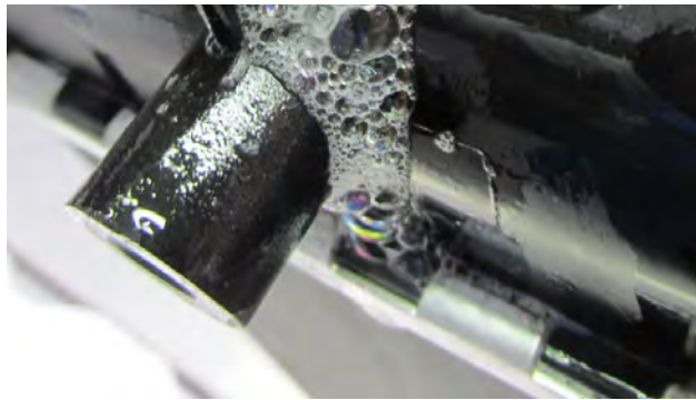
Resim 2 Sabitleme yerinde çatlak
