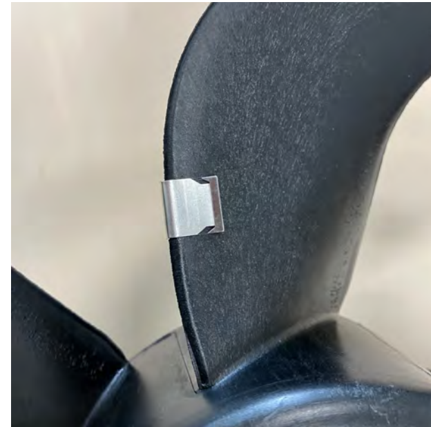
Resim 1 Balanslama ağırlığı olarak metal klips
