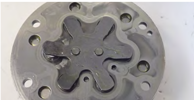
Resim 2 YB valfinin sınırlandırması deforme olmuş
