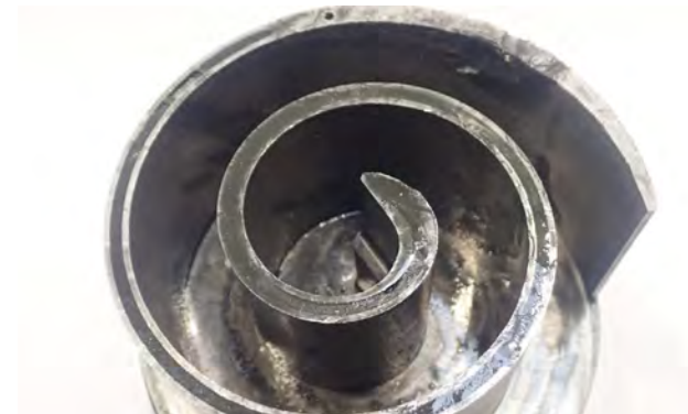
Resim 1 Scroll kompresörün salyangozu aşın derecede aşınmış
