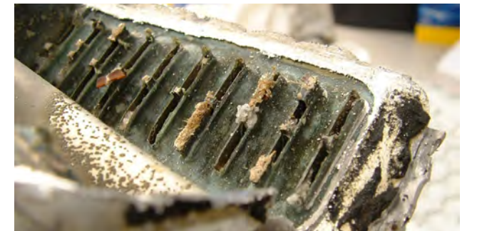
Resim 2 Sızdırmazlık maddesi nedeniyle radyatör tıkanmış
