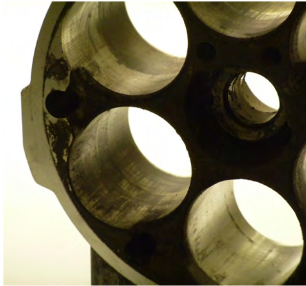
Resim 2 Silindirde sürtünme hasarı
