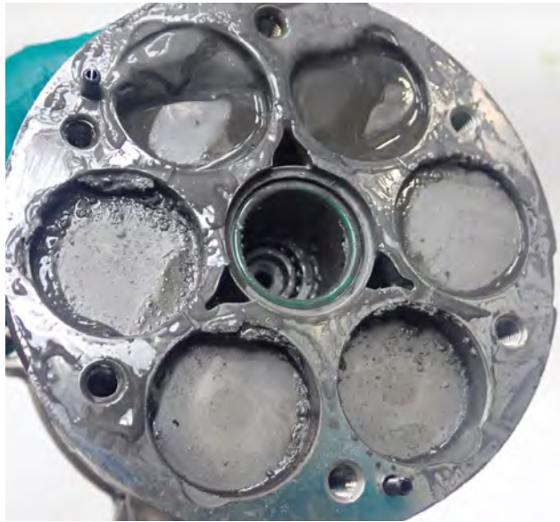
Resim 1 Piston ve silindirde aşırı sürtünme hasarı
