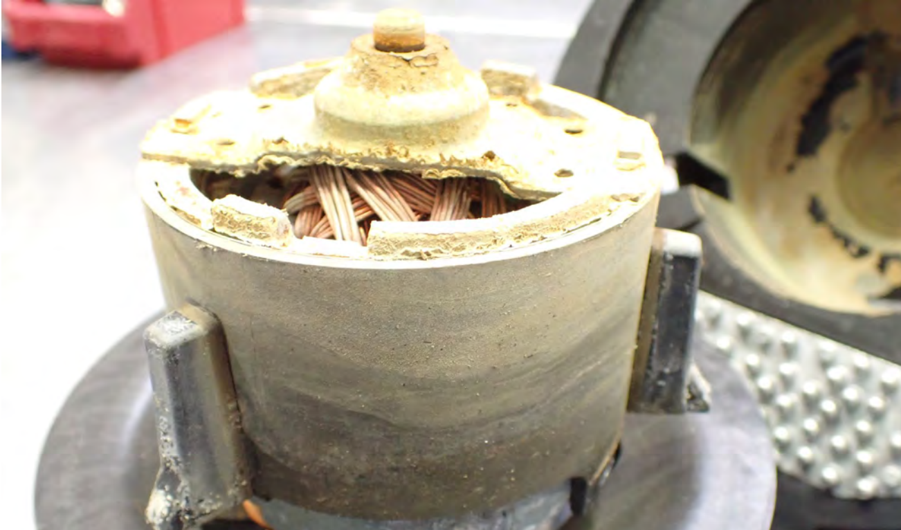
Resim 4 Fan motorunda korozyon
