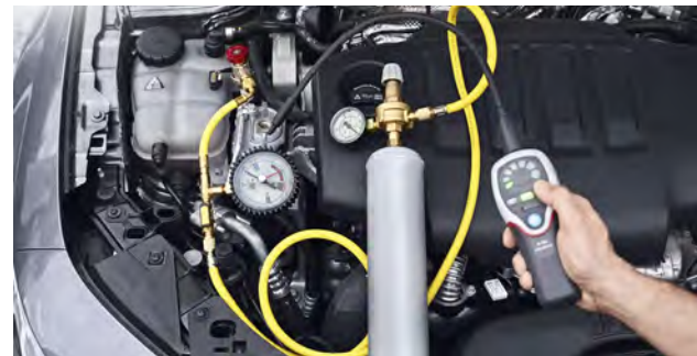
Resim 1 Şekillendirme gazı ile kaçak arama
