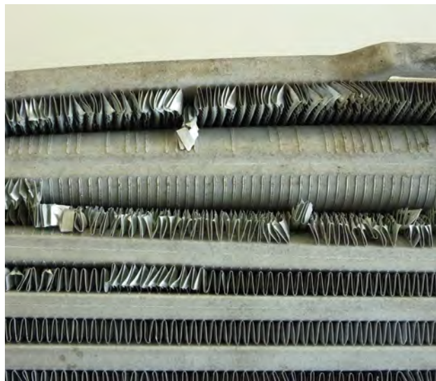
Resim 3 Radyatör borusu şişmiş
