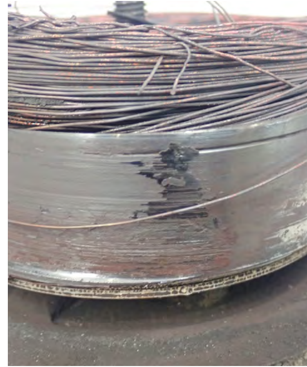
Resim 1 Bobin gövdesinde sürtünme izleri ve bobin yanmış
