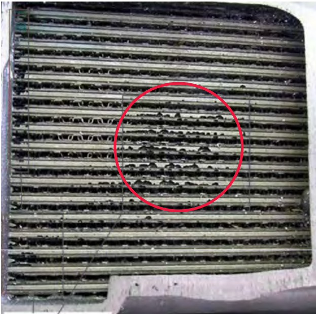
Resim 1 Yağ radyatörünün borularında kavitasyon
