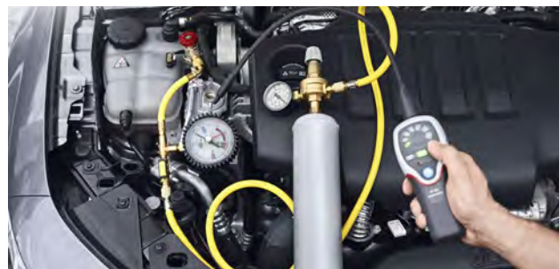
Rys. 1 Wykrywanie nieszczelności gazem formującym
