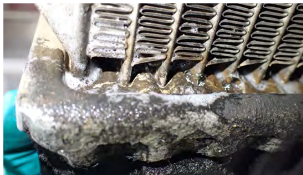
Rys. 4 Korozja na zewnątrz chłodnicy
