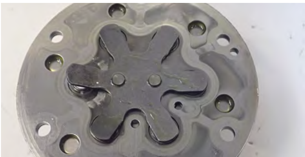
Rys. 2 Zdeformowany ogranicznik zaworu wysokiego ciśnienia
