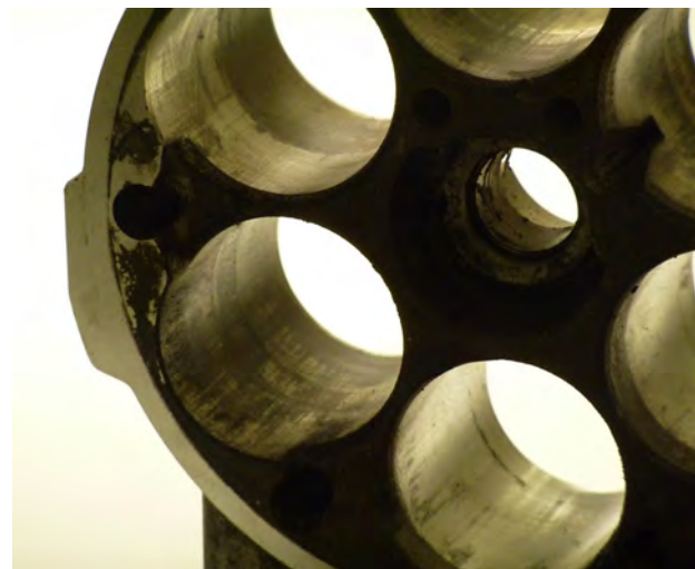
Rys. 2 Zatarcia na cylindrach
