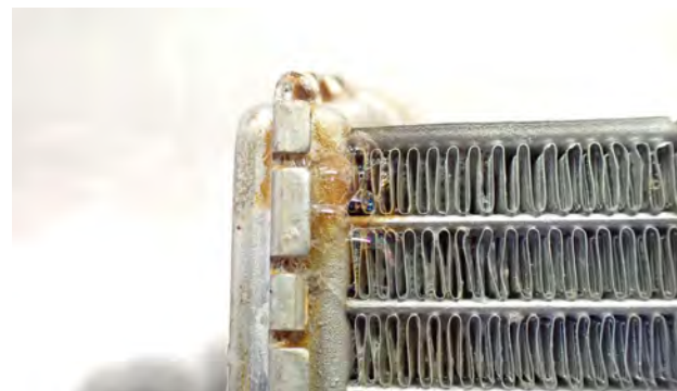
Rys. 4 Zardzewiały wymiennik ciepła
