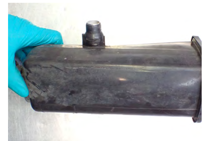
Rys. 2 Pęknięty zbiornik wyrównawczy
