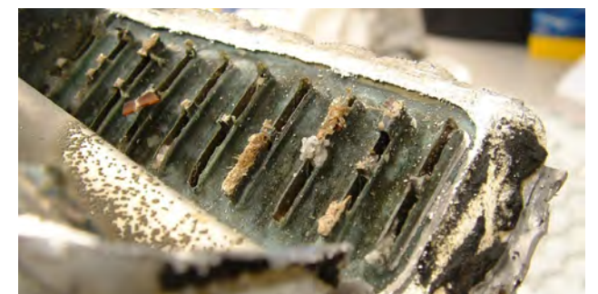
Rys. 2 Chłodnica zablokowana przez środek uszczelniający
