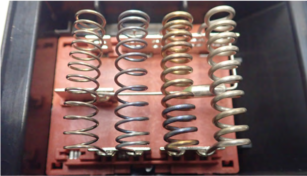
Rys. 3 Przeciążenie regulatora z powodu uszkodzonych wentylatorów
