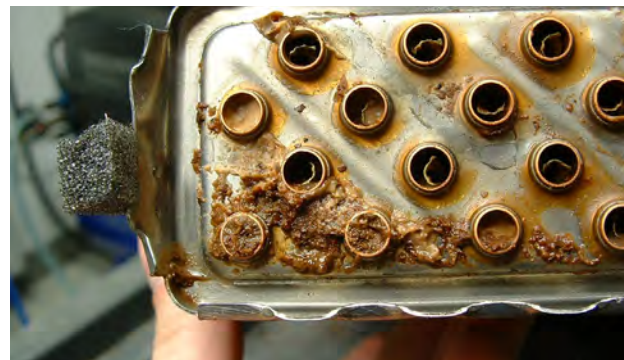
Rys. 2 Zatkany wymiennik ciepła
