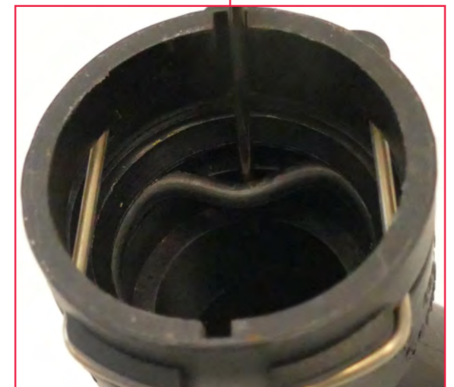
Rys. 3 Należy wymienić o-ring
