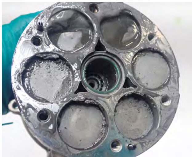
Rys. 1 Mocne zatarcia na tłokach i cylindrach
