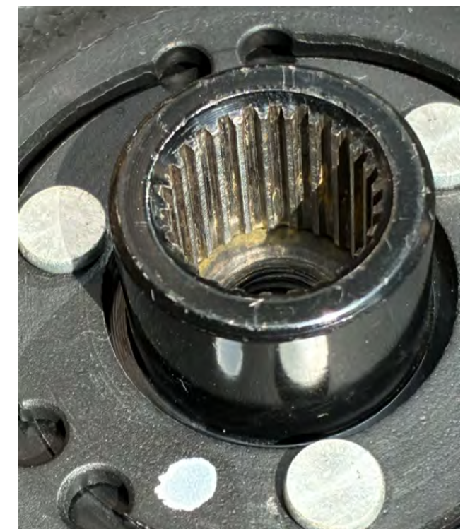
Rys. 4 Do porównania: nowe użębienie
