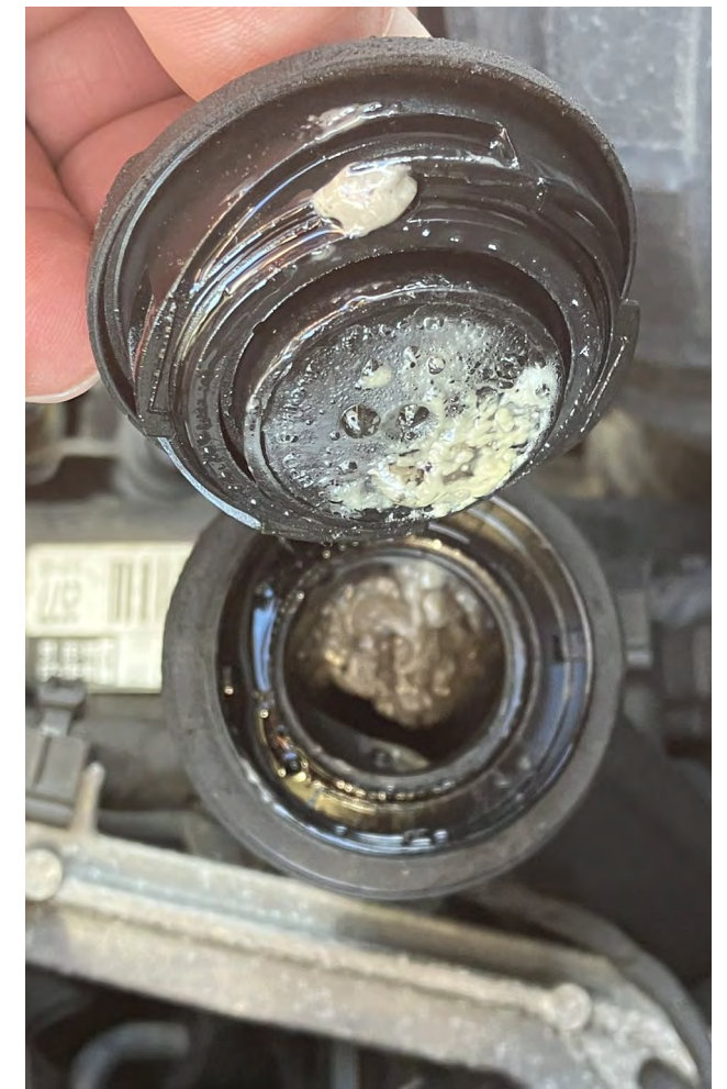
Rys. 3 Emulsja olejowo-wodna na króćcu wlewu oleju
