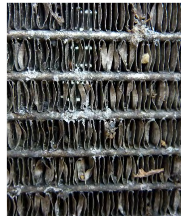
Rys. 2 Zanieczyszczenie na żeberkach chłodzących i deformacja żeber
