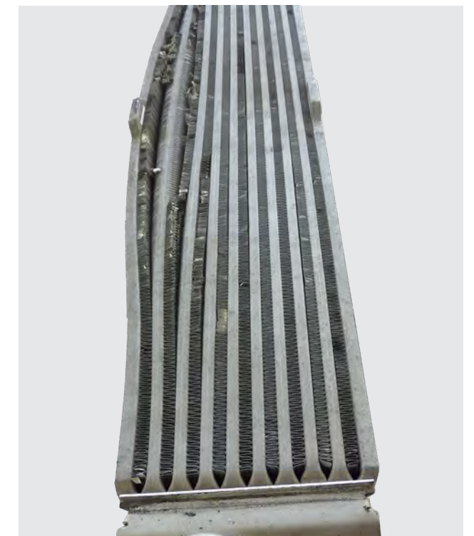
Rys. 2 Spuchnięta chłodnica powietrza doładowującego
