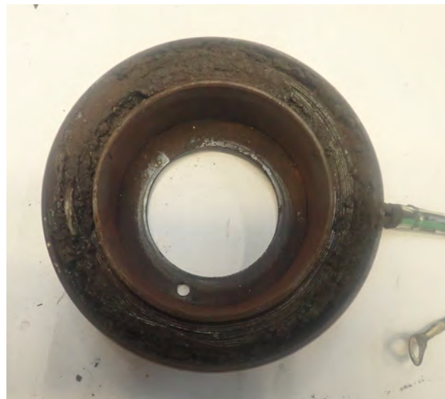
Rys. 1 Cewka elektromagnetyczna przypalona wskutek ślizgającego się sprzęgła
