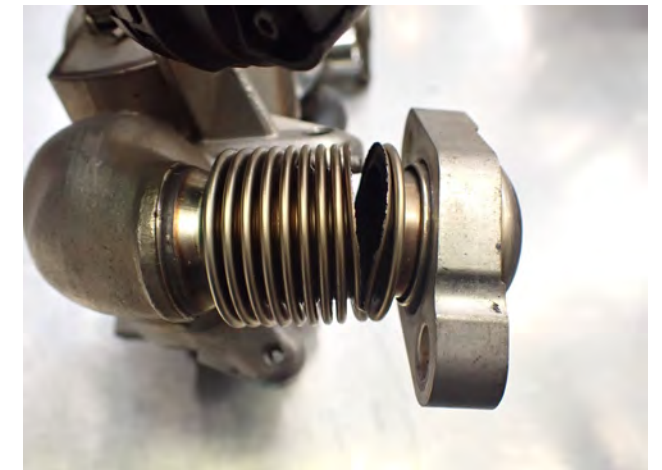
Rys. 2 Rozerwana rura elastyczna chłodnicy EGR
