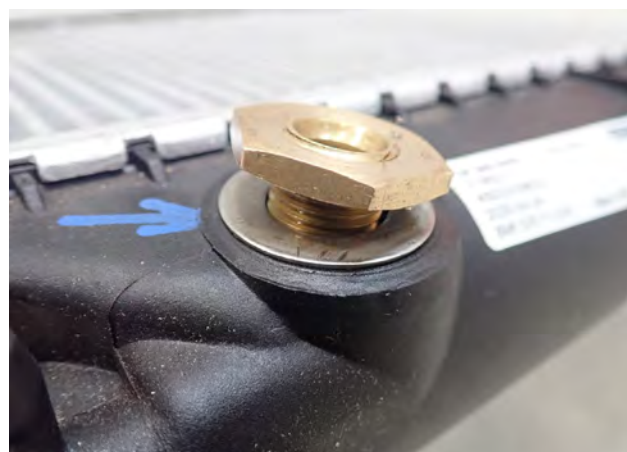
Rys. 3 Połączenie śrubowe przewodu oleju przekładniowego
