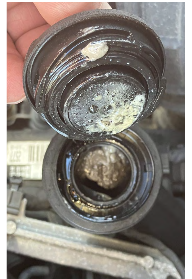
Fig. 3 Émulsion huile-eau dans la tubulure de remplissage d'huile
