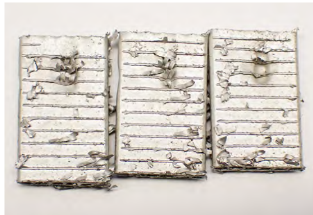
Fig. 1 Déformation des conduites de l'extérieur vers l'intérieur
