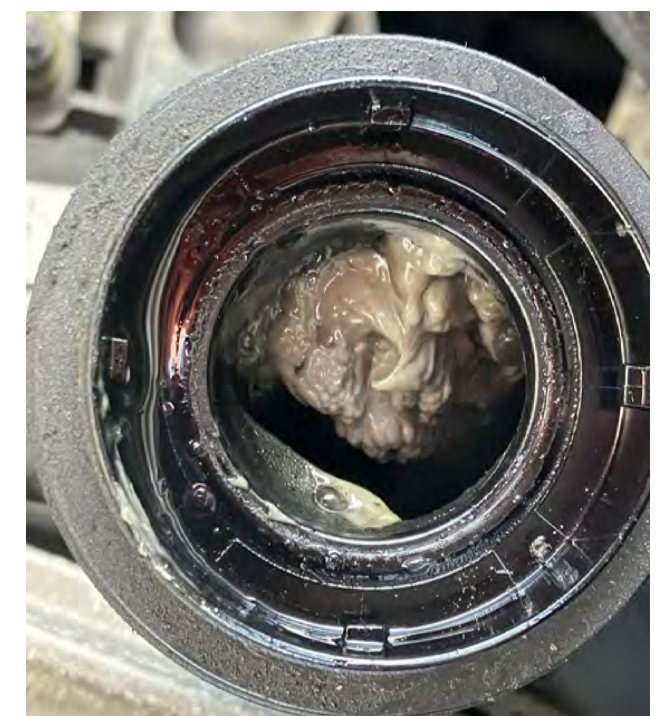
Fig. 3 Émulsion huile-eau sur la tubulure de remplissage d'huile
