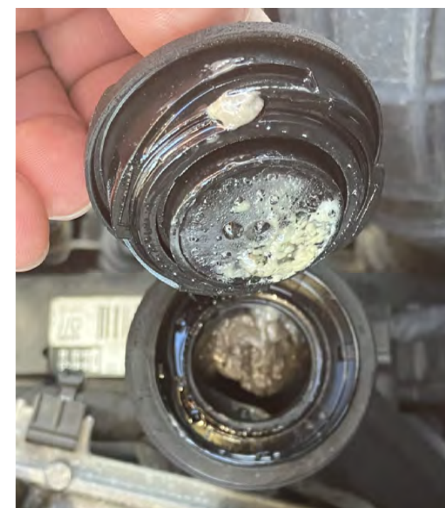
Fig. 2 Émulsion huile-eau sur le bouchon et la tubulure de remplissage d'huile
