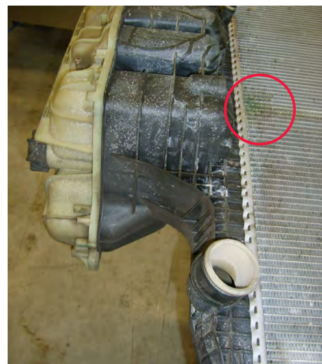
Fig. 1 Fuite apparente sur le radiateur
