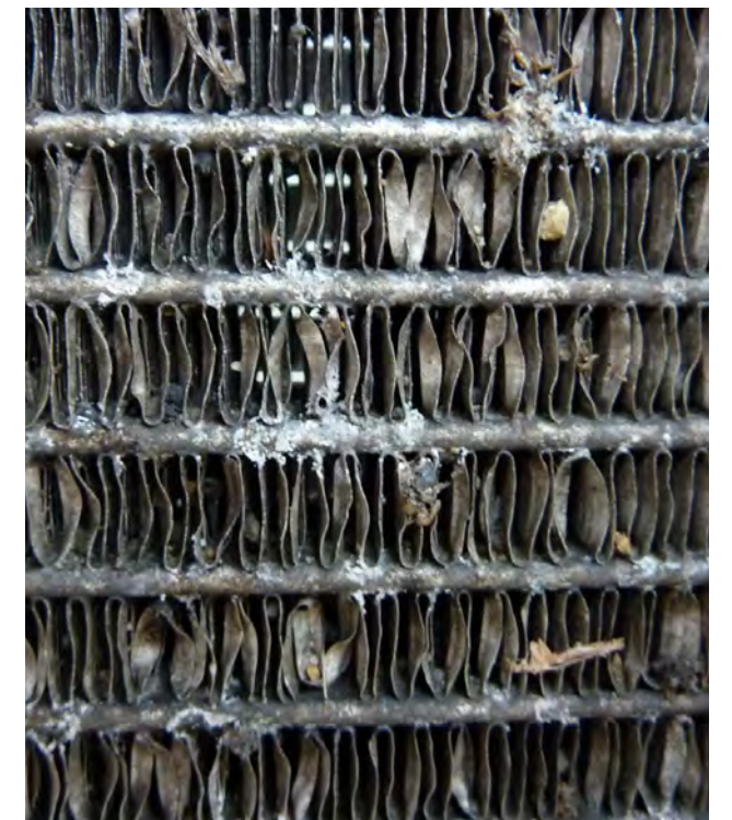
Fig. 2 Ailettes de refroidissement encrassées et déformées
