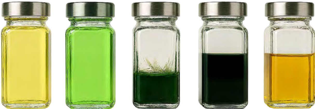
Fig. 1 Huile pour compresseur noire brûlée
