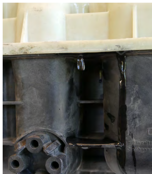
Fig. 2 Fuite de liquide de refroidissement sur le vase d'expansion
