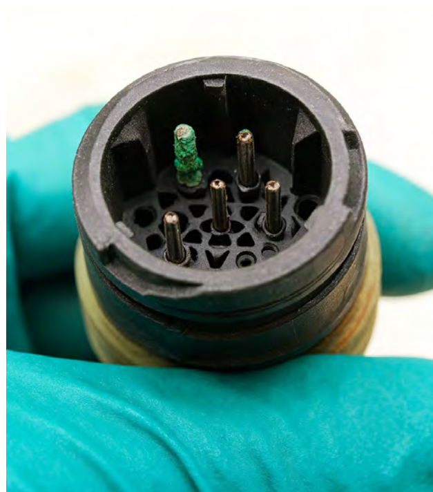
Fig. 1 Corrosion sur la prise
