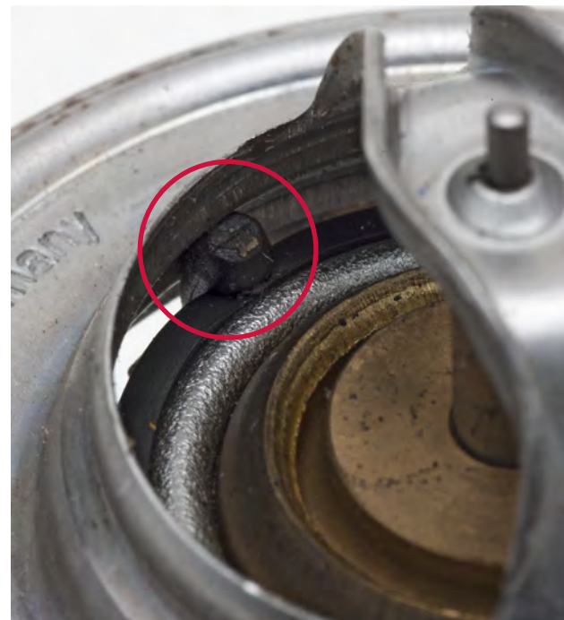
Fig. 1 Corps étranger bloquant la soupape
