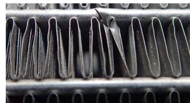
Fig. 3 Dommage mécanique (coupure)
