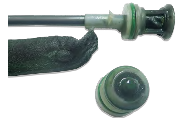
Fig. 2 Filtro deshidratador obstruido
