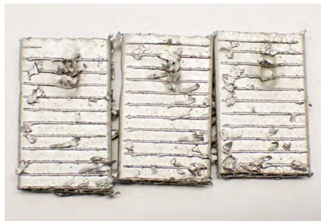
Fig. 1 Deformación de los tubos desde el exterior hacia el interior
