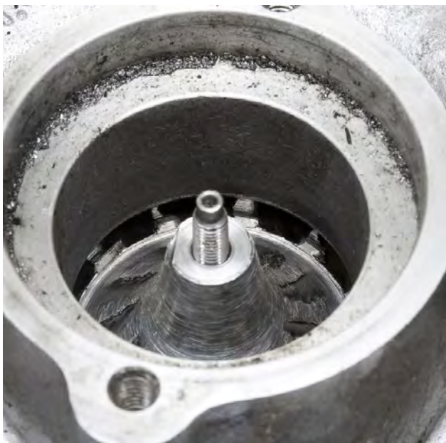
Fig. 2 Virutas por daños del turbocompresor
