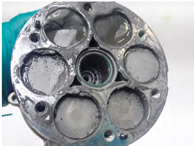
Fig. 1 Fuerte gripado en pistones y cilindros
