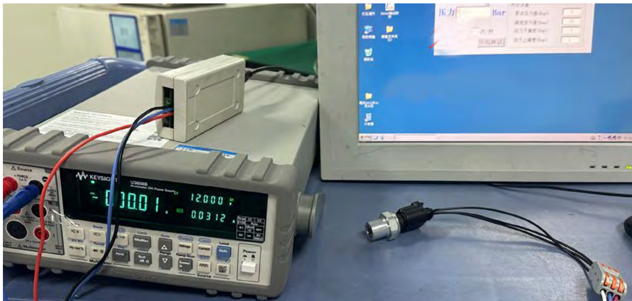
Fig. 4 Comprobación de un presostato en el laboratorio
