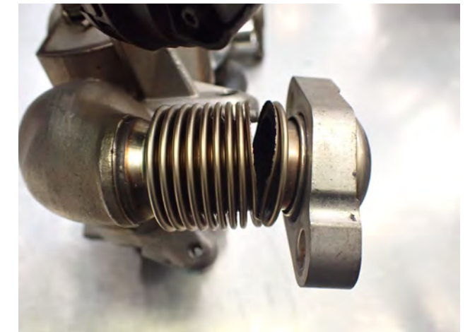
Fig. 2 Tubo flexible desgarrado del radiador EGR
