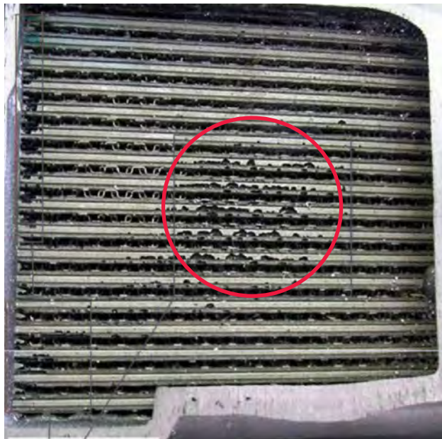
Fig. 1 Cavitación en las tuberías del radiador de aceite
