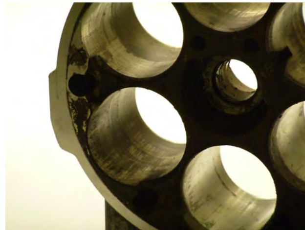
Fig. 2 Gripado en el cilindro
