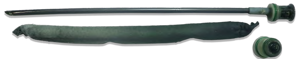
Fig. 3 Filtro deshidratador obstruido
