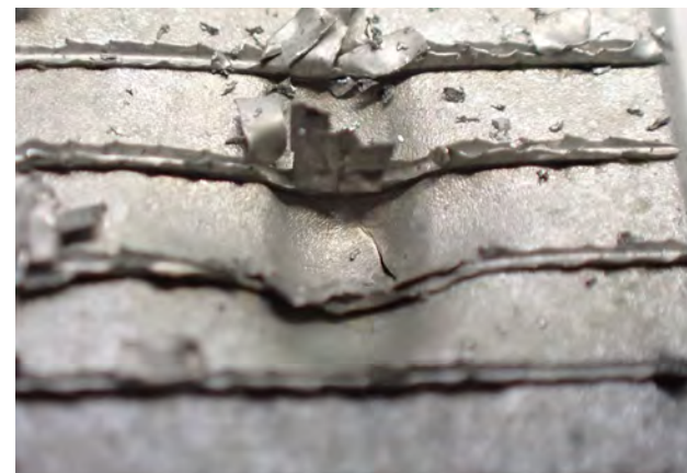
Fig. 2 Deformación y grietas
