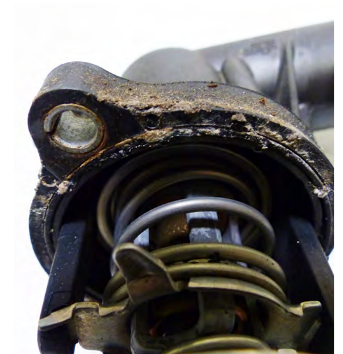
Fig. 2 Junta dañada por la junta líquida
