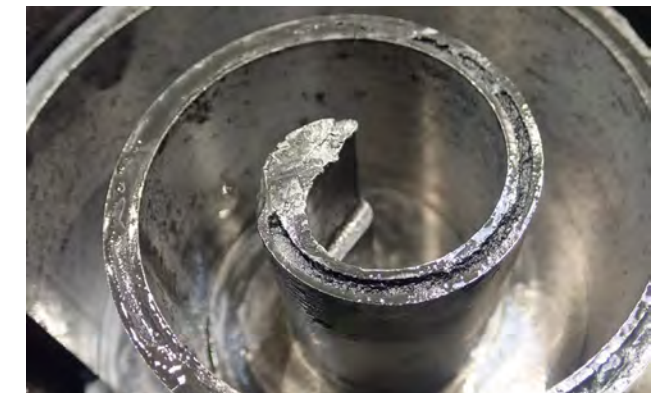
Abb. 2 Stirnseitige Dichtung an Spirale zerstört
