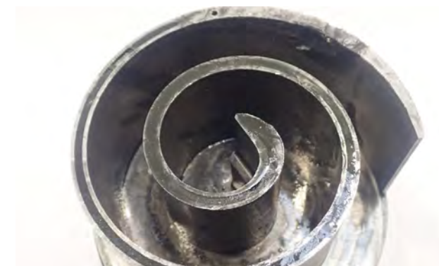
Abb. 1 Spirale vom Scroll-Kompressor stark abgenutzt
