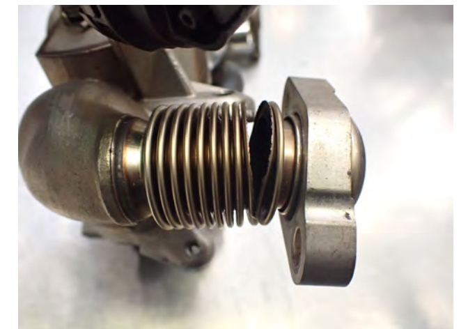
Abb. 2 Flexrohr von AGR-Kühler angerissen
