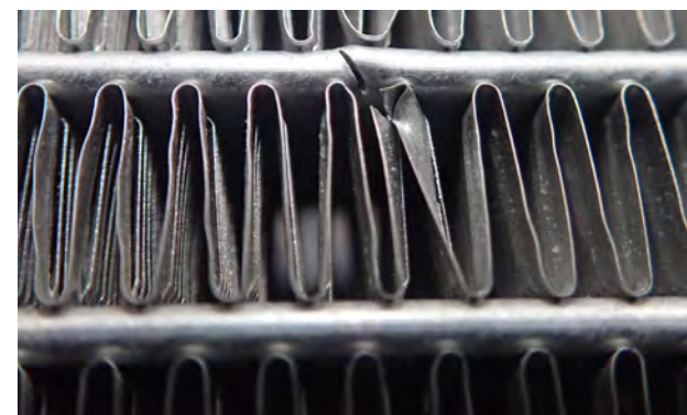
Abb. 3 Mechanische Beschädigung (Schnitt)
