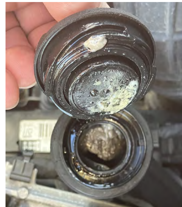
Abb. 2 Öl-Wasser-Emulsion am Öleinfülldeckel und Öleinfüllstutzen
