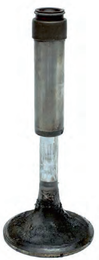
Resim 1a Kılavuzun içinde sürtün supap sapı
