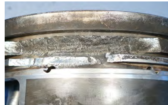
Resim 3 Segman ara seti kırılması
