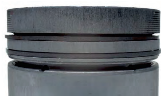
Resim 2 Özellikle birinci piston segmanında kuvvetli eksenel aşınma
