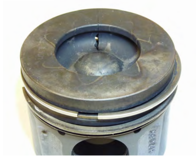
Resim 1 Yanma odası kenarında çatlaklar
