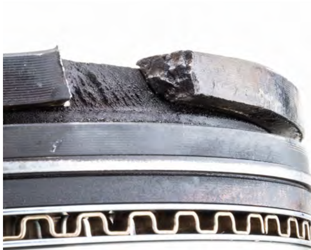
Resim 2 Zorlama sonucu kırılma FS
