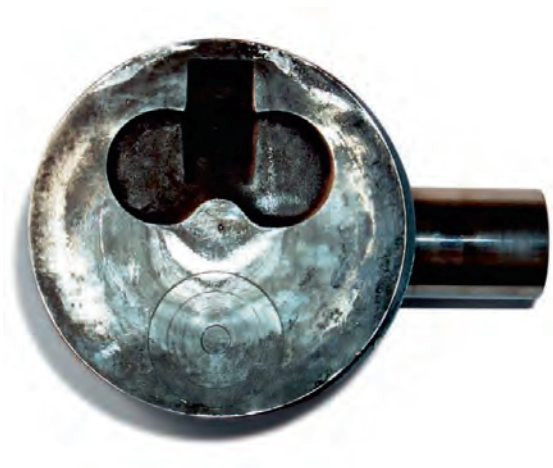
Resim 1 Supap çarpan piston kafası
