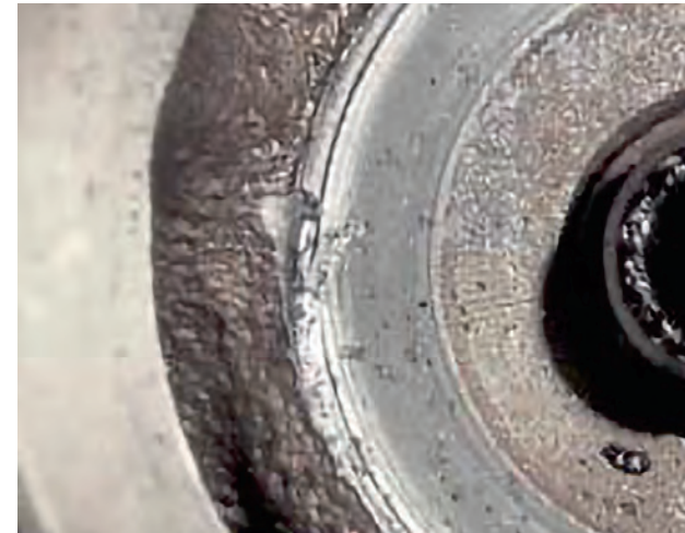
Resim 5 Silindir kafasında eğik yerleştirilmiş supap yayından kaynaklanan izler
