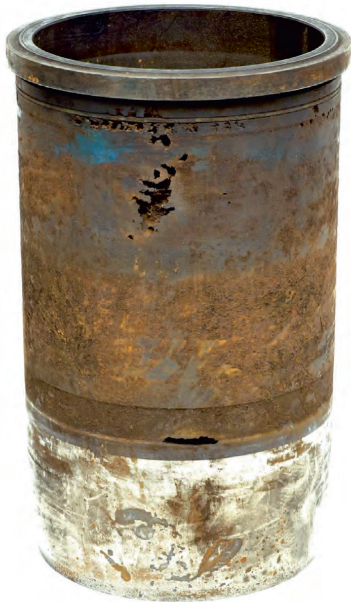
Resim 1a Kavitasyon hasarlı silindir gömleği
