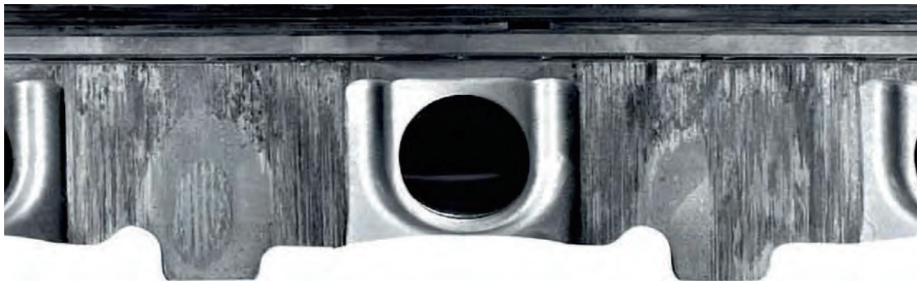
Resim 2 Piston eteğinde boşluk yetersizliği nedeniyle sürtünme hasarı
