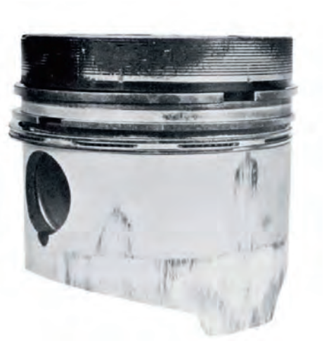
Resim 1 Silindir gömleğinin daralması nedeniyle piston eteğinin alt kısmında sürtünme hasarı
