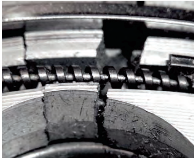
Resim 2b Zorlama sonucu kırılmanın yakından görünümü
