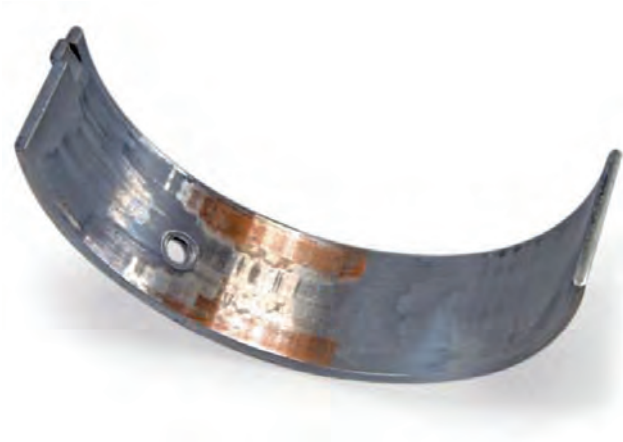
Resim 1 Yatak burçlarında düzensiz aşınma, yatak tabakası kısmen yıpranmış
