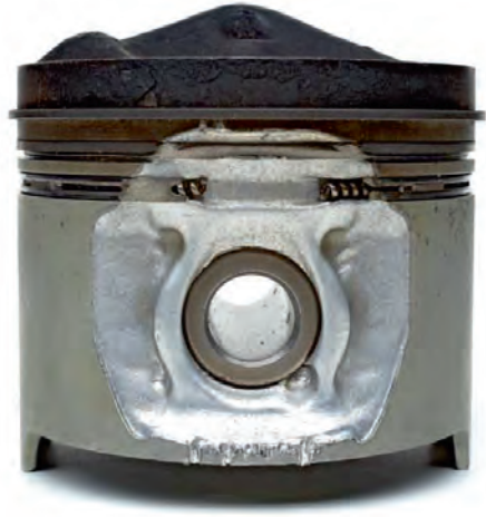
Resim 1a Gevşek bir piston pimi tespit segmanı veya piston pimi deliği içerisindeki yabancı cisimlerin neden olduğu çukurlaşmış piston yüzeyi
