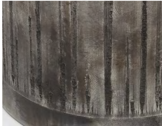
Resim 2a+b Silindir gömleğinin dışında sürtünme hasarı (tüm çevre boyunca)
