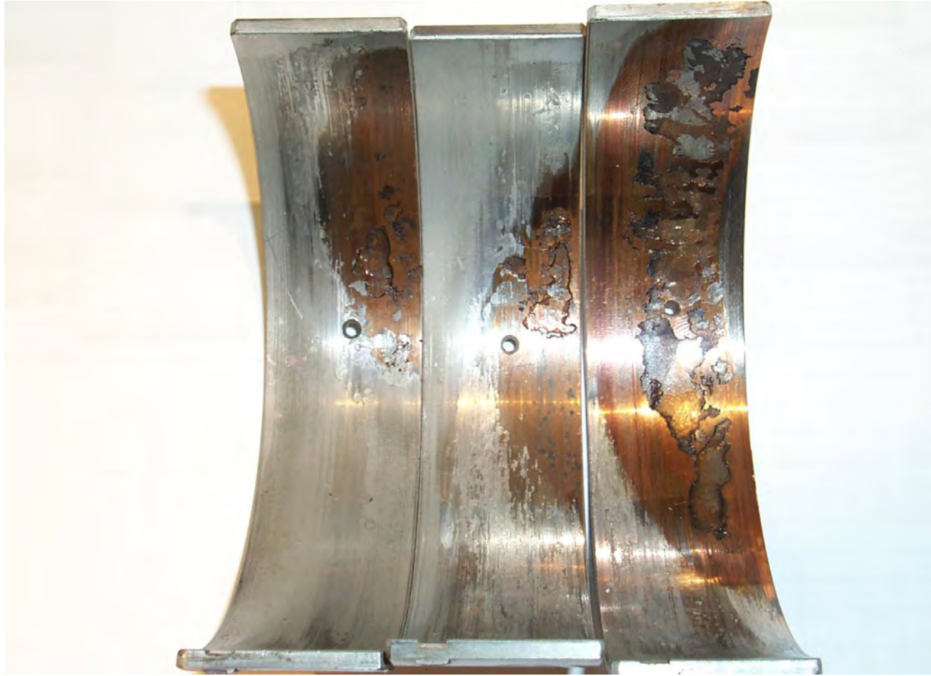
Resim 1 Mekanik olarak aşırı yüklenme veya yağ filminin çok düşük taşıma kapasitesi nedeniyle oluşan malzeme kopmaları
