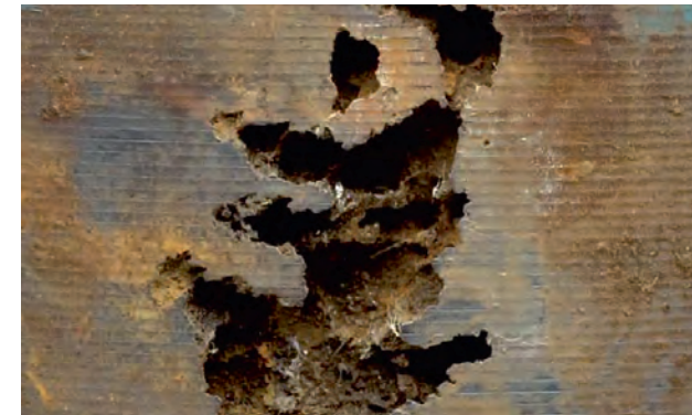
Resim 1b Keskin kenarlı ve içe doğru büyüyen oyukları olan silindir gömleğinin yakından görünümü
