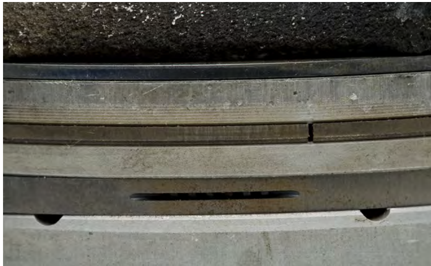
Resim 2 Piston segmanlarında çizik izleri ve yanmış bölgeler
