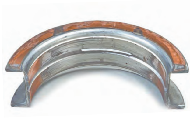
Resim 1a Kaymalı yatağın birleşim yerine yakın çalışma yüzeyinde aşınma
