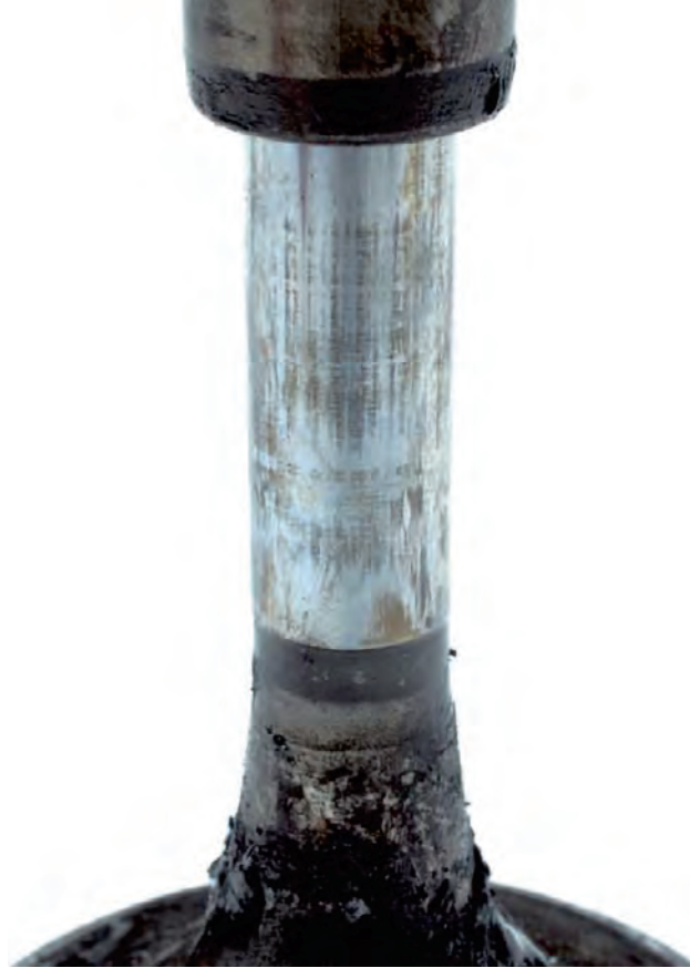
Resim 1b Supap sapında sürtünme hasarı ve çizik izleri
