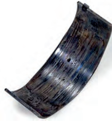
Resim 2 Çok aşınmış ve yüzeyi atılmış kaymalı yatak
