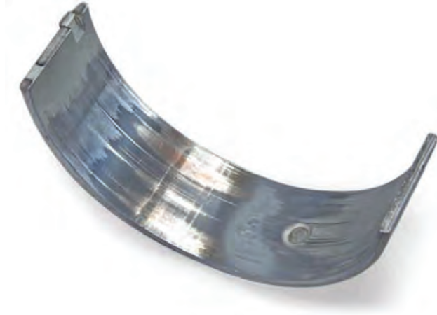
Resim 2 Yatak burçlarında düzensiz aşınma
