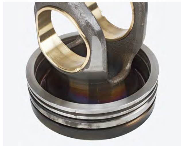
Resim 3 FERROTHERM® pistonda aşırı ısınma nedeniyle oluşan renk değişimleri
