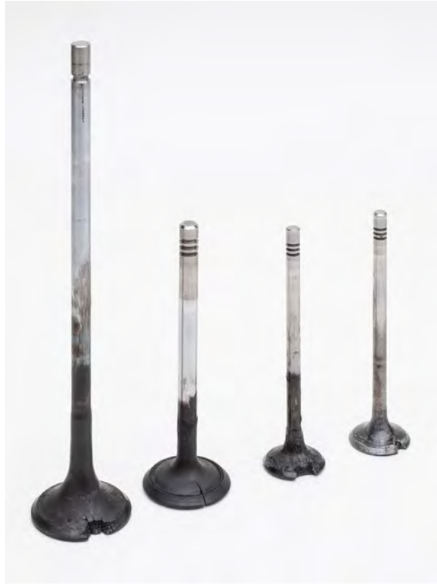
Resim 2 Çeşitli noktalarda çatlaklar ve erimeler
