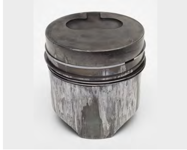
Resim 1 Piston eteğinde sürtünme hasarı
