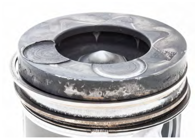
Resim 2 Piston kafası üzerinde supap darbeleri
