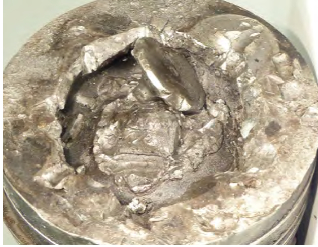
Resim 1 Supap kafası kırılmış ve pistonun içine gömülmüş
