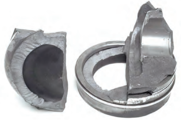
Resim 1 Sıvı darbe etkisi nedeniyle parçalanmış ticari araç pistonu
