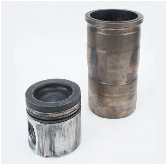
Resim 1 FERROTHERM® pistonda sürtünme hasarı, silindir gömleğinde termik renk değişiklikleri
