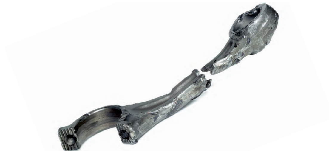
Resim 3 Sıvı darbe etkisi nedeniyle eğrilmiş ve kırılmış biyel kolu
