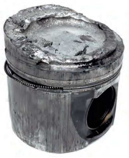
Resim 1 Dizel motoru pistonunda erimiş piston kafası kenarı
