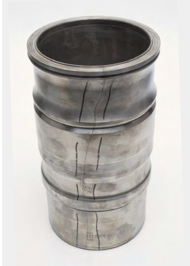
Resim 1 Silindir gömleğinde uzunlamasına çatlak
