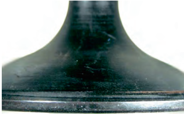
Resim 1 Deforme olmuş supap kafası (lale şekli)
