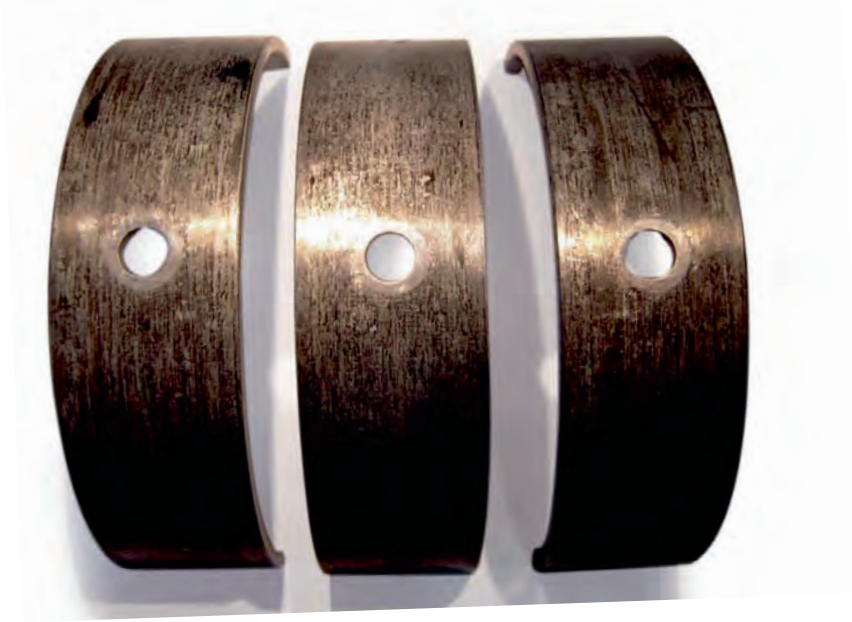
Resim 1 Kaymalı yatakların dış yüzünde parlak yerler
