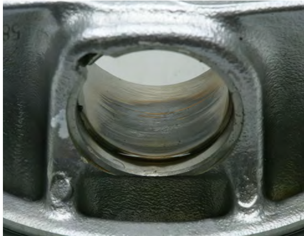
Resim 3 Sürtünme izleri olan pim deliği
