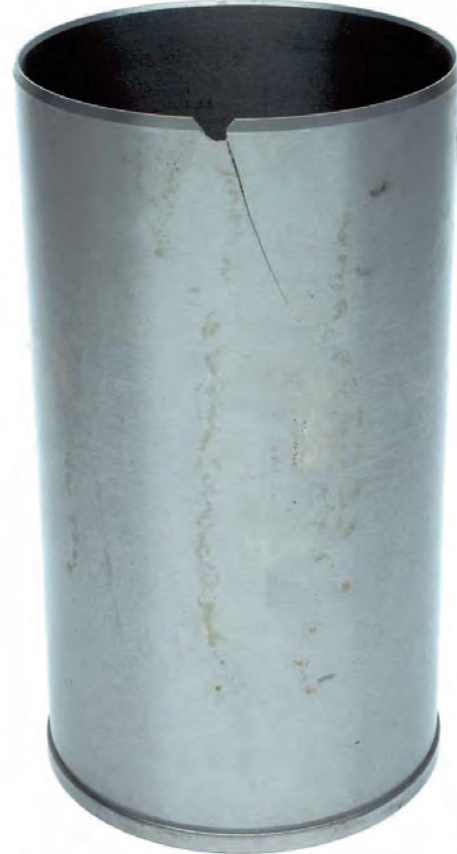
Resim 2 Silindir gömleğinin alt ucunda uzunlamasına çatlak
