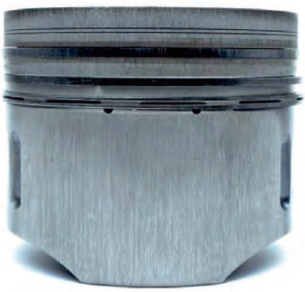
Resim 1 Pistonda kirlilik nedeniyle aşınma – uzunlamasına doğrultuda derin çizik izleri
