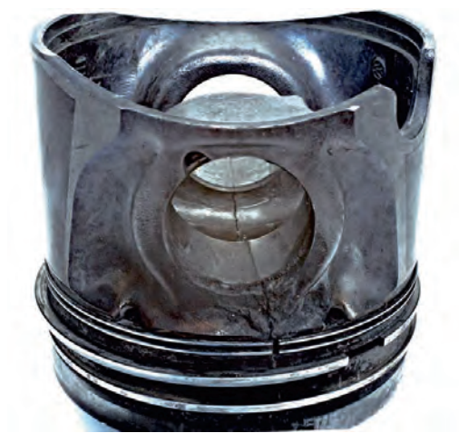
Resim 2 Pim deliğinin içine kadar kırılmış piston
