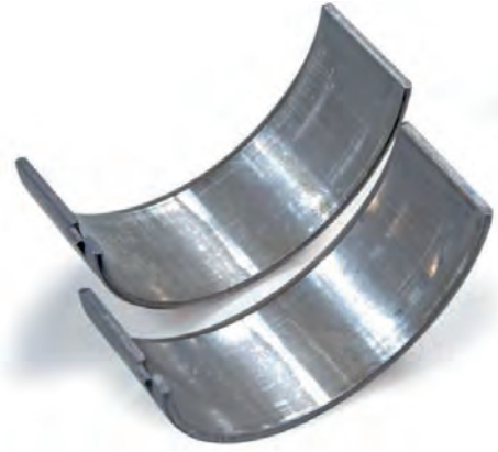
Resim 1 Yatak burçlarının çalışma yüzeylerinde parlak bölgeler
