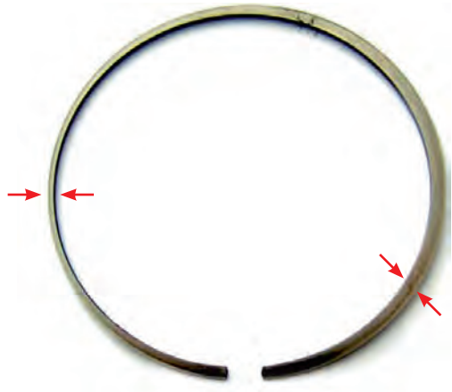
Resim 1 Aşın radyal aşınması olan piston segmanı
