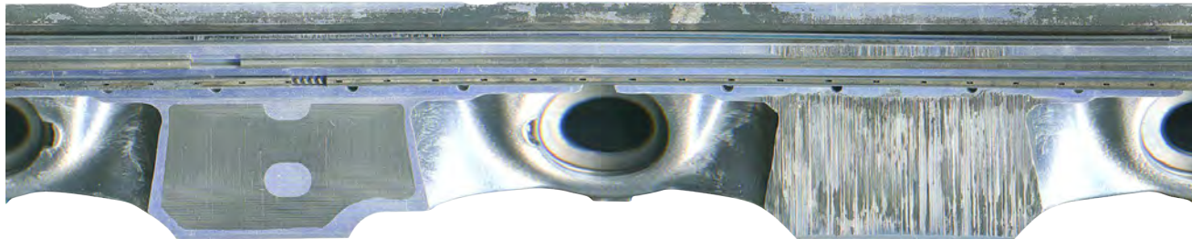
Resim 2 Tek taraflı sürtünme hasarı görünümü
