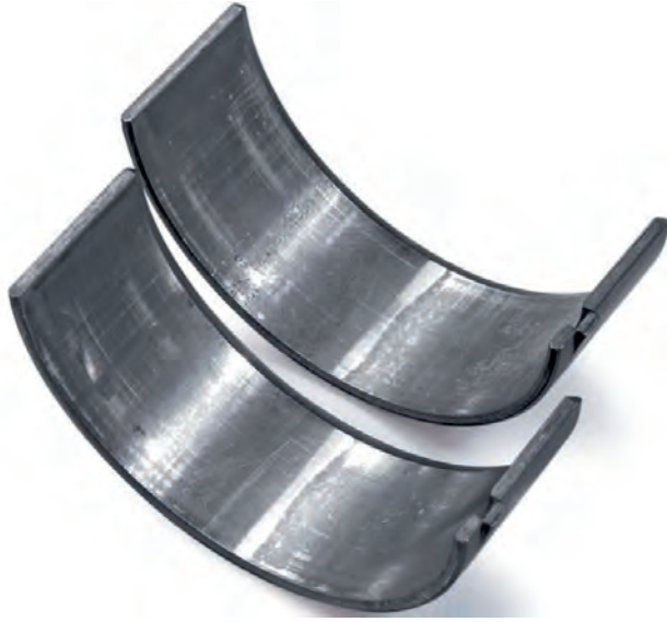
Resim 1 Aşınmış kaymalı yatak dış kenarları
