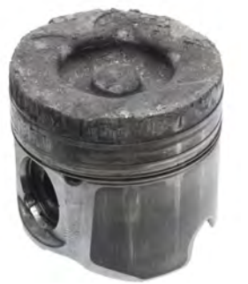
Resim 4 Dizel motoru pistonundaki erimiş ateşleme seti
