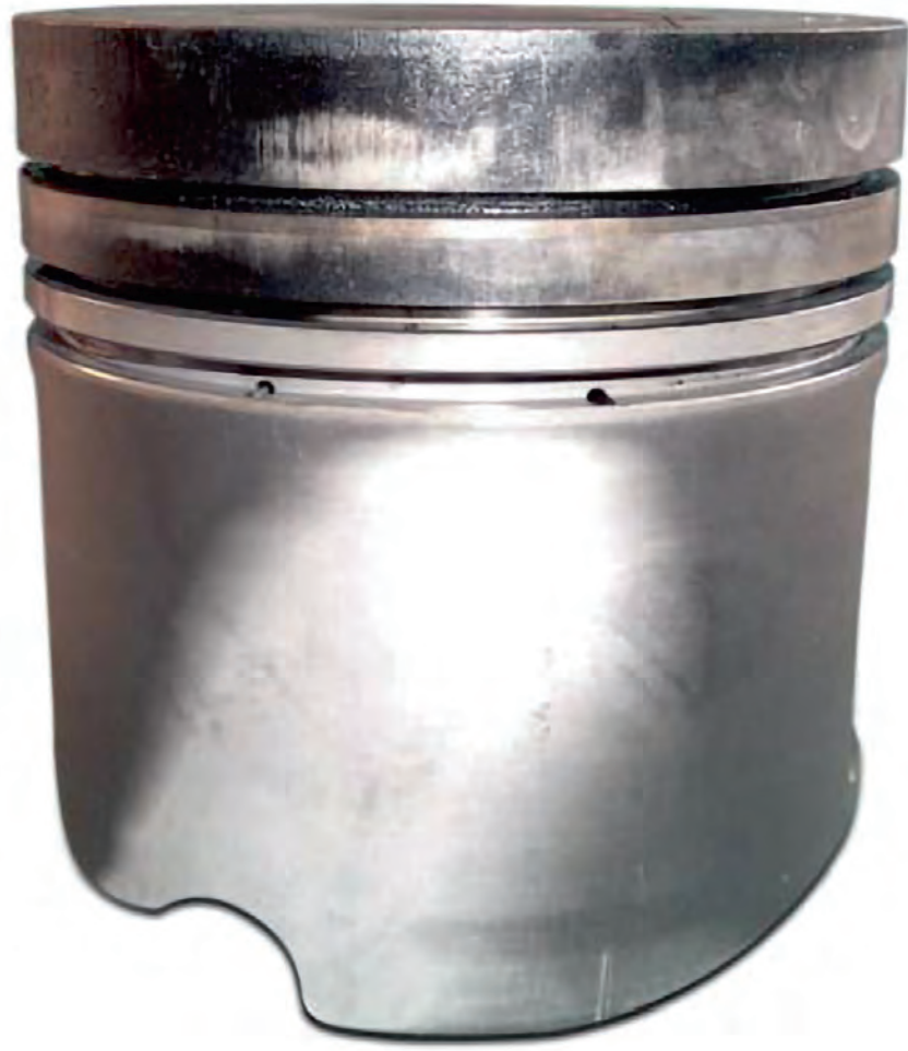
Resim 1 Piston eteğinde asimetrik temas yüzeyi görüntüsü (eğri çalışma)
