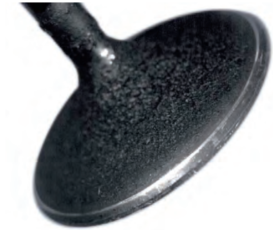
Resim 3 Deforme olmuş supap kafasında çizgi şeklinde temas izleri
