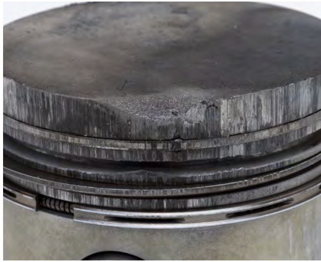
Resim 1 Benzinli motor pistonundaki erozyon izleri
