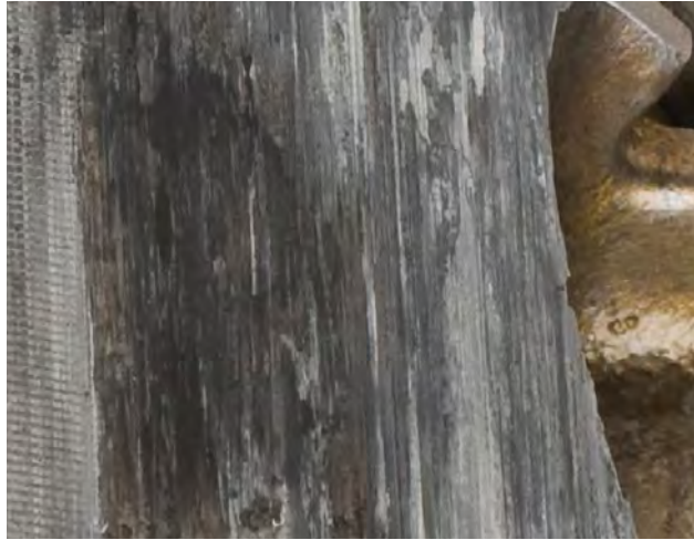
Resim 1 Pim deliğinin yanında diyagonal yönde sürtünme izleri
