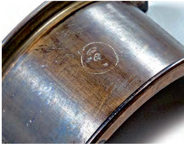
Resim 2 Kaymalı yatağın dış yüzünde yabancı cisim ezme izi
