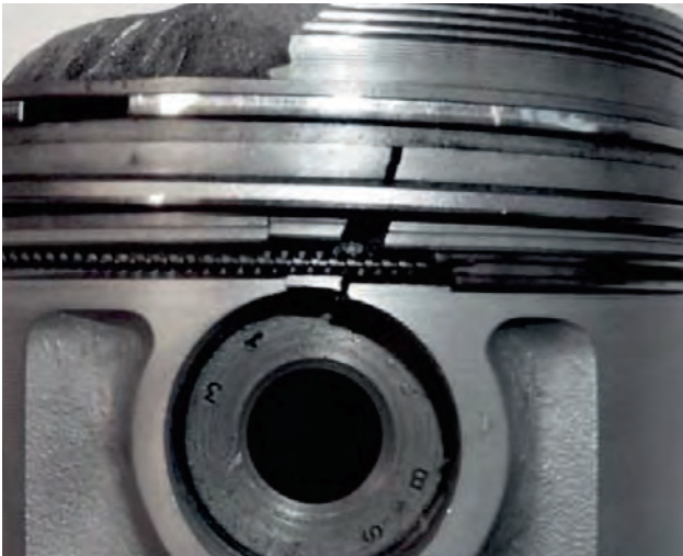
Resim 2a Piston kafasından pim deliğine kadar zorlama sonucu kırılma
