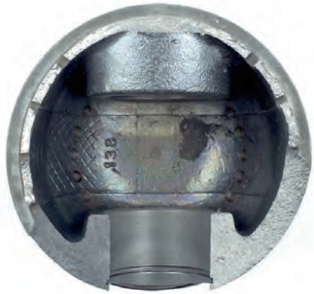
Resim 3 Piston pimi eksen seviyesinde enine kırılmış piston
