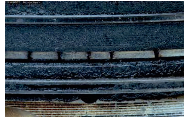
Resim 2b Piston segmanı kırılmasının yakından görünümü
