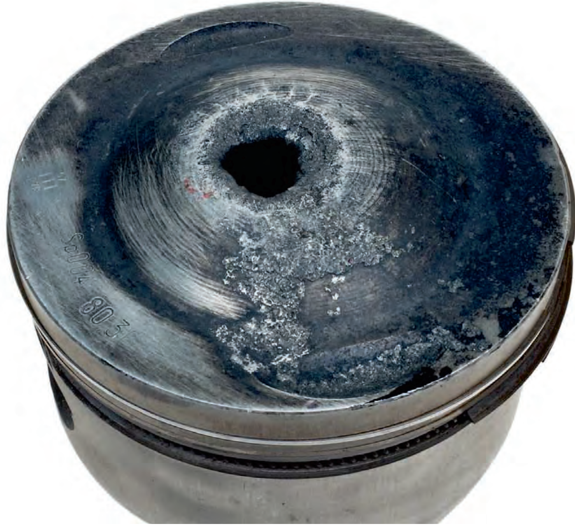
Resim 1 Yanlış ısı değerine sahip bujilerin kullanılması nedeniyle piston kafasında delik oluşmuş
