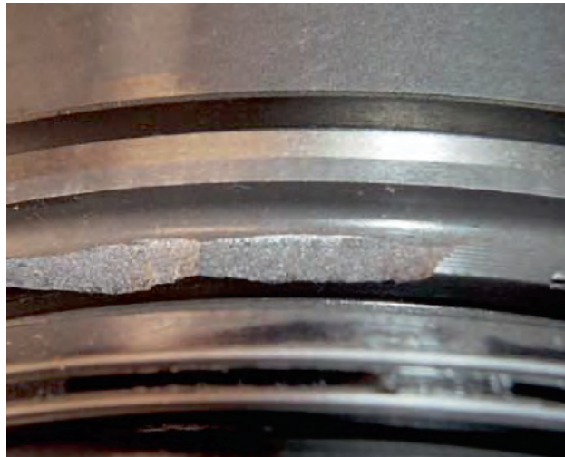
Resim 3 Aşağıdan yukarıya doğru kırılma ilerlemesi
