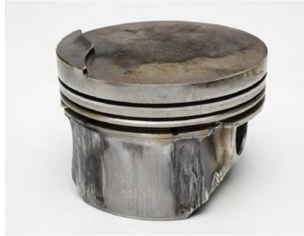
Resim 2 Pim deliğinin yanında, yanal yönde piston sürtünme hasarı
