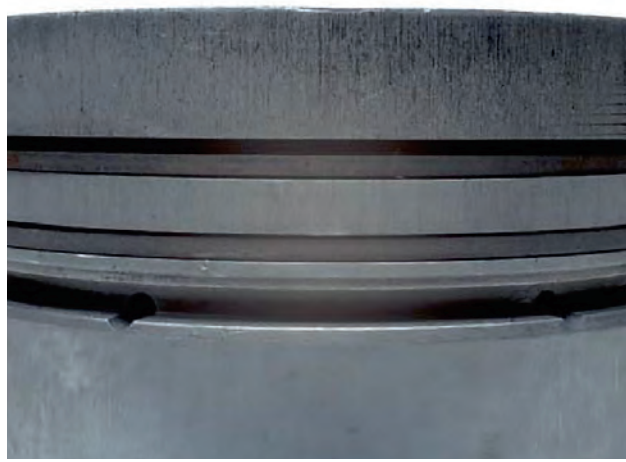
Resim 2 Piston segmanlarının aksel olarak aşınması
