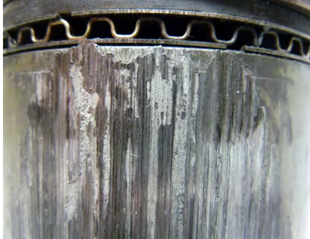
Resim 2 Çizik izleri ve yanmış bölgeleri olan piston segmanları
