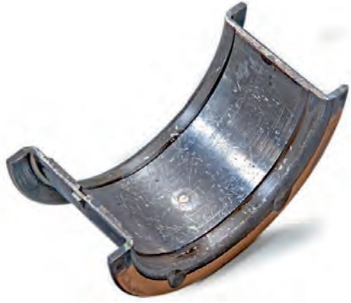
Resim 1 Kaymalı yatak ortasında aşınma izleri
