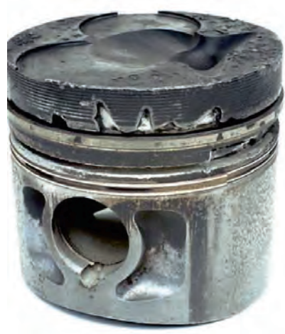
Resim 1 Segman taşıyıcının bazı kırık parçaları nedeniyle hasar görmüş piston kafası
