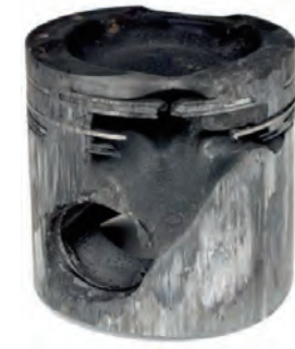
Resim 3 Yanmış dizel motoru pistonu
