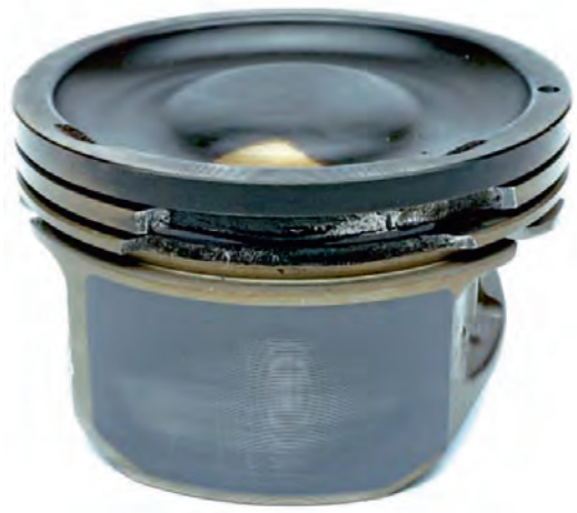
Resim 1 Yanma prosesindeki arıza nedeniyle kırılmış segman ara setleri
