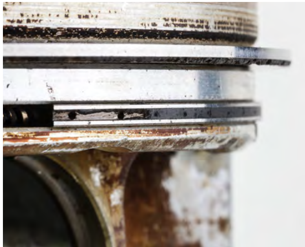
Resim 2 Yağ segmanı tıkanmış
