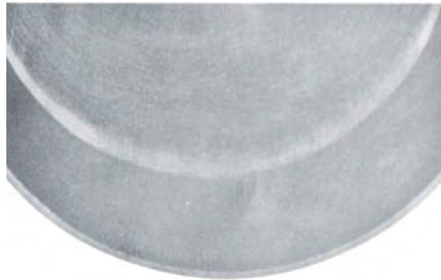
Resim 2 Silindir deliğinde parlak, çepeçevre çizgi
