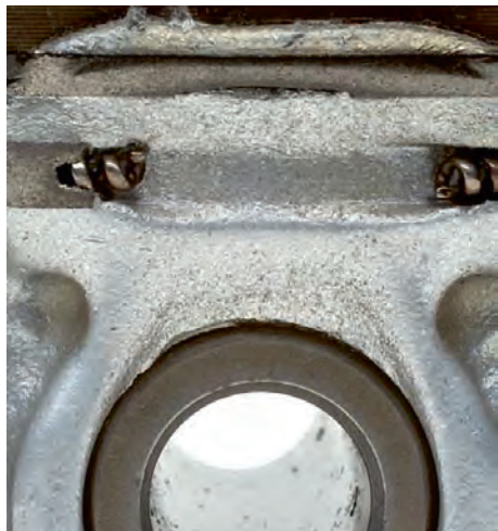
Resim 1b Yumuşak piston malzemesi ve daha sert segman malzemesinin eşit ölçüde aşınmış yüzeylerinin yakından görünümü
