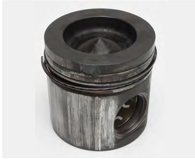
Resim 2 Ateşleme setinde erime ve etek kısmında sürtünme hasarı
