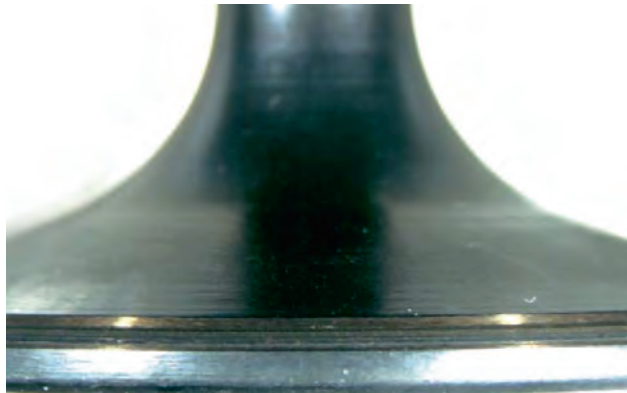
Resim 2 Karşılaştırma için: Deformasyonlar olmayan supap kafası
