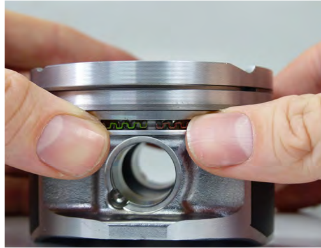
Resim 1 Doğru yerleştirilmiş segman yayı (her iki renk kodlaması da görünüyor)
