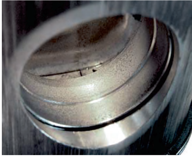
Resim 1 İncelmiş motor yağı nedeniyle pim deliğinde çukurlaşmalar
