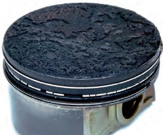
Resim 2a Vuruntulu yanmadan kaynaklanan segman kırılması
