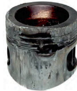
Resim 2 Benzinli motor pistonundaki erimiş ateşleme seti
