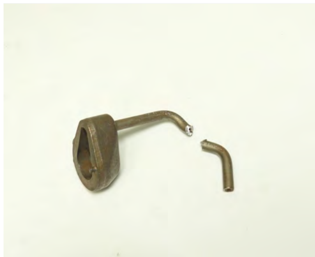
Resim 4 Kırılmış soğutma yağı fiskeyesi
