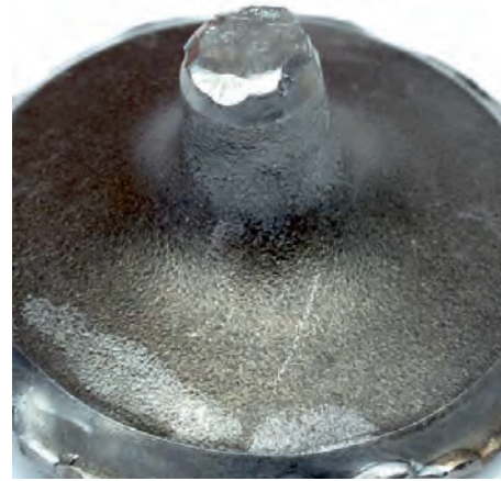
Resim 2b Supap sapında titreşim nedenli kırılma yüzeyi
