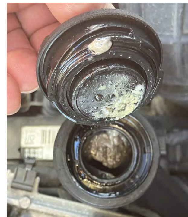
Rys. 2 Emulsja olejowo-wodna na korku wlewu oleju i króćcu wlewu oleju
