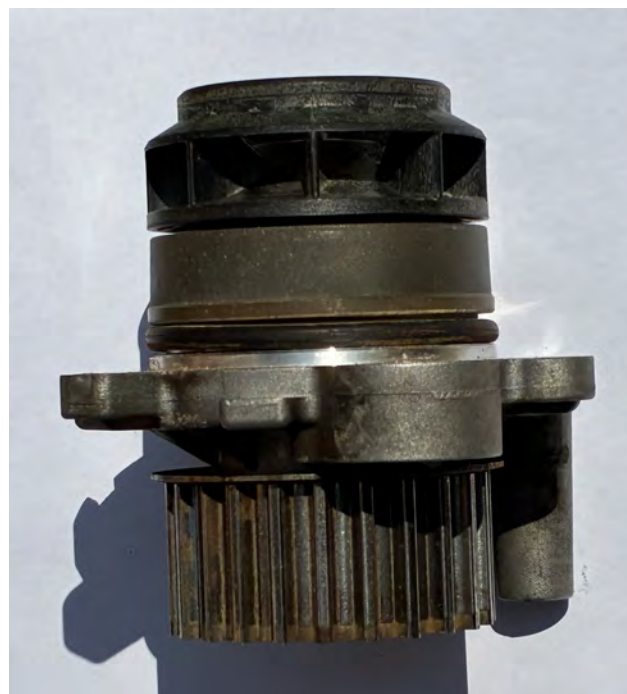
Rys. 1 Wirnik z tworzywa sztucznego oddzielony od wału
