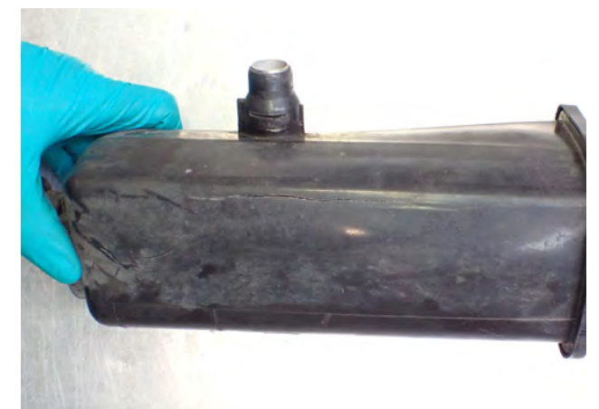
Rys. 2 Pęknięty zbiornik wyrównawczy
