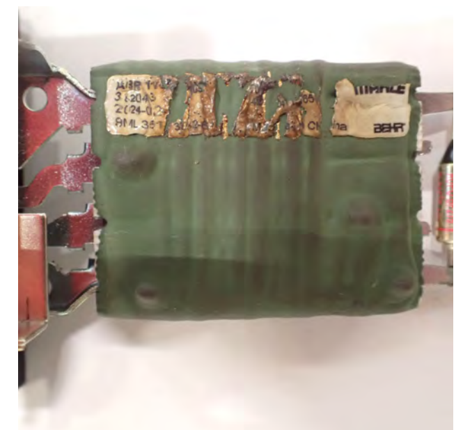
Rys. 2 Przeciążenie termiczne regulatora dmuchawy
