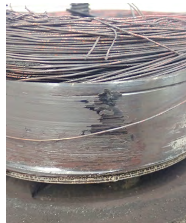
Rys. 1 Ślady tarcia na obudowie cewki i spalona cewka
