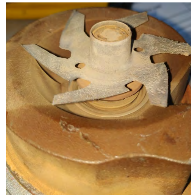
Rys. 1 Kawitacja na pompie chłodziwa
