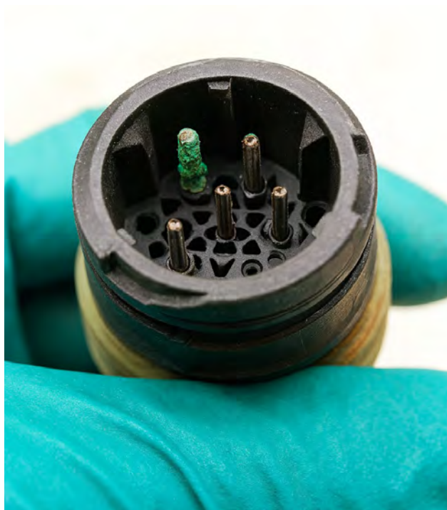
Rys. 1 Korozja na wtyczce
