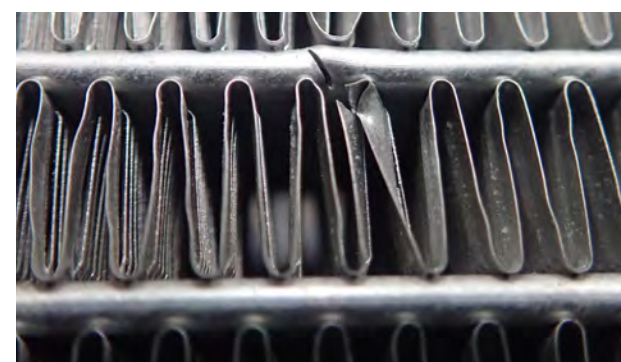
Rys. 3 Uszkodzenie mechaniczne (przekrój)
