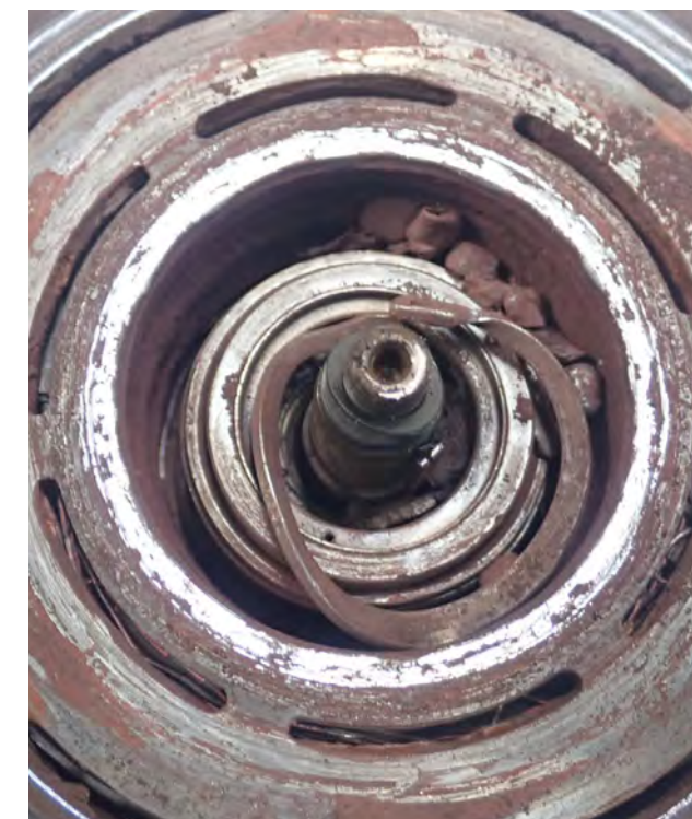
Rys. 2 Uszkodzone łożysko kulkowe
