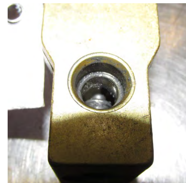
Rys. 2 Zanieczyszczenie w zaworze rozprężnym
