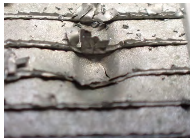
Rys. 2 Deformacja i pęknięcie
