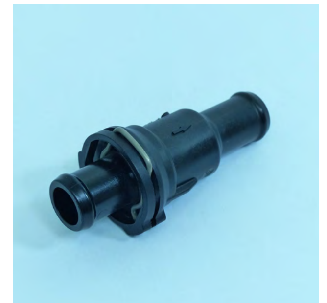
Rys. 2 Termostat wymiennika ciepła oleju przekładniowego
