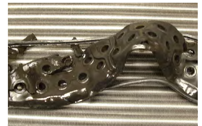
Rys. 1 Spęczniała uszczelka chłodnicy chłodziwa
