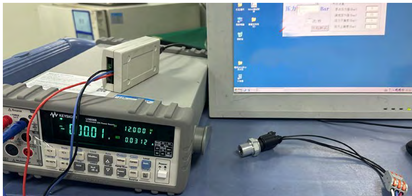
Rys. 4 Kontrola presostatu w laboratorium
