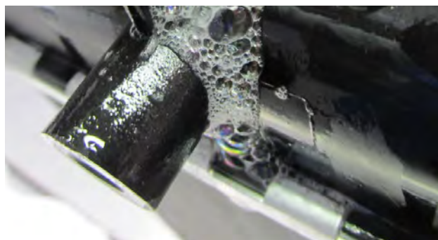
Rys. 2 Pęknięcia na mocowaniu
