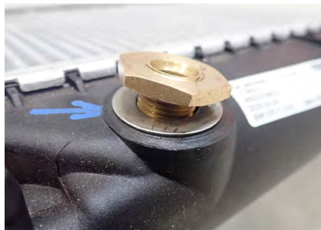
Rys. 3 Połączenie śrubowe przewodu oleju przekładniowego
