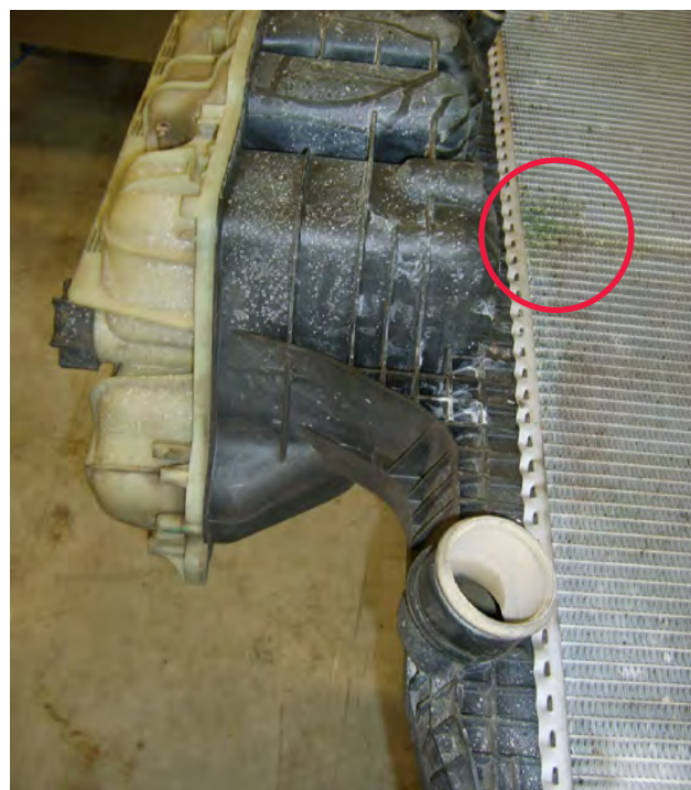
Rys. 1 Rzekomo nieszczelna chłodnica
