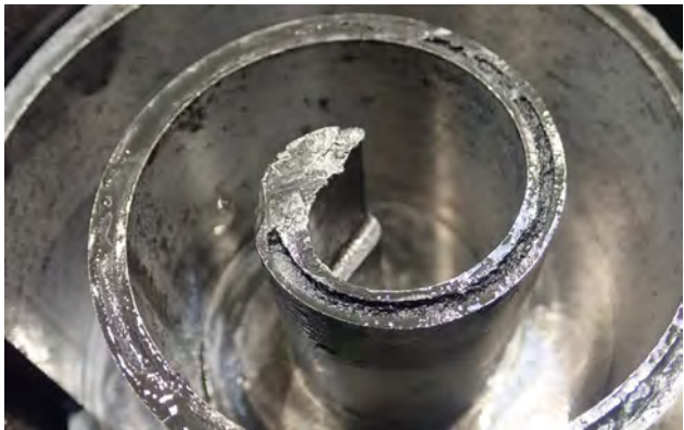
Rys. 2 Uszczelka czołowa spirali zniszczona
