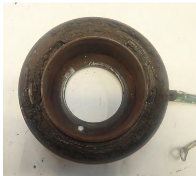
Rys. 1 Cewka elektromagnetyczna przypalona wskutek ślizgającego się sprzęgła
