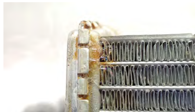
Rys. 4 Zardzewiały wymiennik ciepła
