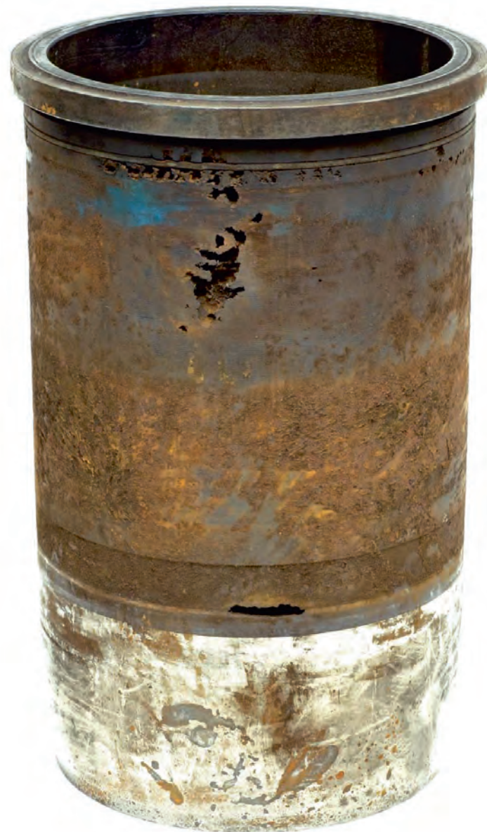
Rys. 1a Tuleja cylindrowa z uszkodzeniem kawitacyjnym
