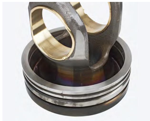
Rys. 3 Przebarwienia spowodowane przegrzaniem na tłoku FERROTHERM®
