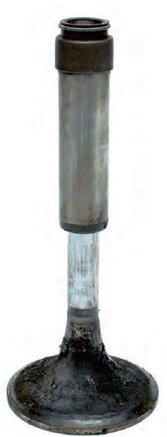
Rys. 1a Trzonek zaworu z zatarciami w prowadnicy
