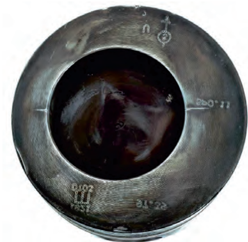
Rys. 3a Pęknięcia na brzegu komory spalania
