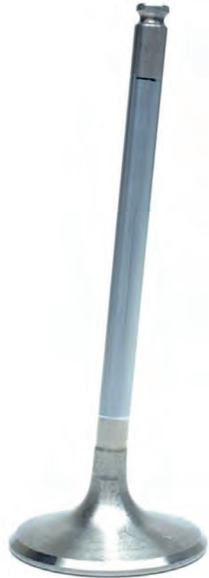
Rys. 1 Skrzywiony trzonek zaworu
