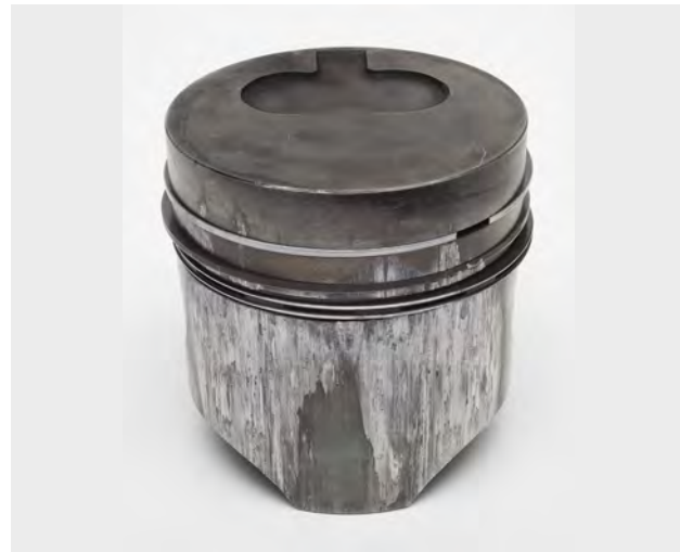
Rys. 1 Zatarcia na płaszczu tłoka
