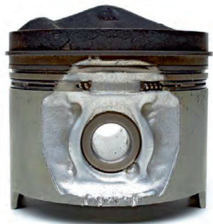
Rys. 1a Zwęglenie ścianki tłoka spowodowane przez luźne zabezpieczenie sworznia tłoka albo przez ciało obce w otworze sworznia tłokowego
