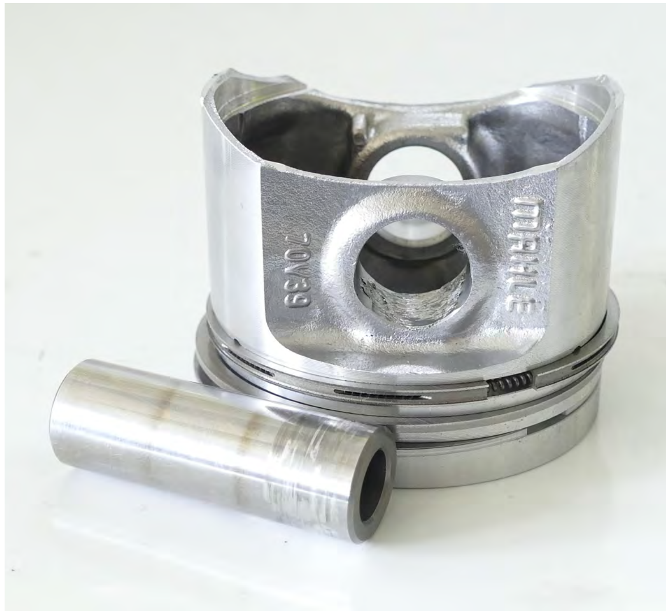
Rys. 1 Zatarcia w otworze piasty
