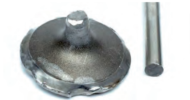
Rys. 2a Złamany talerzyk zaworu
