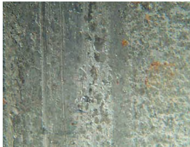
Rys. 1b Wyraźnie widoczny w zbliżeniu: uszkodzony materiał łożyska
