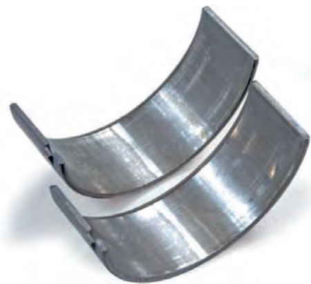
Rys. 1 Błyszczące miejsca na powierzchniach bieżnych panewek
