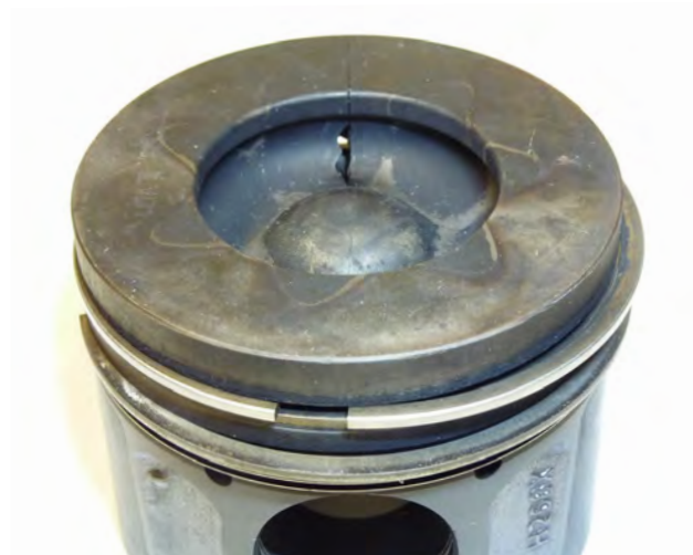
Rys. 1 Pęknięcia na brzegu komory spalania
