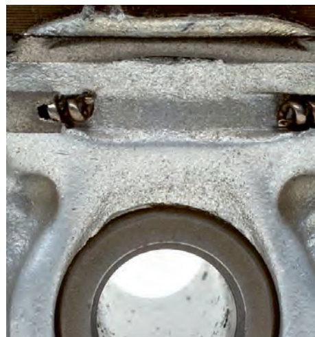
Rys. 1b Zbliżenie na powierzchnię bardziej miękkiego materiału tłoka i twardszego materiału pierścienia tłokowego, startych w tym samym stopniu
