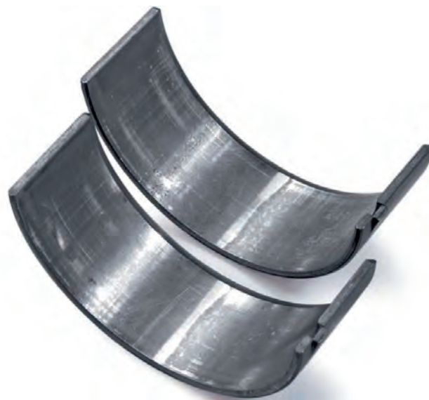
Rys. 1 Zużyte krawędzie zewnętrzne łożyska ślizgowego
