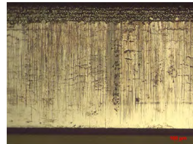
Rys. 3 Pierścień tłokowy ze śladami zatarcia w kierunku skoku
