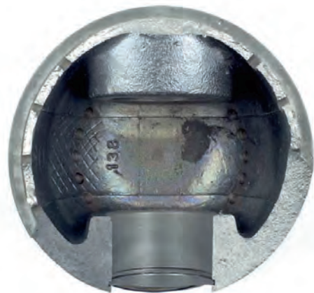
Rys. 3 Tłok pęknięty w poprzek na wysokości osi sworznia tłoka
