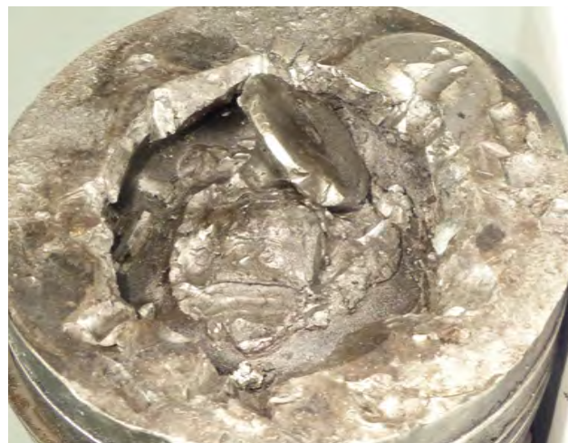
Rys. 1 Talerzyk zaworu odłamał się i wbił w tłok
