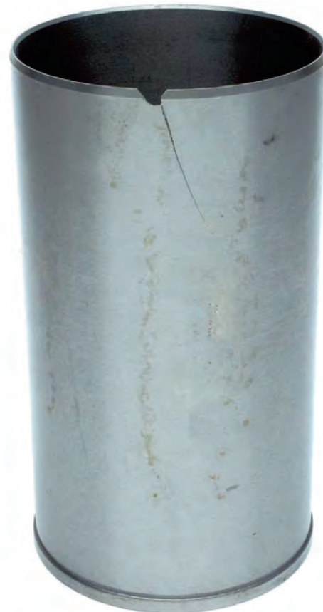
Rys. 2 Dolny koniec tulei cylindrowej z pęknięciem wzdłużnym
