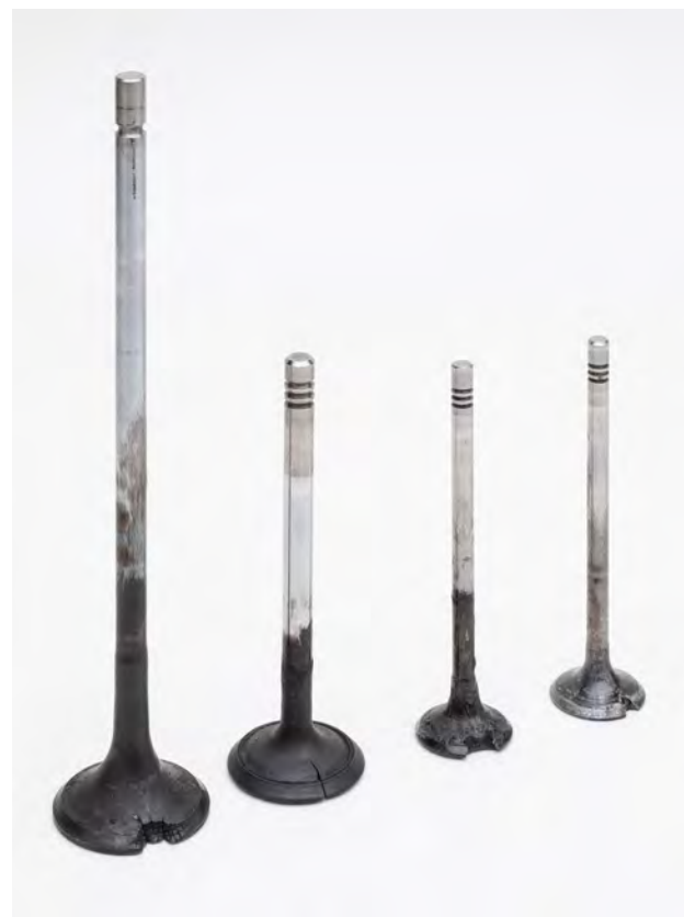
Rys. 2 Pęknięcia i topnienie na różnych etapach
