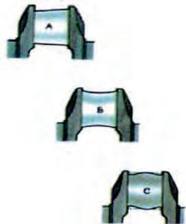
Rys. 4 Deformacje czopów korbowych
