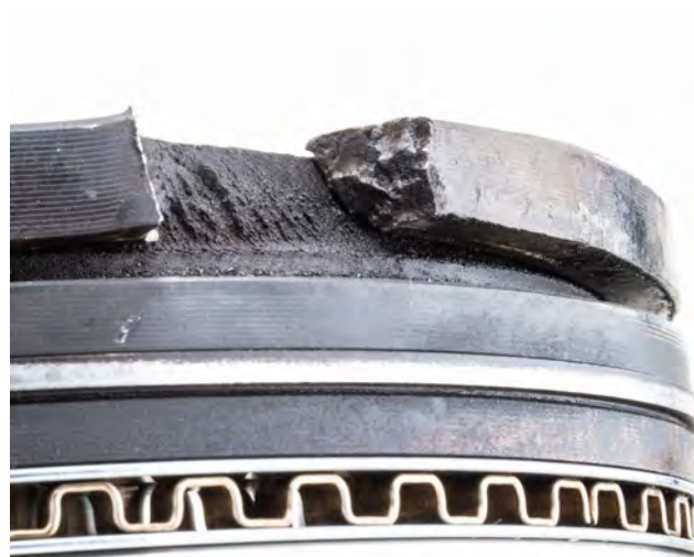
Rys. 2 Przełom statyczny wywołany oddziaływaniem siły
