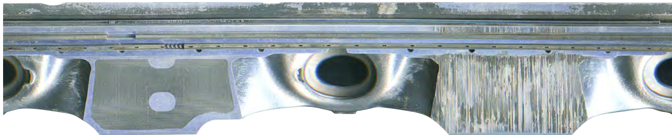
Rys. 2 Jednostronna panorama śladów zatarcia
