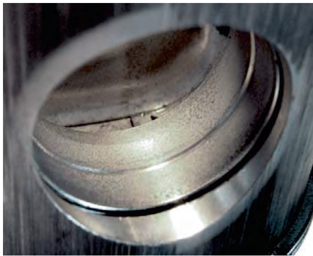
Rys. 1 Wżery w otworze piasty spowodowane rozcieńczonym olejem silnikowym
