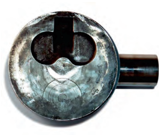
Rys. 1 Denko tłoka ze śladem uderzeń zaworu
