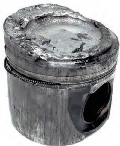
Rys. 1 Stopiona korona tłoka w silniku wysokoprężnym
