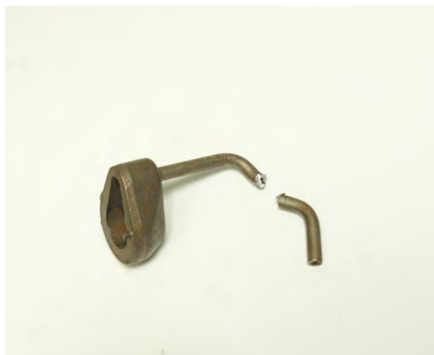
Rys. 4 Złamana dysza oleju chłodzącego
