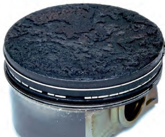
Rys. 2a Uszkodzenie pierścienia tłokowego spowodowane spalaniem stukowym
