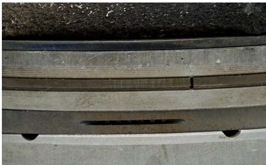
Rys. 2 Rowki i nadpalenia na pierścieniach tłokowych
