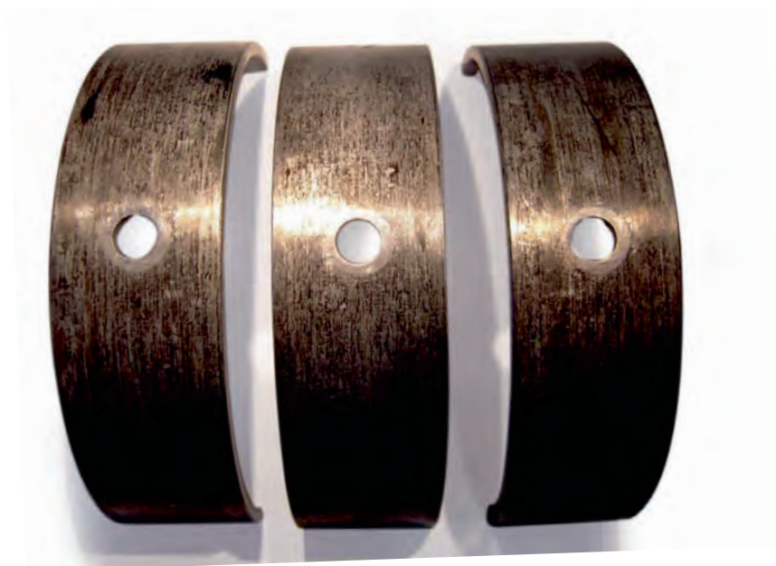
Rys. 1 Wypolerowane miejsca po stronie zewnętrznej łożysk ślizgowych
