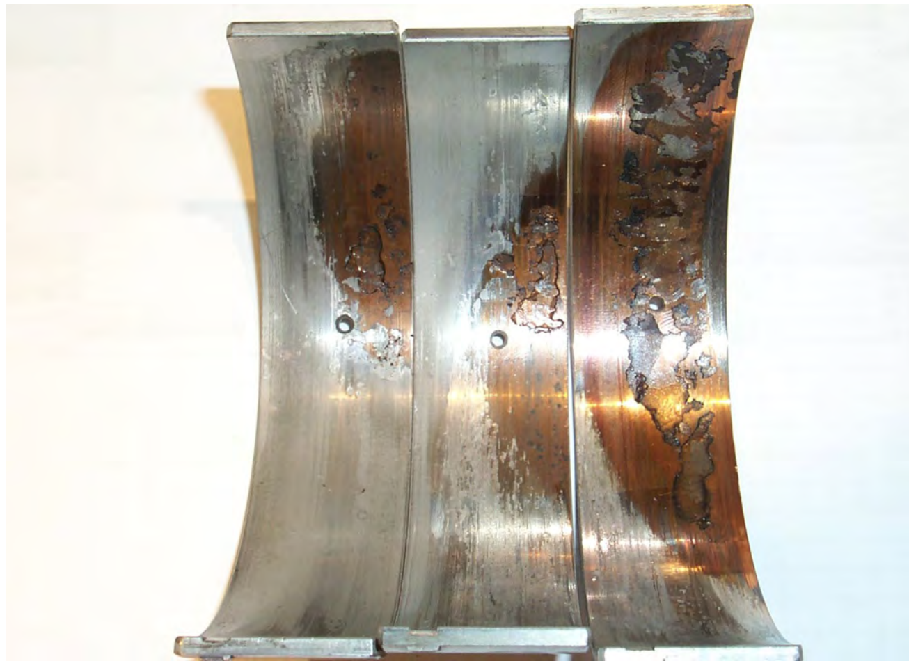
Rys. 1 Wylamania materiału wywołane mechanicznym obciążeniem albo niską zdolnością nośną filmu olejowego
