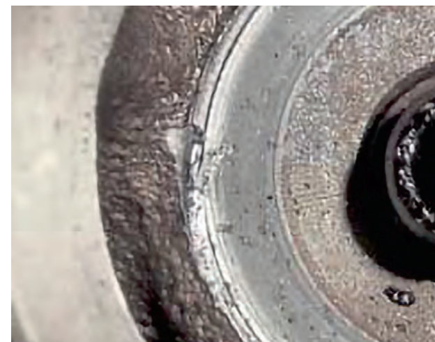
Rys. 5 Ślady na głowicy cylindrów, spowodowane przez ukośnie nałożoną sprężynę
