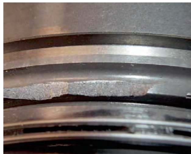
Rys. 3 Przebieg złamania od dołu do góry
