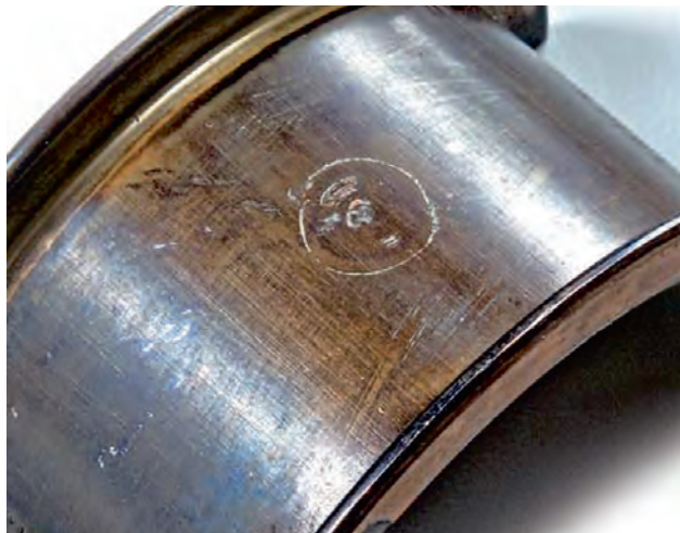
Rys. 2 Odcisk ciała obcego po zewnętrznej stronie łożyska ślizgowego
