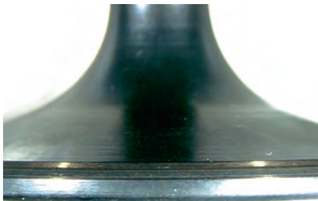
Rys. 2 Dla porównania: talerzyk zaworu bez odkształceń
