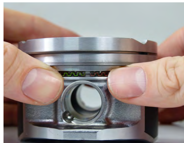
Rys. 1 Prawidłowo włożona sprężyna rozprężna (widoczne oba oznaczenia kolorystyczne)
