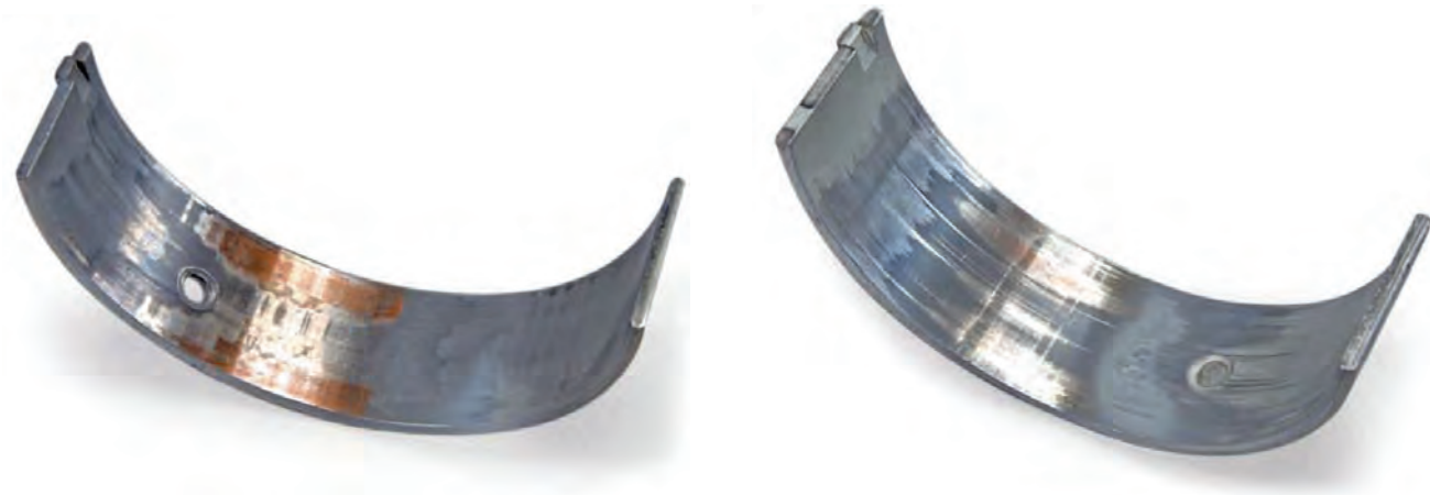
Rys. 1 Nierównomierne zużycie panewek łożyska, warstwa bieżna częściowo starta
