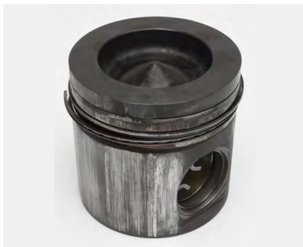
Rys. 2 Stopienie na progu ogniowym i zatarcia na trzonie
