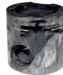
Rys. 3 Przepalony tłok w silniku wysokoprężnym
