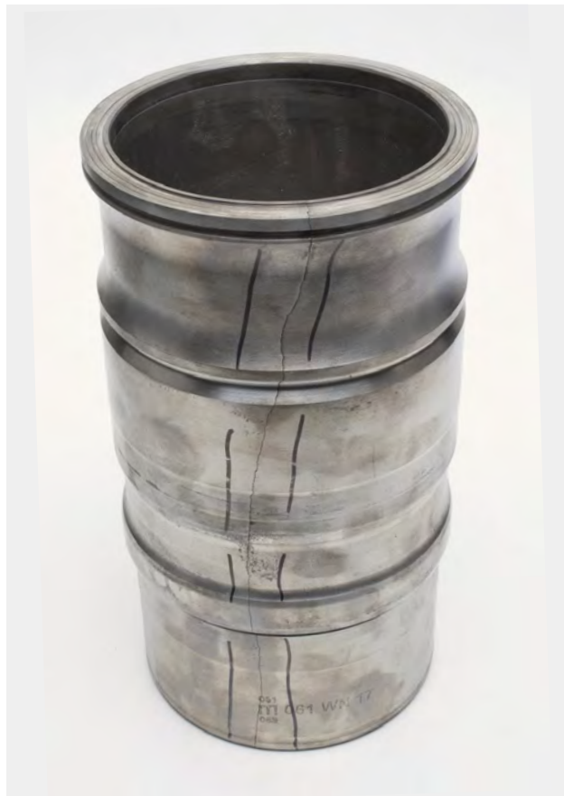
Rys. 1 Pęknięcie wzdłużne tulei cylindrowej
