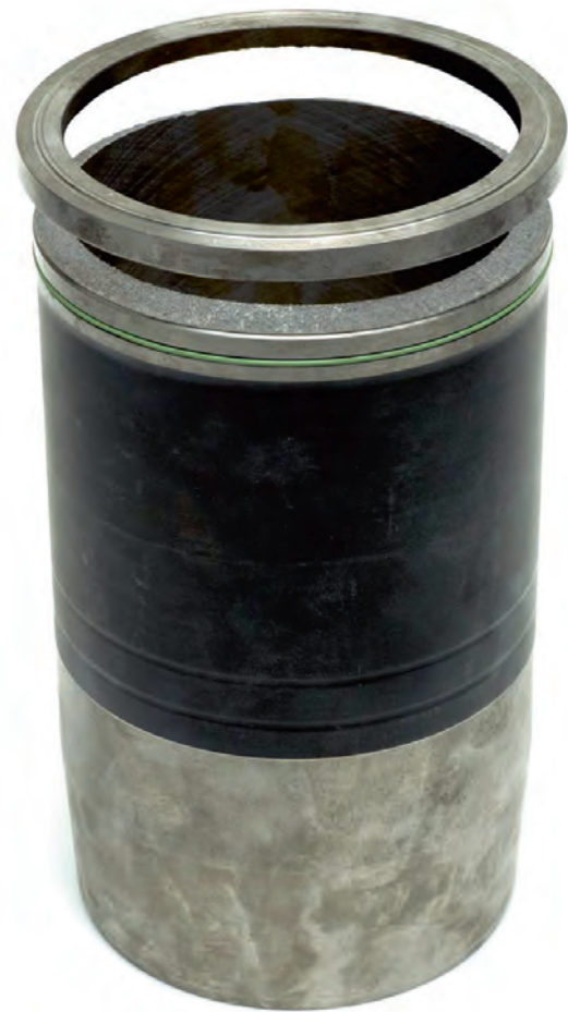
Rys. 1 Ułamany kołnierz tulei cylindrowej
