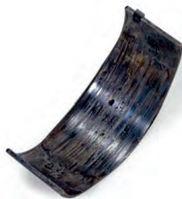
Rys. 2 Mocno zużyte i zdeformowane łożysko ślizgowe
