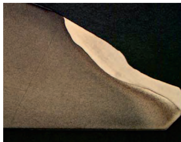
Rys. 3 Skrajnie zużyta powierzchnia uszczelniająca (pancerz stelitowy)
