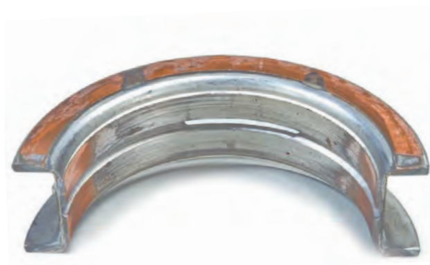
Rys. 1a Zużycie powierzchni bieżnej w pobliżu fugi rozdzielającej łożyska ślizgowego
