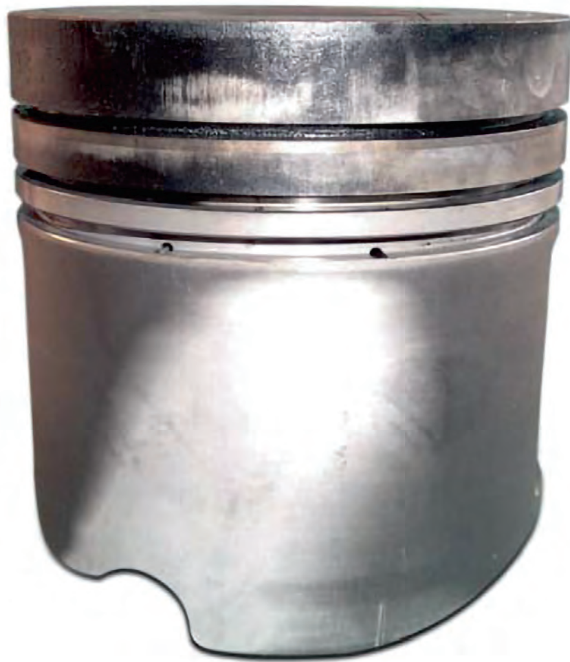
Rys. 1 Niesymetryczny ślad przylegania (ślad kośny) na płaszczu tłoka
