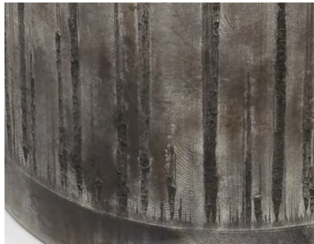
Rys. 2a oraz b Zatarcia na zewnątrz tulei cylindrowej (na całym obwodzie)
