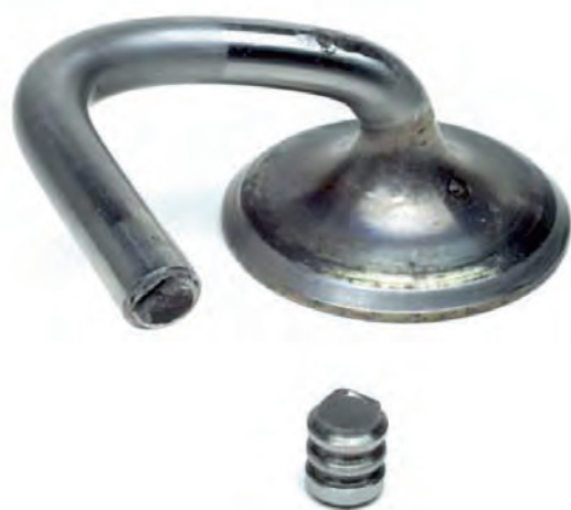
Rys. 1 Mocno zdeformowany zawór
