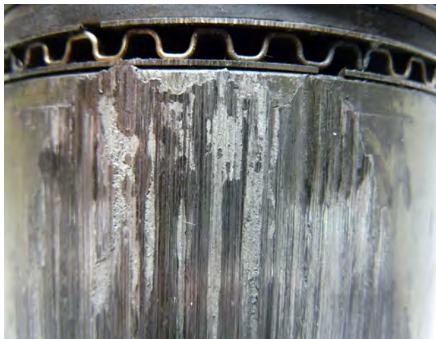
Rys. 2 Pierścienie tłokowe z rowkami i nadpalonymi miejscami
