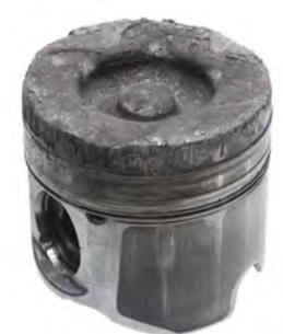
Rys. 4 Stopiony próg ogniowy na tłoku w silniku wysokoprężnym
