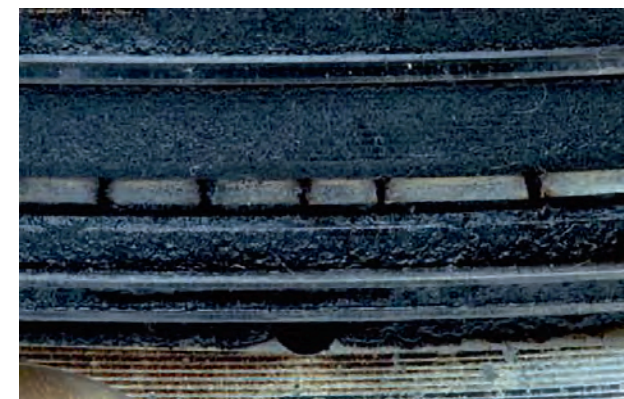
Rys. 2b Zbliżenie na pęknięcie pierścienia tłokowego
