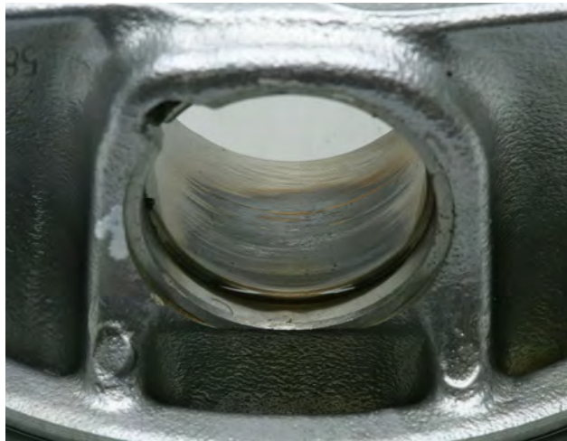
Rys. 3 Otwór piasty ze śladami zatarcia
