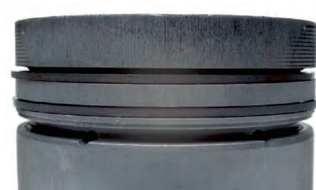
Rys. 2 Silne zużycie osiowe, szczególnie pierwszego pierścienia tłokowego
