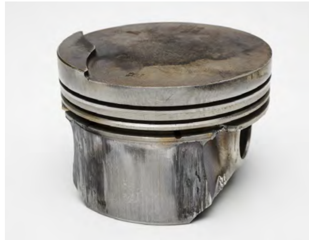
Rys. 2 Boczne zatarcia tłoka obok otworu piasty
