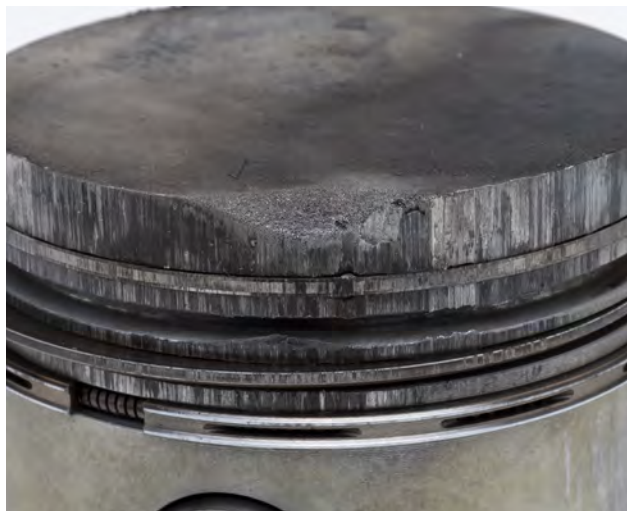
Rys. 1 Ślady erozji na tłoku w silniku z zapłonem iskrowym
