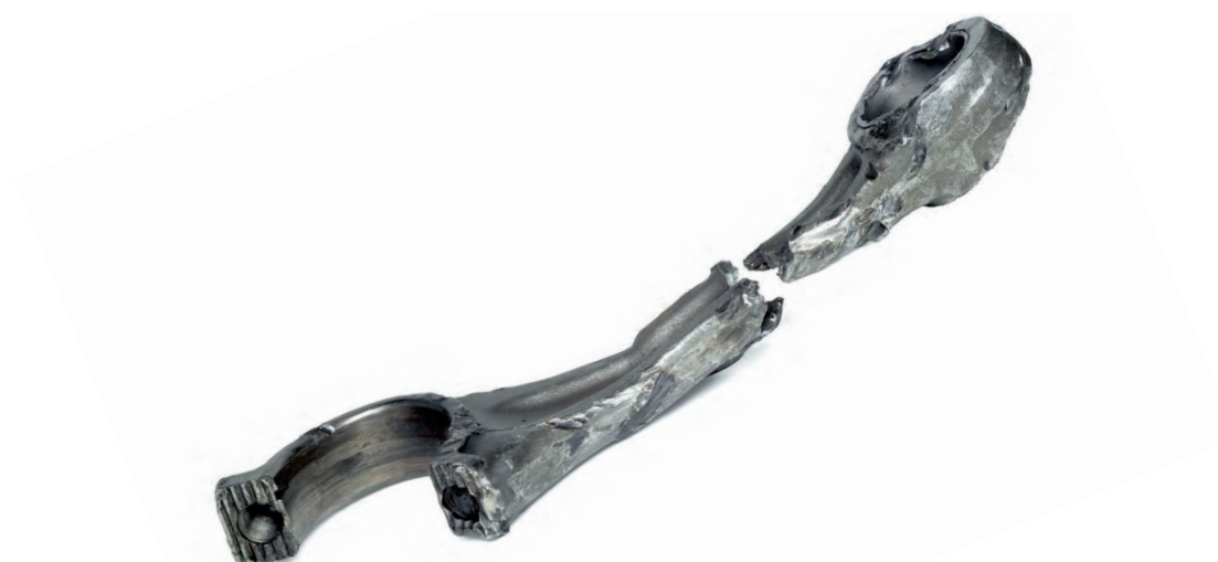
Rys. 3 Łącznik korbowodu wygięty i złamany przez uderzenie cieczy
