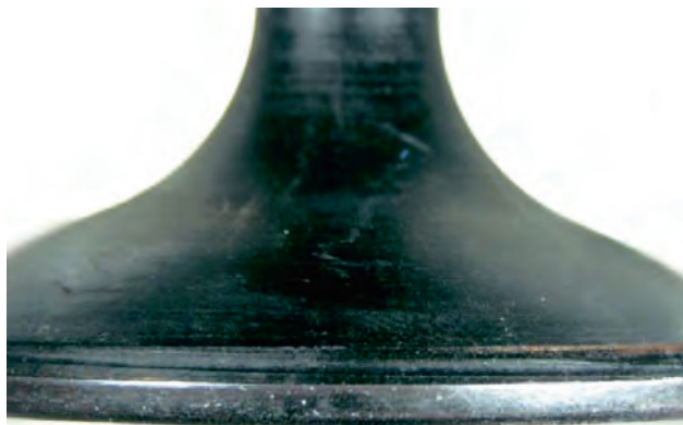
Rys. 1 Zdeformowany talerzyk zaworu (kształt tulipana)
