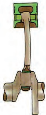
Rys. 3 Wygięty łącznik korbowodu
