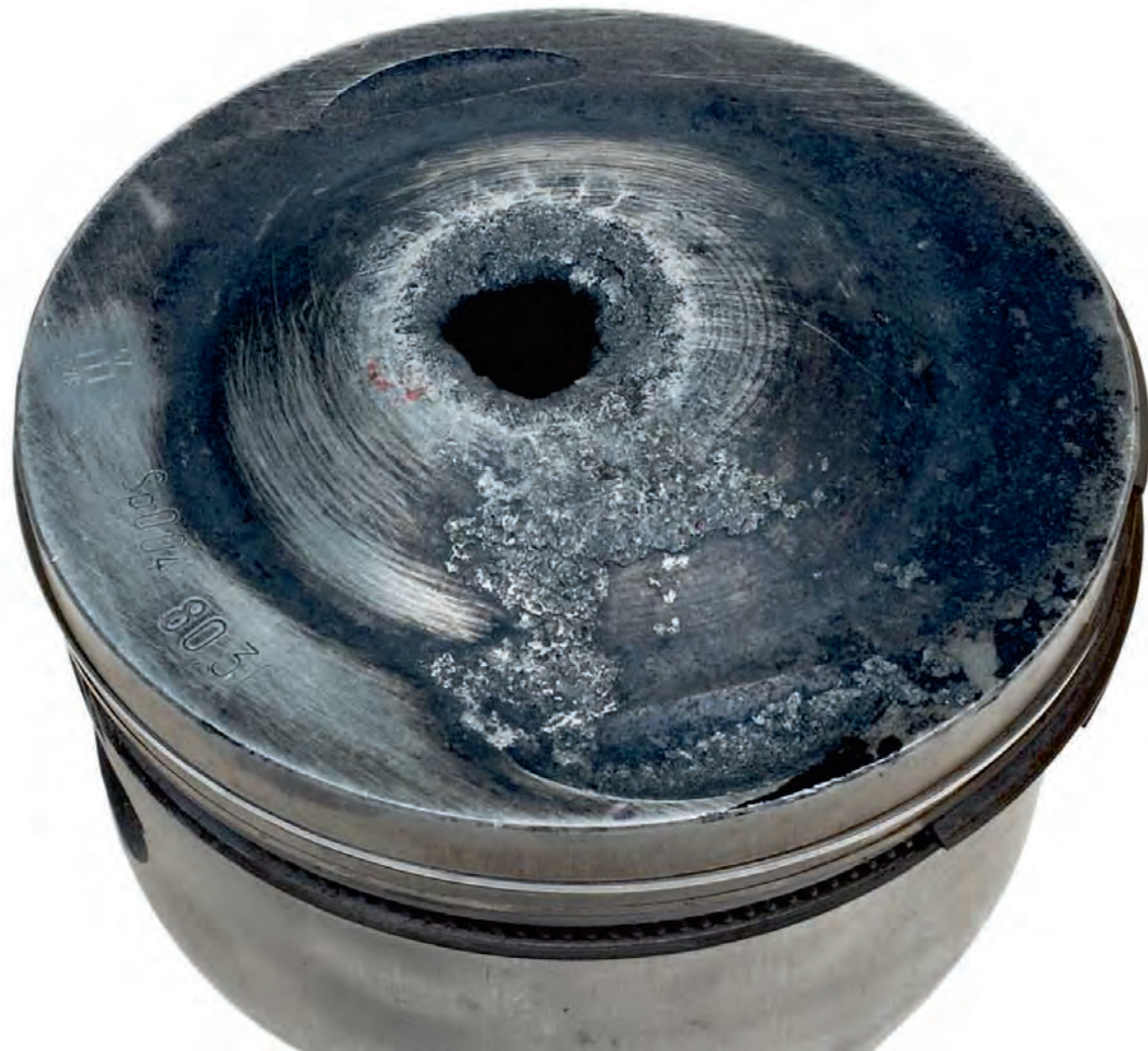
Rys. 1 Otwór w denku tłoka spowodowany użyciem świec zapłonowych o nieprawidłowej wartości cieplnej
