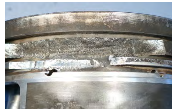
Rys. 3 Pęknięcie progu pierścienia
