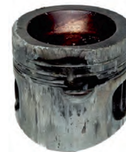
Rys. 2 Stopiony próg ogniowy na silniku z zapłonem iskrowym
