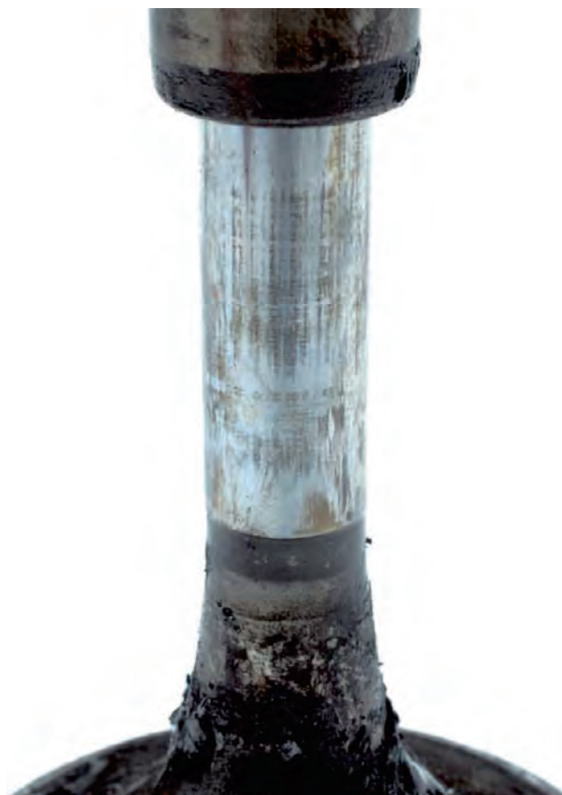
Rys. 1b Zatarcia i rowki na trzonku zaworu
