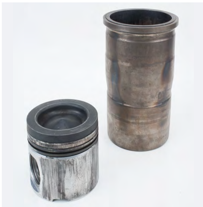
Rys. 1 Zatarcie na tłoku FERROTHERM®, przebarwienia termiczne na tulei cylindra
