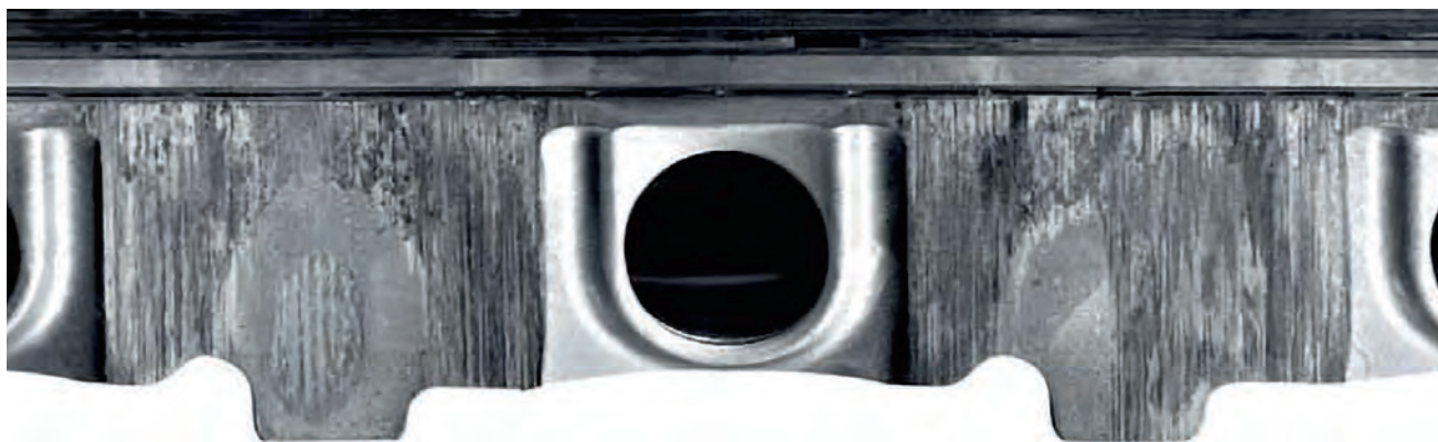
Rys. 2 Zatarcie na płaszczu tłoka, spowodowane niedostatecznym luzem
