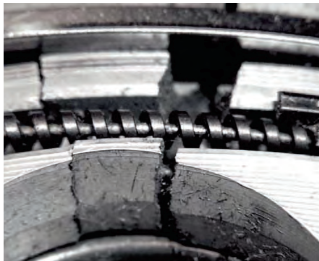
Rys. 2b Zbliżenie na przełom statyczny wywołany oddziaływaniem siły
