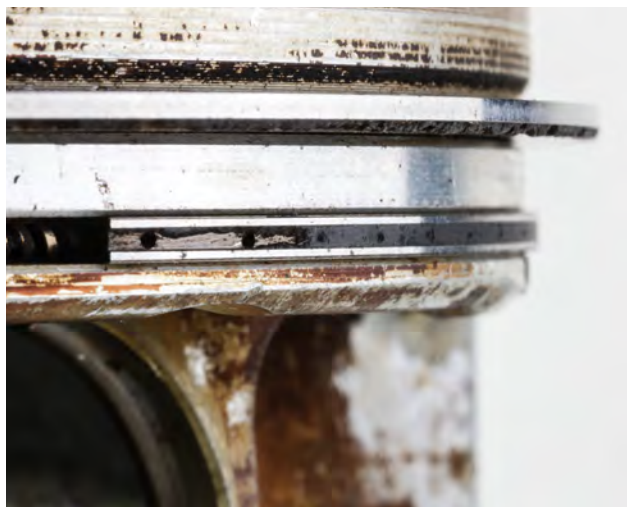
Rys. 2 Zatkany pierścień olejowy
