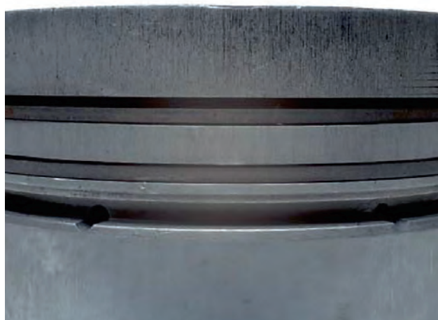
Rys. 2 Osiowe zużycie pierścieni tłokowych
