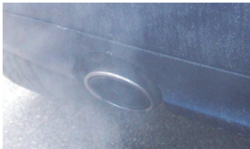
Rys. 3 Zadymiony układ wydechowy
