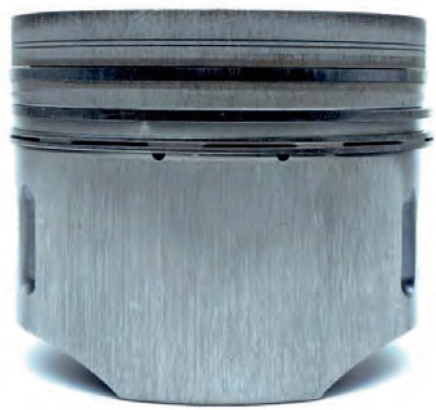
Rys. 1 Zużycie spowodowane zanieczyszczeniami na tłoku – mocne rowki w kierunku wzdłużnym
