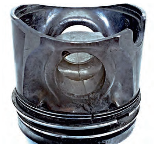
Rys. 2 Pęknięty tłok aż do otworu piasty
