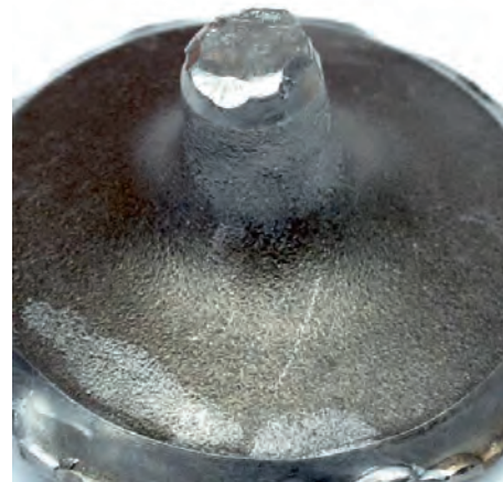
Rys. 2b Pęknięcie na skutek drgań z powierzchni złamania na trzonku zaworu
