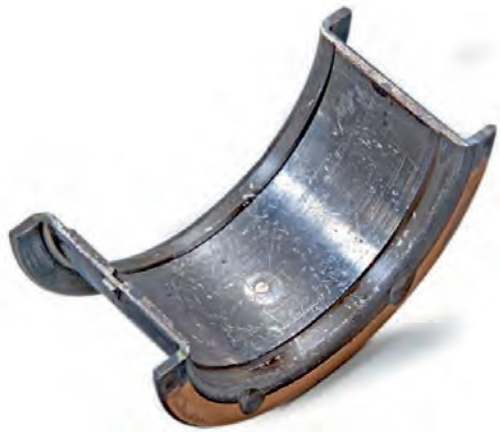
Rys. 1 Ślady zużycia na środku łożyska ślizgowego
