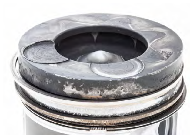
Rys. 2 Uderzenia zaworu w denko tłoka
