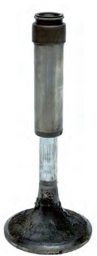
Fig. 1a Soupape grippée dans le guide
