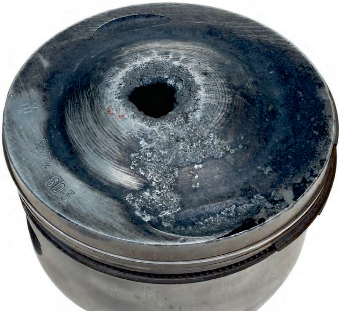
Fig. 1 Tête de piston percée à cause de bougies d'allumage ayant un indice thermique incorrect
