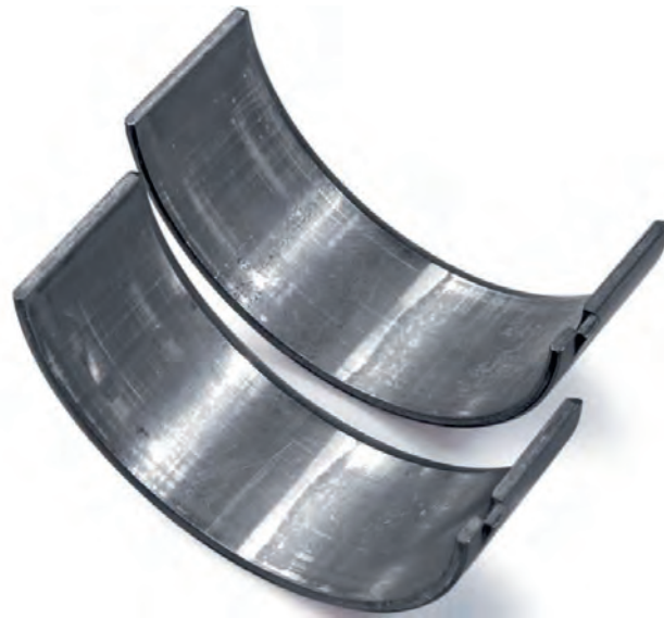
Fig. 1 Usure des bords extérieurs des coussinets
