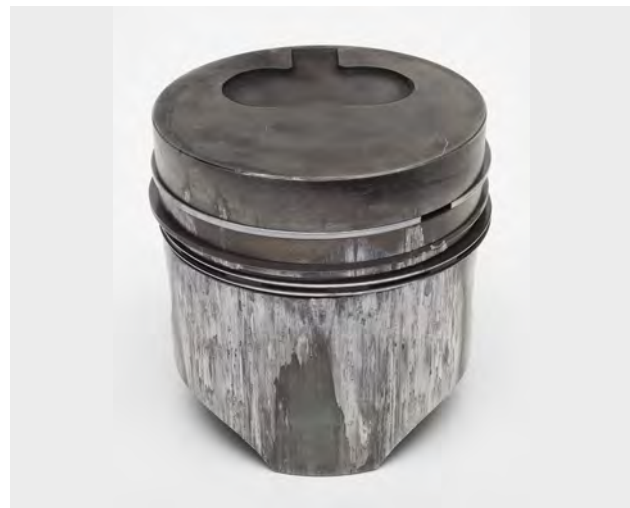
Fig. 1 Grippage sur la jupe de piston
