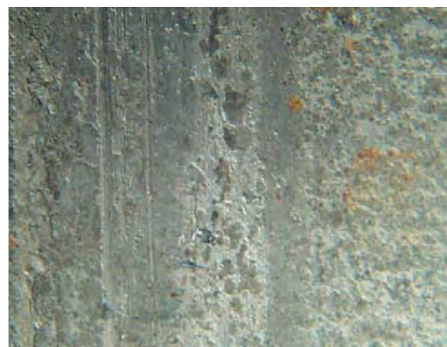
Fig. 1b Matériau du coussinet attaqué nettement visible en gros plan
