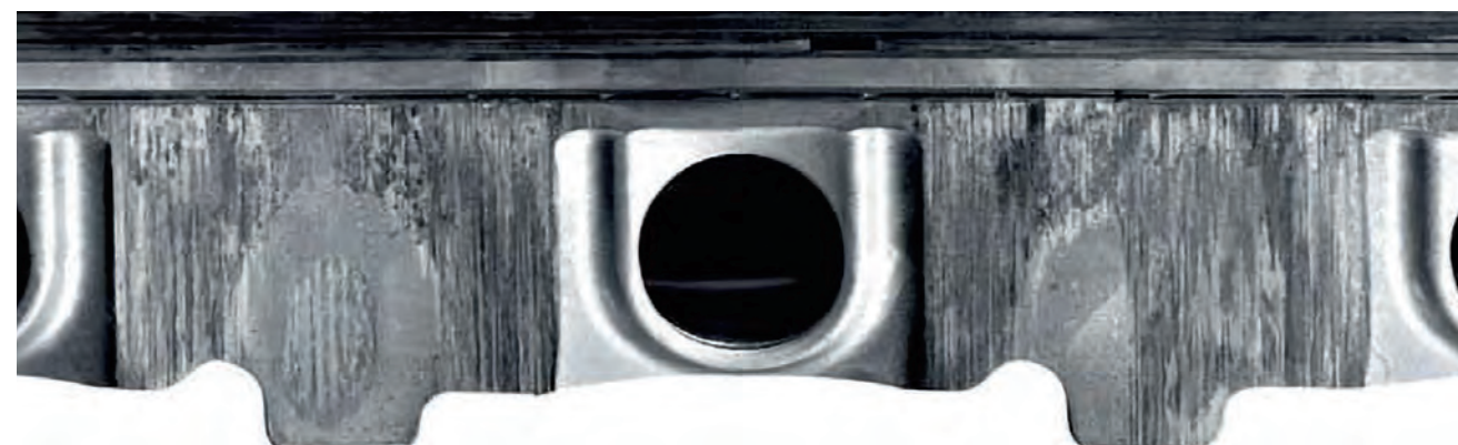
Fig. 2 Grippage sur la jupe à cause d'un manque de jeu
