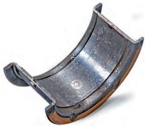
Fig. 1 Traces d'usure au centre du coussinet
