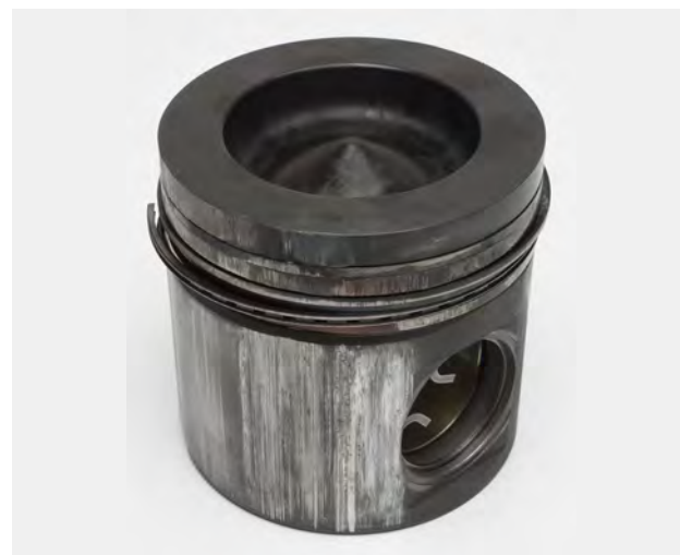
Fig. 2 Point de fusion sur le segment de feu et grippage sur la jupe
