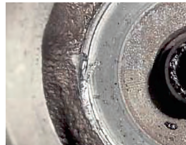
Fig. 5 Traces sur la culasse causées par un ressort de soupape incliné
