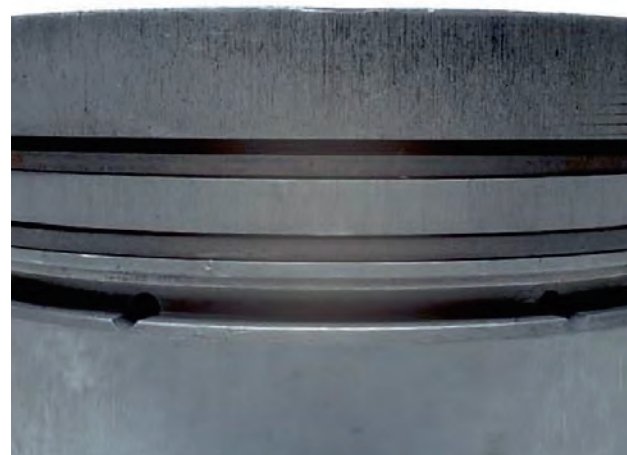
Fig. 2 Usure axiale des segments
