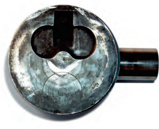
Fig. 1 Tête de piston avec chocs causés par la soupape
