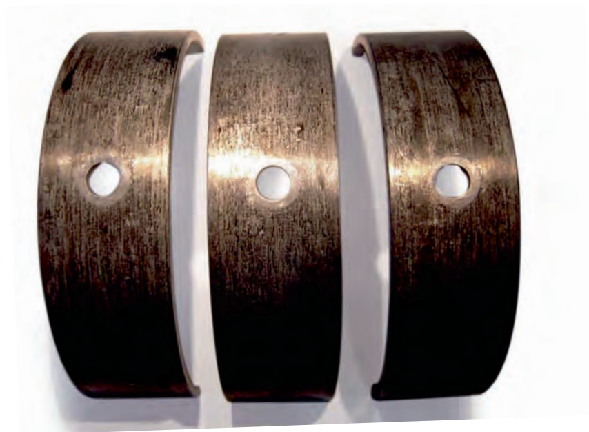
Fig. 1 Zones polies à l'extérieur des coussinets
