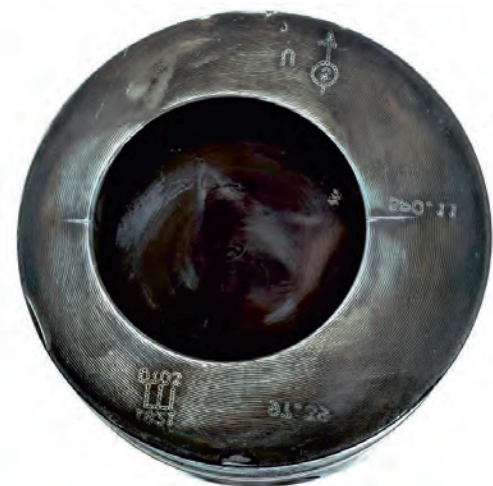
Fig. 3a Fissures sur le bord de la chambre de combustion
