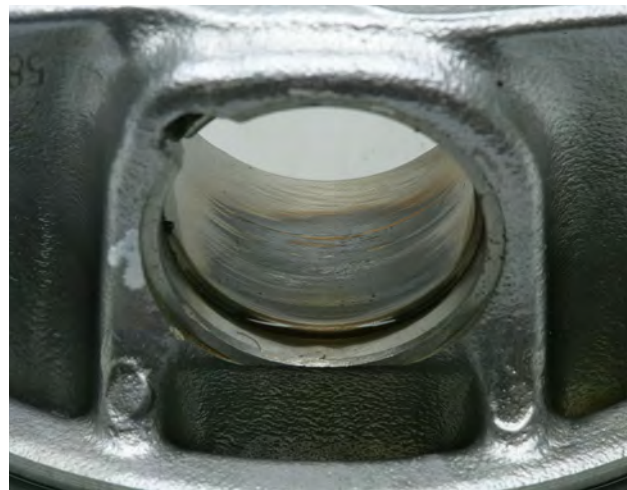
Fig. 3 Traces de grippage sur l'alésage de l'axe
