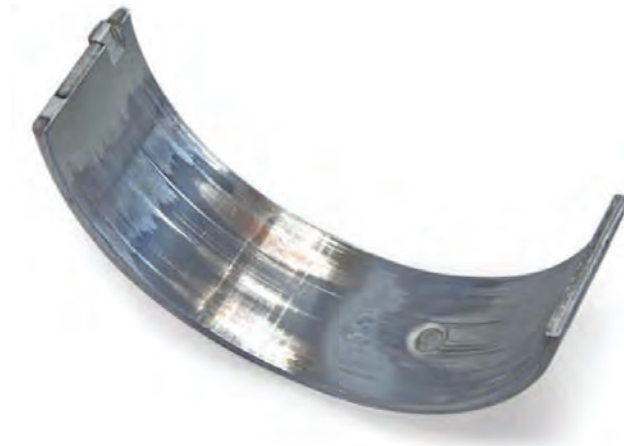
Fig. 2 Usure inégale sur les demi-coussinets
