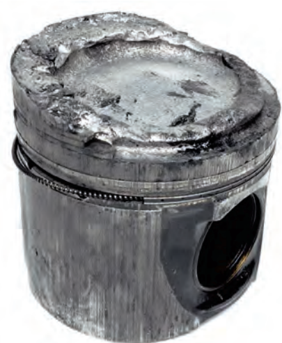
Fig. 1 Couronne de piston fondue sur piston diesel
