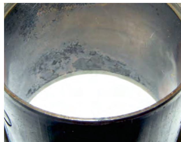
Fig. 2 Bague de bielle endommagée
