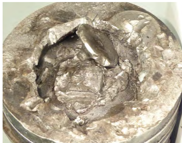
Fig. 1 Tête de soupape cassée et martelée dans le piston
