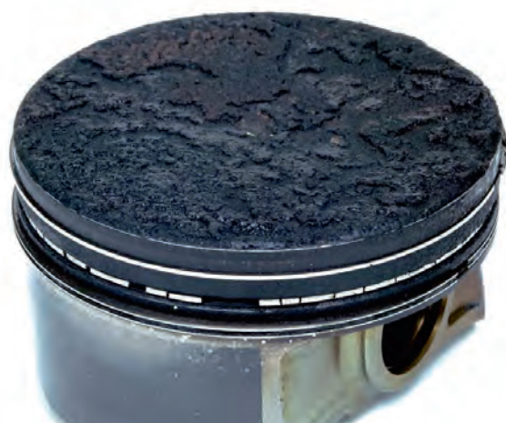
Fig. 2a Rupture du segment causée par du cliquetis
