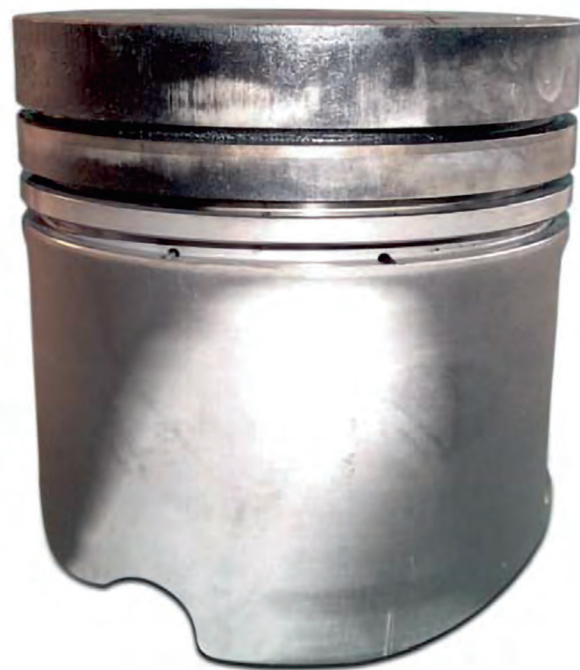
Fig. 1 Portée asymétrique (course oblique) sur la jupe de piston
