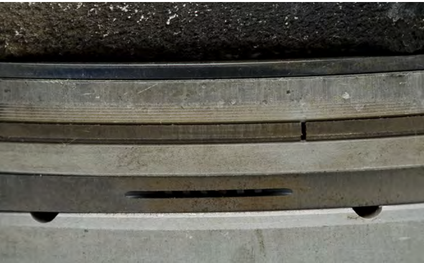
Fig. 2 Stries et traces de brûlure sur les segments
