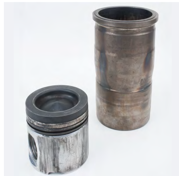
Fig. 1 Grippage sur piston FERROTHERM®, décolorations thermiques sur la chemise de cylindre
