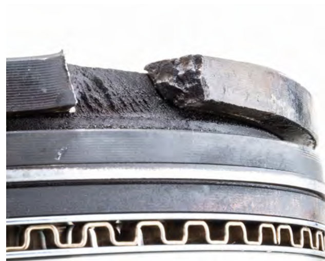
Fig. 2 Rupture brutale du segment de feu
