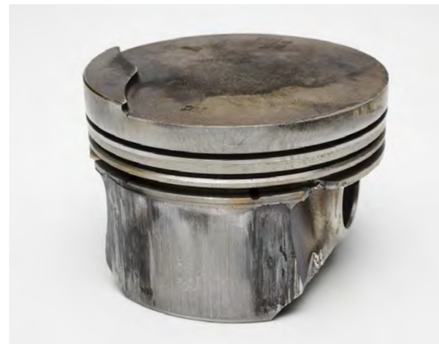
Fig. 2 Grippage latéral à côté de l'alésage de l'axe
