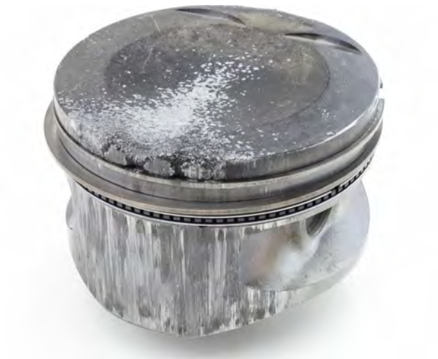
Fig. 2 Traces de calcination (cliquetis)
