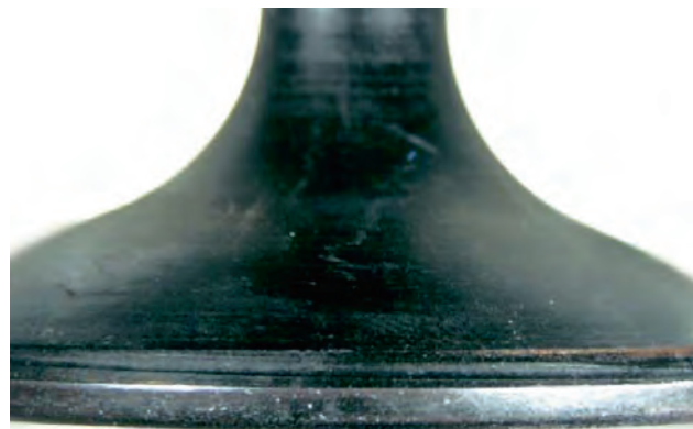
Fig. 1 Tête de soupape déformée (en tulipe)
