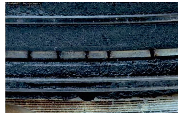
Fig. 2b Gros plan d'une rupture de segment
