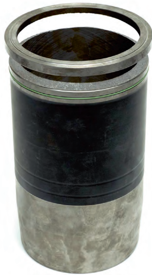
Fig. 1 Rupture de la collette d'une chemise de cylindre
