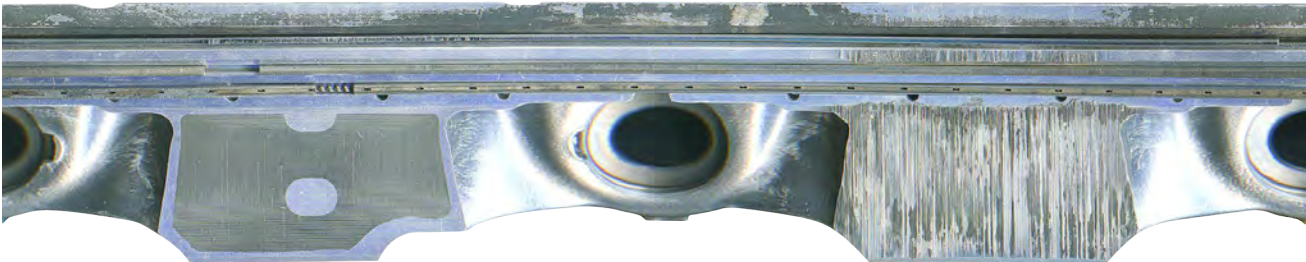
Fig. 2 Grippage d'un côté en panorama
