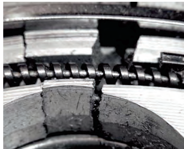
Fig. 2b Gros plan d'une rupture brutale
