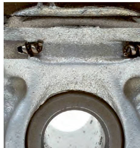
Fig. 1b Gros plan des surfaces du piston en matière tendre et de la segmentation en matière dure, avec enlèvement de matière identique dans les deux cas
