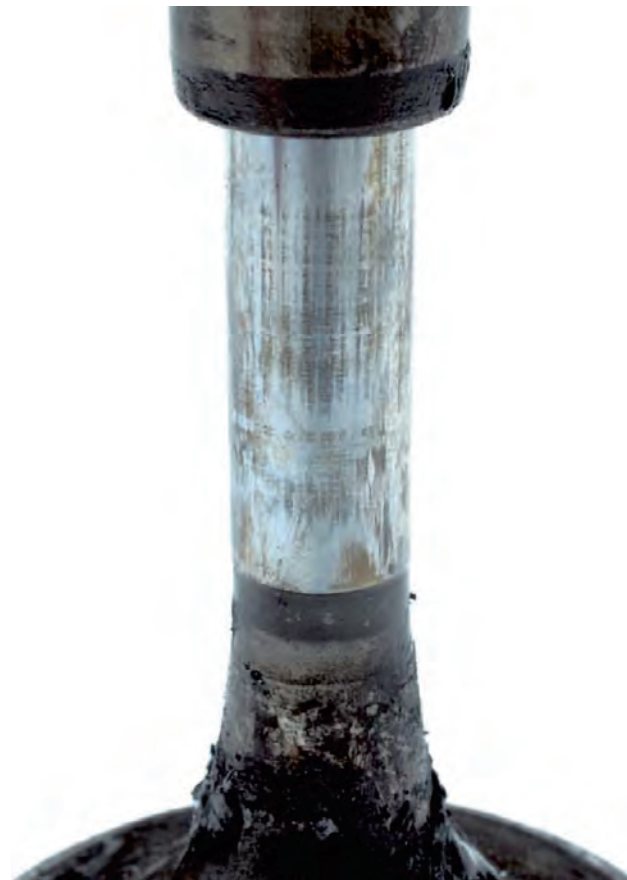
Fig. 1b Grippage et stries sur la tige de soupape
