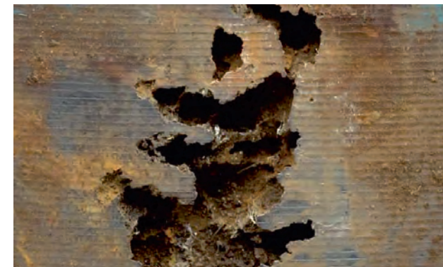
Fig. 1b Gros plan de la chemise de cylindre avec des arêtes coupantes et des perforations s'élargissant vers l'intérieur
