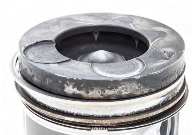
Fig. 2 Impacts de la soupape sur la tête du piston
