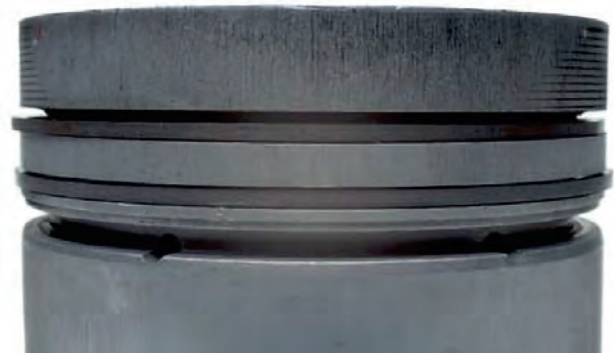
Fig. 2 Forte usure axiale, notamment sur le premier segment
