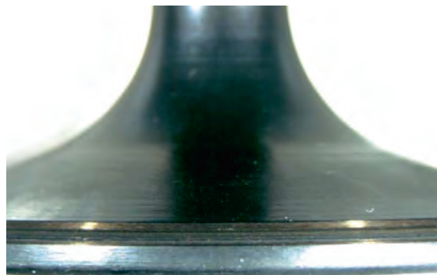
Fig. 2 Pour comparaison : tête de soupape sans déformation
