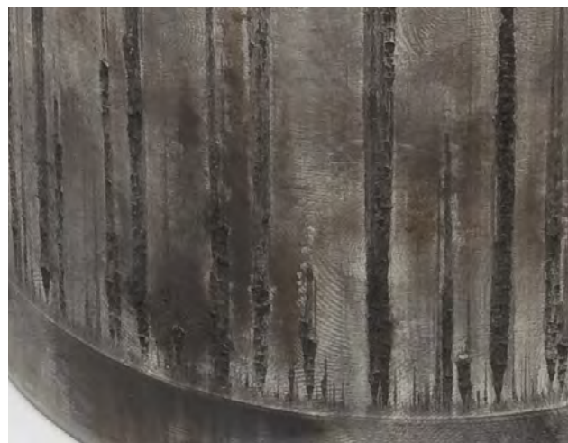
Fig. 2a+b Grippage à l'extérieur de la chemise de cylindre (sur toute la circonférence)
