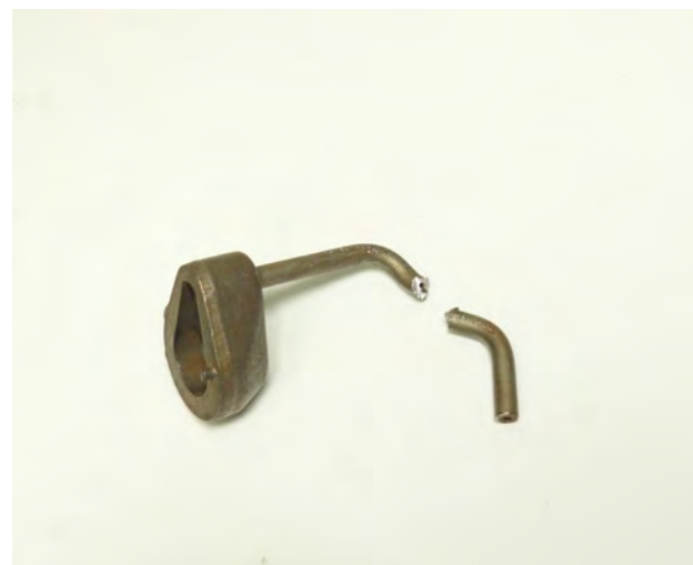
Fig. 4 Buse d'huile de refroidissement cassée
