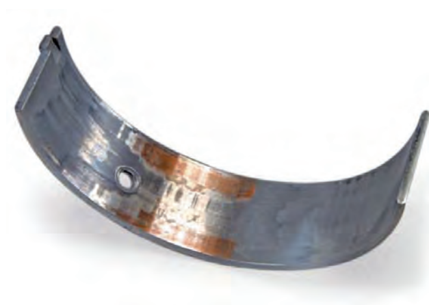
Fig. 1 Usure inégale sur les demi-coussinets, couche de frottement partiellement érodée
