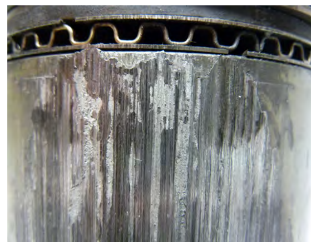
Fig. 2 Segments avec stries et traces de brûlure
