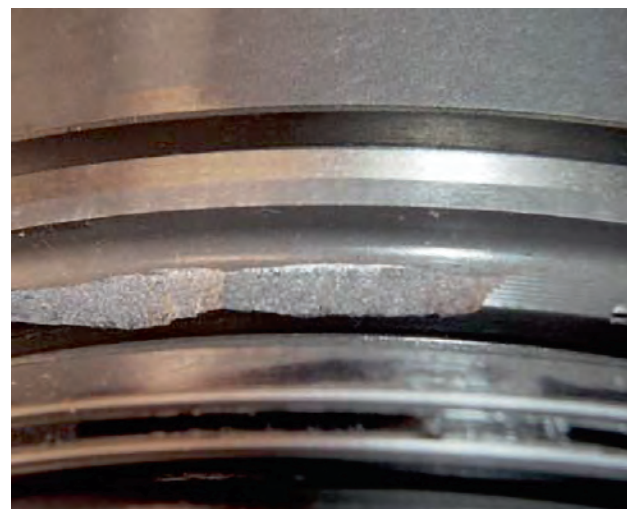
Fig. 3 Rupture de bas en haut
