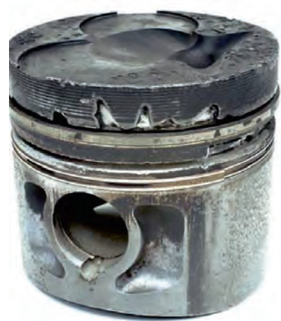
Fig. 1 Dommages sur la tête de piston causés par des fragments du porte-segment
