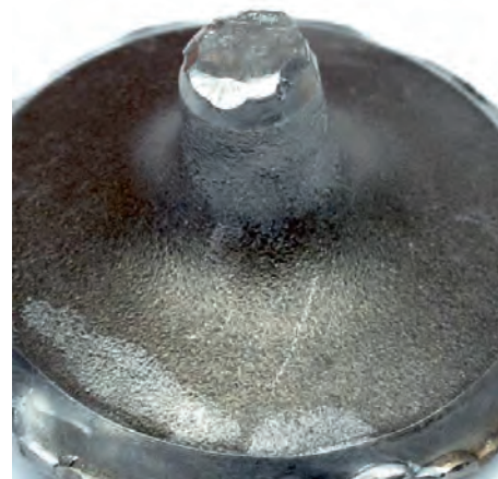
Fig. 2b Rupture par vibration au niveau de la tige de soupape
