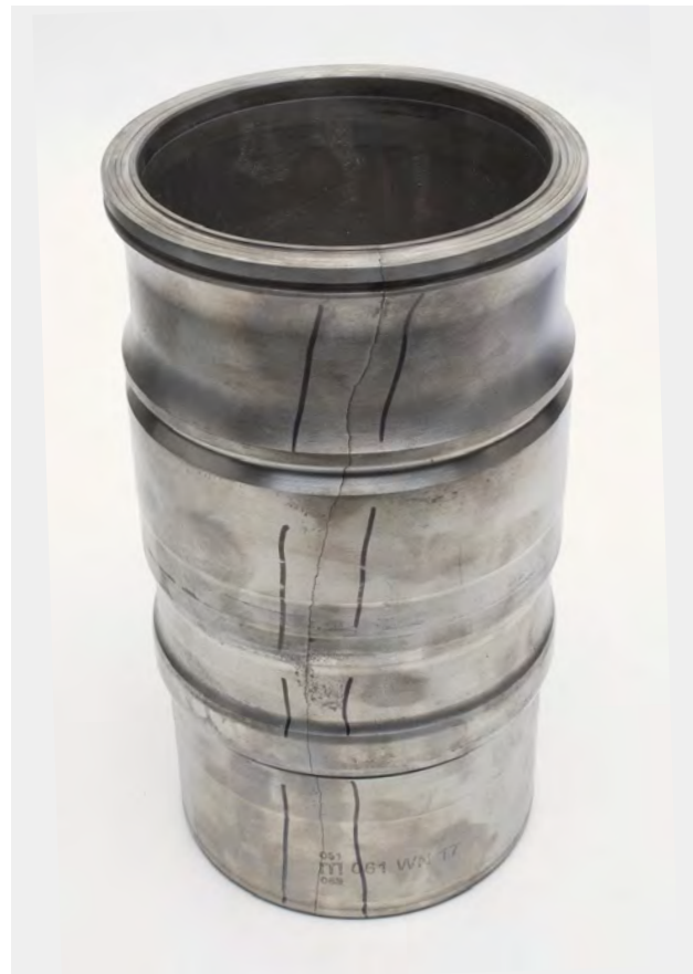
Fig. 1 Fissure longitudinale dans la chemise de cylindre
