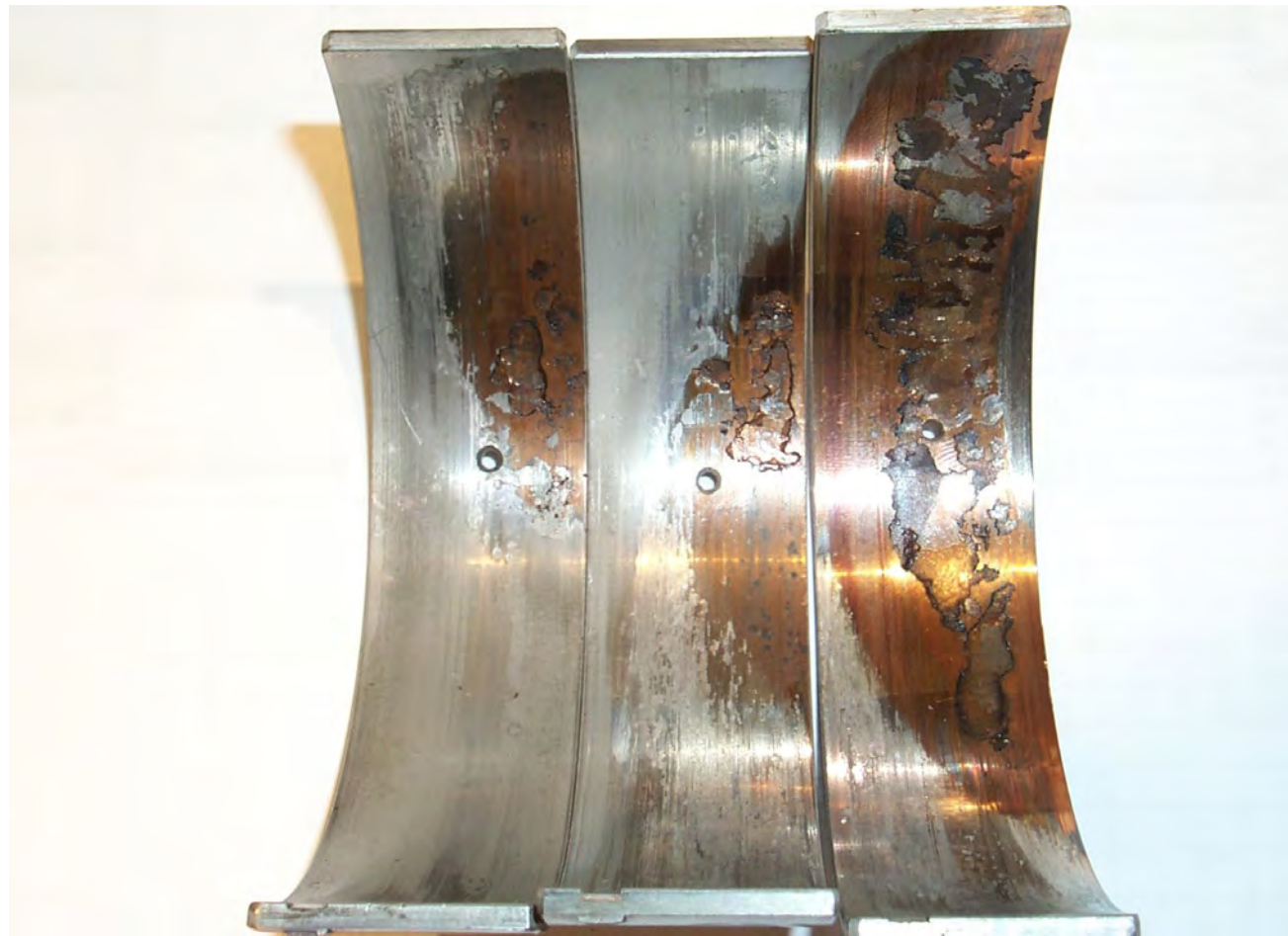
Fig. 1 Matière arrachée suite à une surcharge mécanique ou à une capacité de charge insuffisante du film d'huile
