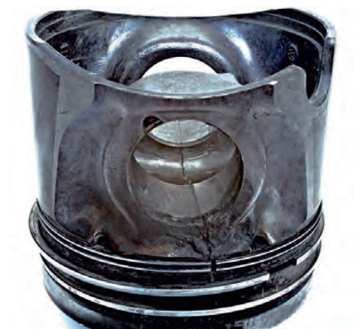
Fig. 2 Piston cassé jusqu' dans l'alésage de l'axe
