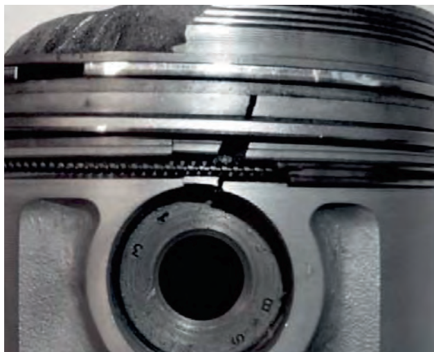
Fig. 2a Rupture brutale de la tête de piston à l'alésage de l'axe
