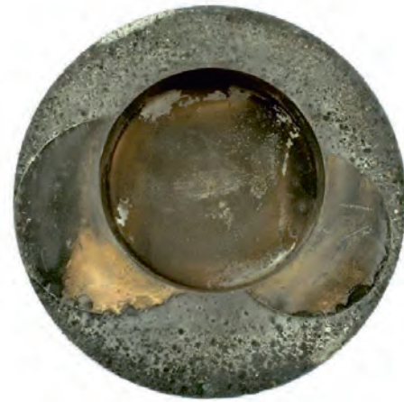
Fig. 2 Piston ayant cogné contre la culasse
