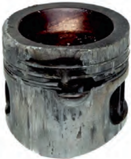
Fig. 2 Segment de feu fondu sur piston essence
