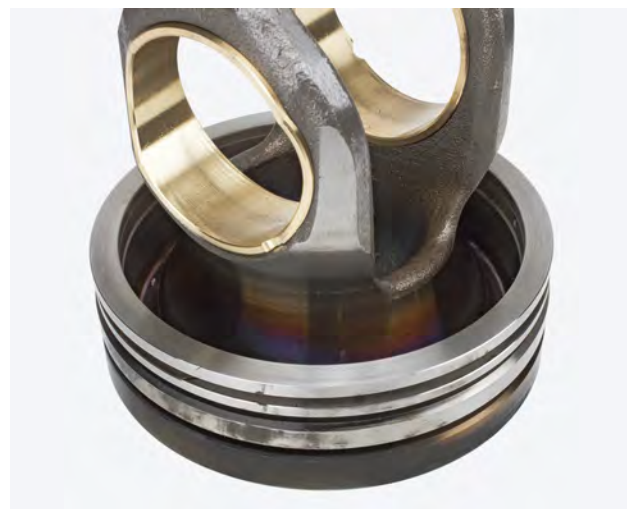
Fig. 3 Décoloration due à une surchauffe sur piston FERROTHERM®
