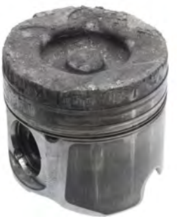
Fig. 4 Segment de feu fondu sur piston diesel
