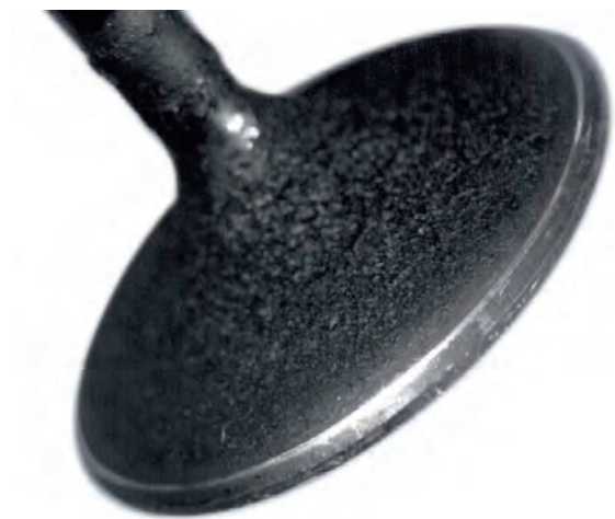
Fig. 3 Traces de contact linéaires sur la tête déformée
