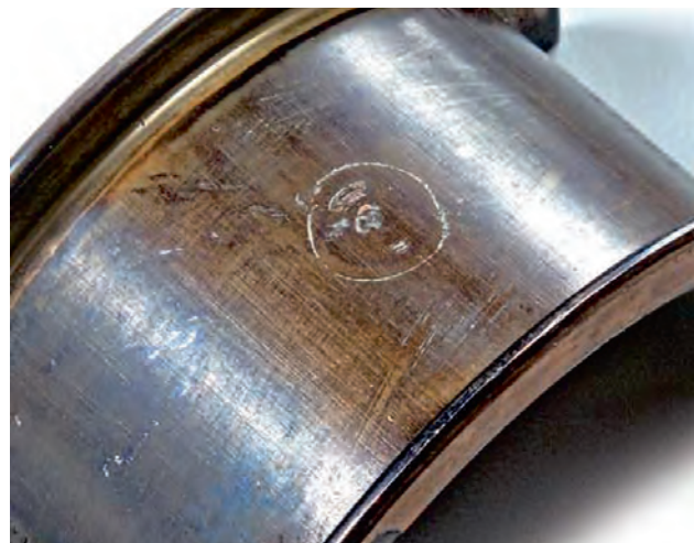
Fig. 2 Marque d'un corps étranger sur l'extérieur du coussinet
