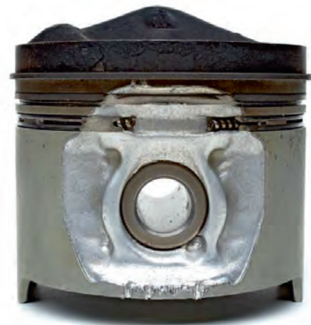
Fig. 1a Paroi du piston érodée par un circlip desserré ou par des corps étrangers dans l'alésage de l'axe du piston
