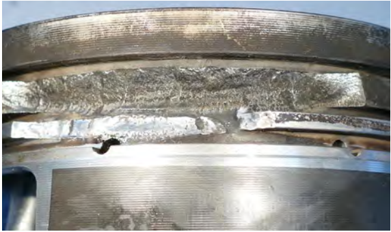
Fig. 3 Rupture du segment
