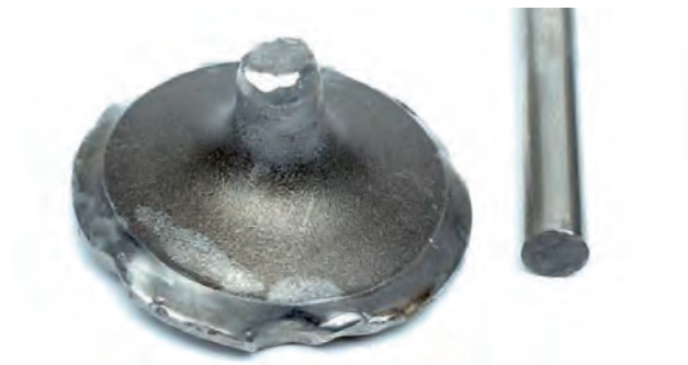
Fig. 2a Tête de soupape cassée
