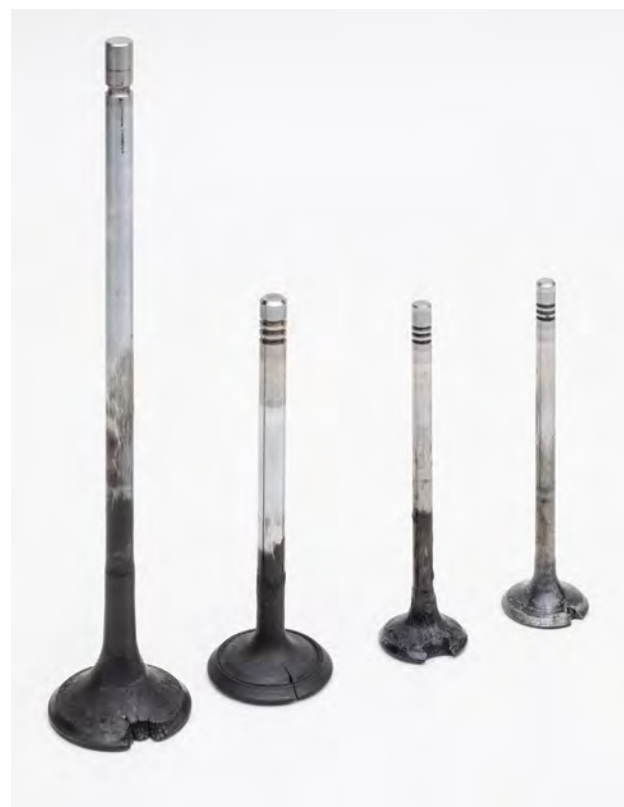
Fig. 2 Fissures et points de fusion à différents stades
