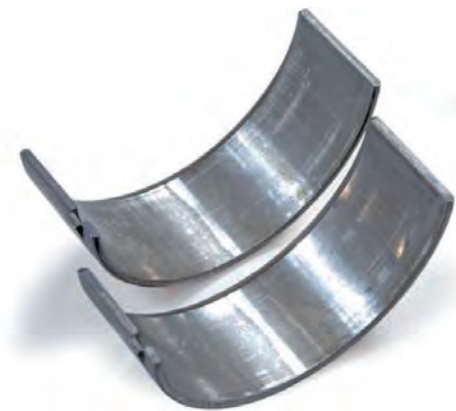
Fig. 1 Zones brillantes sur les surfaces de frottement des demi-coussinets
