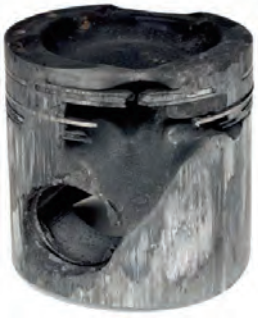
Fig. 3 Piston calciné sur moteur diesel
