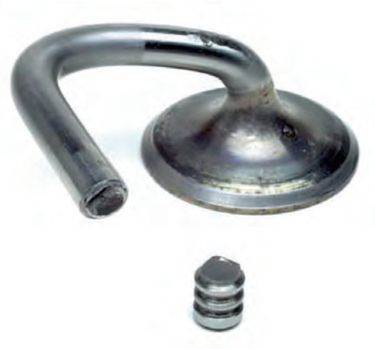
Fig. 1 Soupape fortement déformée
