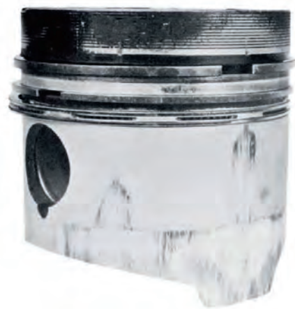
Fig. 1 Grippage sur le bas de la jupe par rétrécissement de la chemise de cylindre
