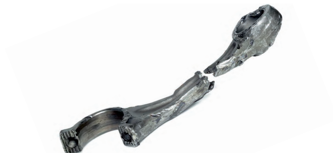
Fig. 3 Bielle pliée et cassée à cause d'une intrusion de liquide
