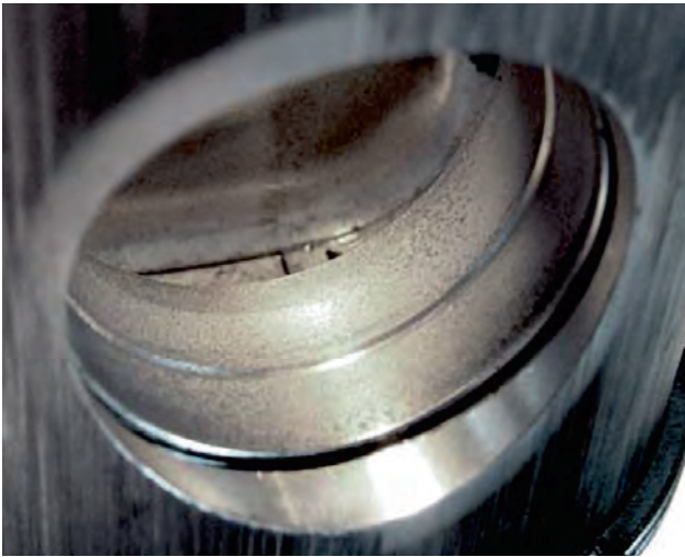
Fig. 1 Piqûres dans l'alésage de l'axe causées par la dilution de l'huile moteur
