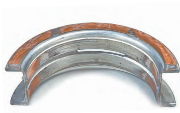
Fig. 1a Usure sur les surfaces de frottement près de la jointure du coussinet
