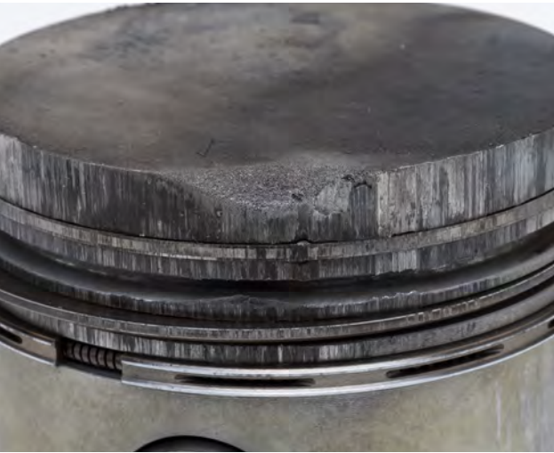
Fig. 1 Traces d'érosion sur un piston essence
