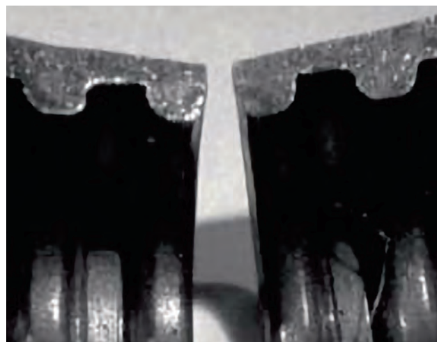
Fig. 3 Déformation des clavettes sur les bourrelets
