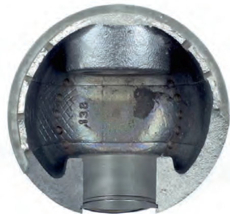
Fig. 3 Rupture transversale du piston au niveau de l'axe du piston
