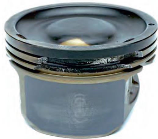
Fig. 1 Segments cassés suite à un dysfonctionnement dans le processus de combustion
