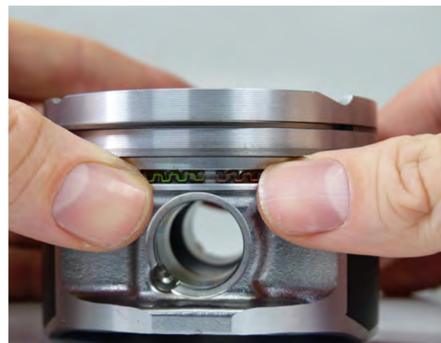
Fig. 1 Ressort d'expansion correctement inséré (les deux repères de couleur sont visibles)
