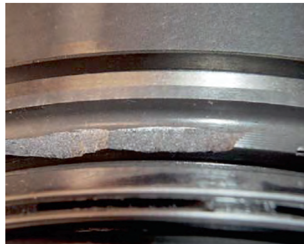
Fig. 3 Progresión de la rotura de abajo hacia arriba
