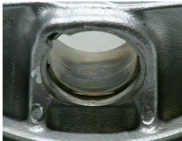
Fig. 3 Orificio con marcas de gripado
