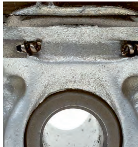
Fig. 1b Primer plano de las superficies de material de pistón más blando y material de segmento más duro, desgastado en la misma medida
