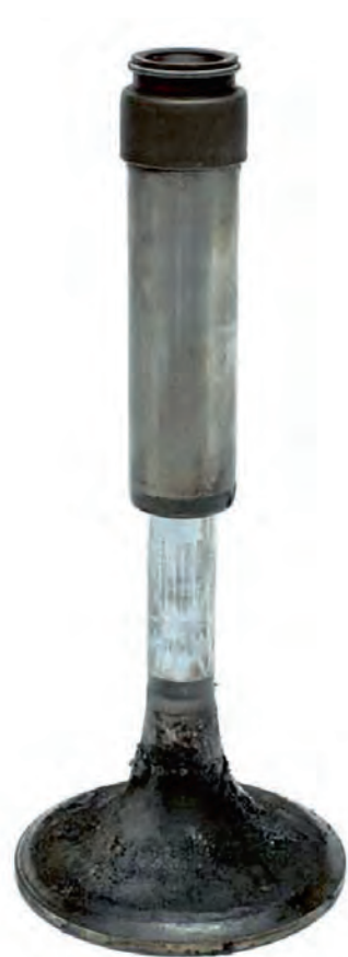
Fig. 1a El vástago de la válvula está gripado en la guía
