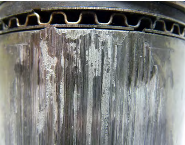
Fig. 2 Segmentos con estrías y puntos quemados
