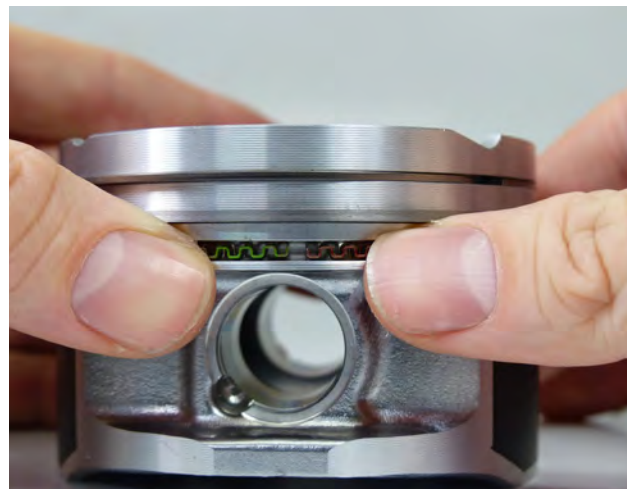
Fig. 1 Muelle expansor correctamente insertado (ambas marcas de color visibles)
