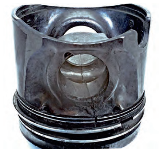
Fig. 2 Pistón roto hasta el orificio
