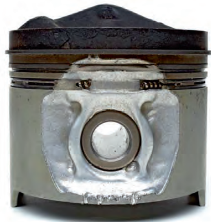
Fig. 1a Pared del pistón erosionada debido a un circlip de bulón suelto o partículas extrañas en el orificio del bulón de pistón
