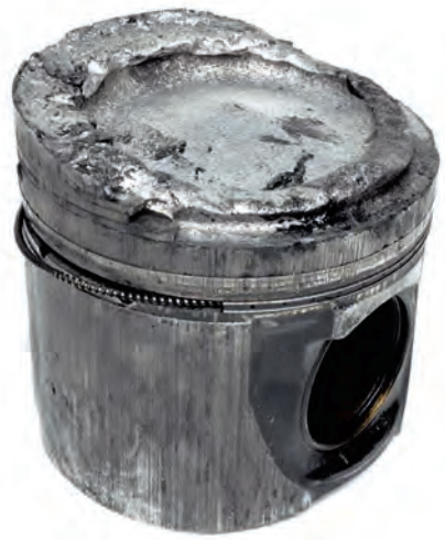
Fig. 1 Corona del pistón derretida en el pistón de diésel
