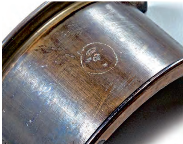
Fig. 2 Impresión de partículas extrañas en el exterior del cojinete
