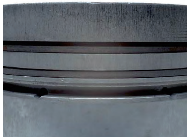
Fig. 2 Desgaste axial de los segmentos de pistón
