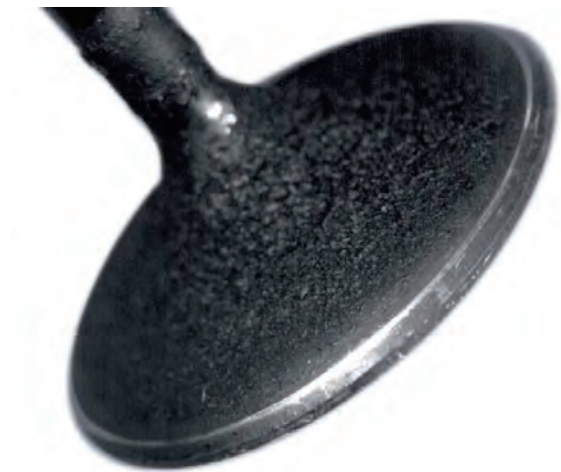
Fig. 3 Marcas de contacto lineales en el platillo de válvula deformado
