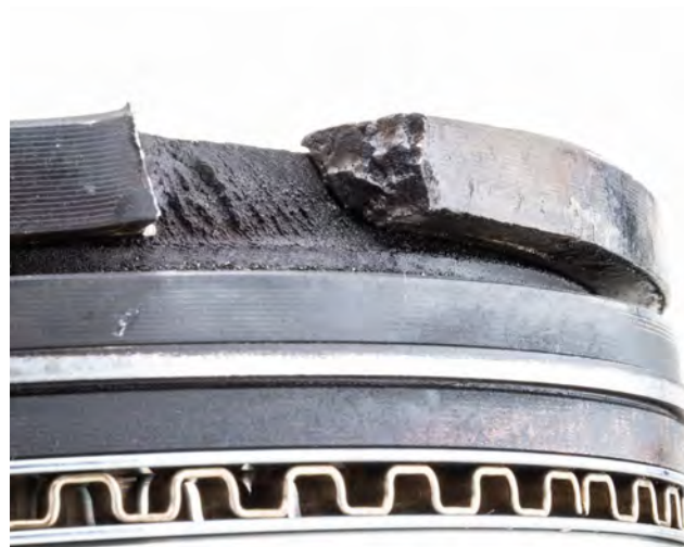
Fig. 2 Rotura por la fuerza del cordón de fuego
