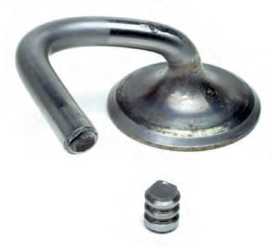
Fig. 1 Válvula extremadamente deformada
