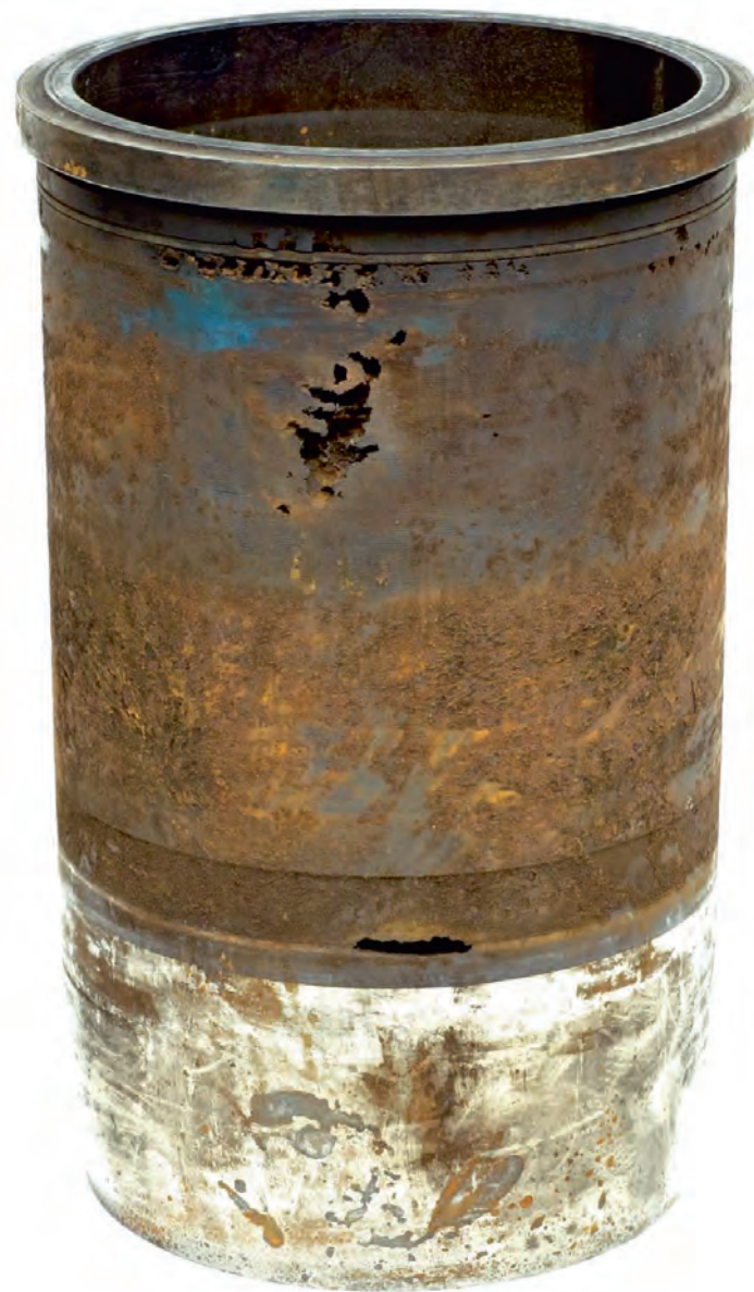
Fig. 1a Camisa de cilindro con daños por cavitación
