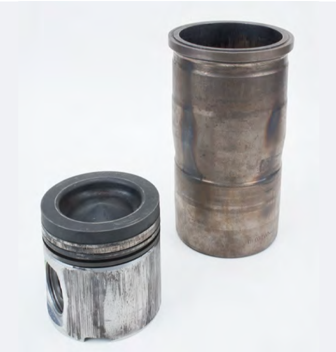
Fig. 1 Gripado en pistones FERROTHERM®, decoloración térmica en la camisa de cilindro
