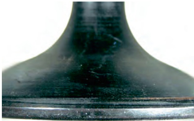
Fig. 1 Platillo de válvula deformado (forma de tulipán)
