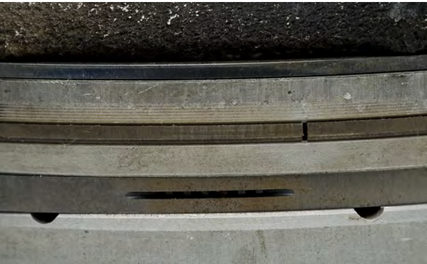
Fig. 2 Estrías y puntos quemados en los segmentos
