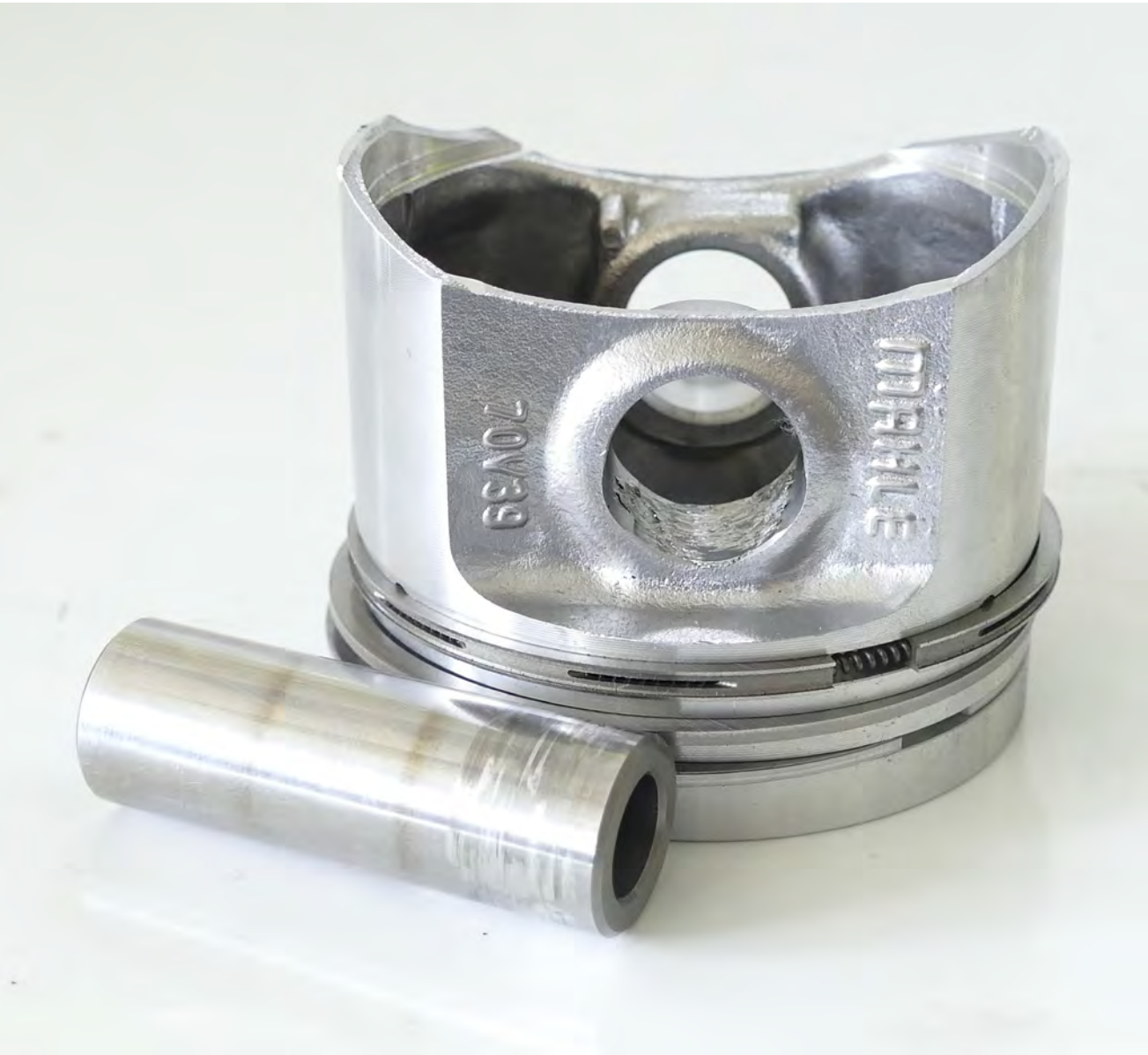
Fig. 1 Gripado en el orificio
