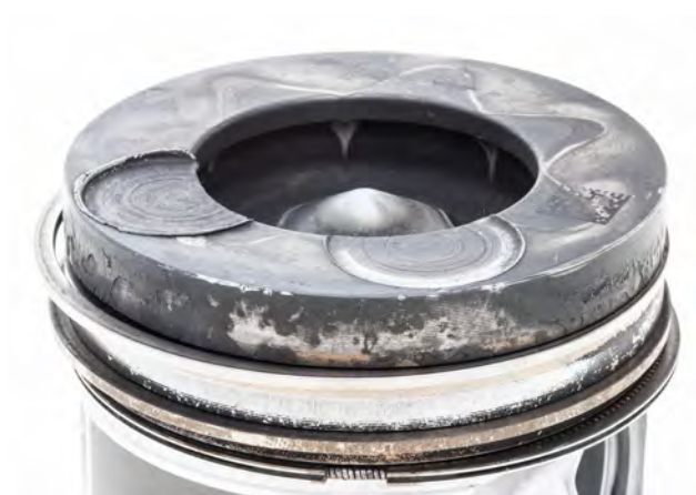
Fig. 2 Impactos de válvula en la cabeza del pistón
