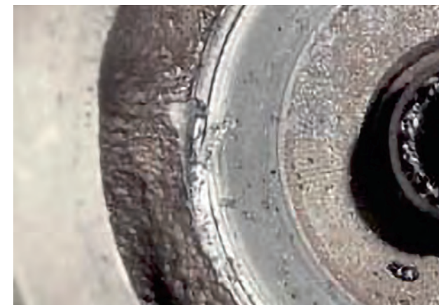
Fig. 5 Marcas en la culata, provocadas por un muelle de válvula insertado de forma descentrada
