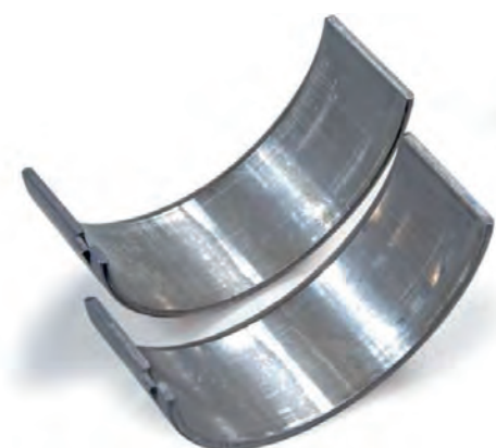
Fig. 1 Puntos brillantes en las superficies de rodadura de los semicojinetes
