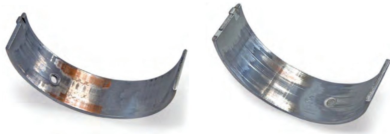
Fig. 1 Desgaste desigual en los semicojinetes, capa de rodamiento parcialmente desgastada
