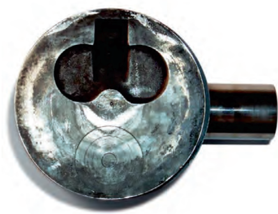
Fig. 1 Cabeza de pistón con impacto de válvula
