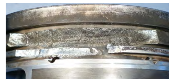
Fig. 3 Rotura del cordón de segmento
