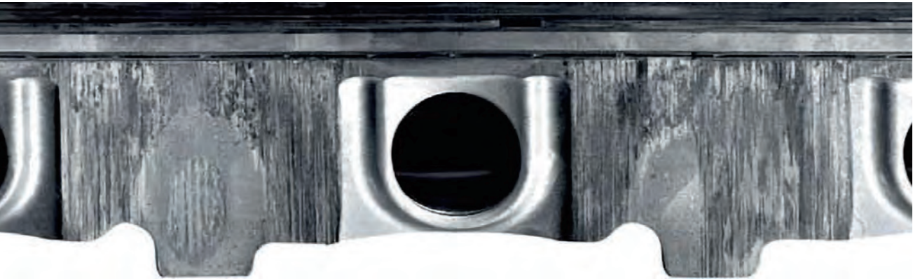
Fig. 2 Gripado en la falda de pistón, causado por la falta de holgura
