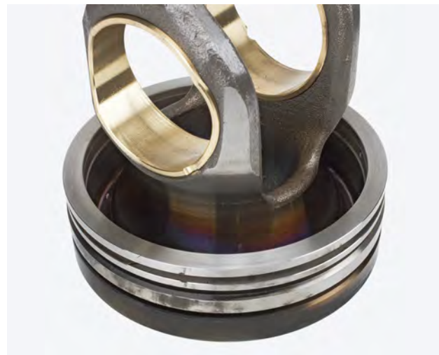
Fig. 3 Decoloración por sobrecalentamiento en el pistón FERROTHERM®
