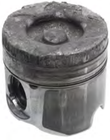
Fig. 4 Cordón de fuego fundido en el pistón de diésel
