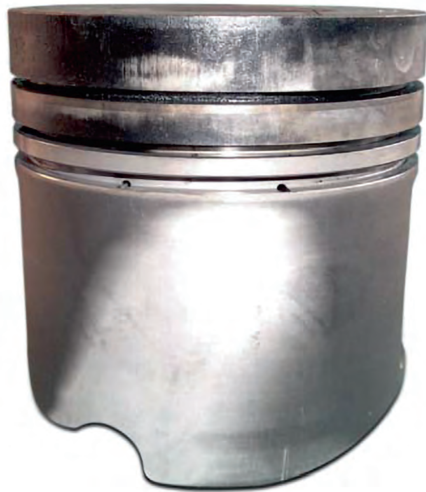
Fig. 1 Patrón de contacto asimétrico (inclinado) en la falda de pistón
