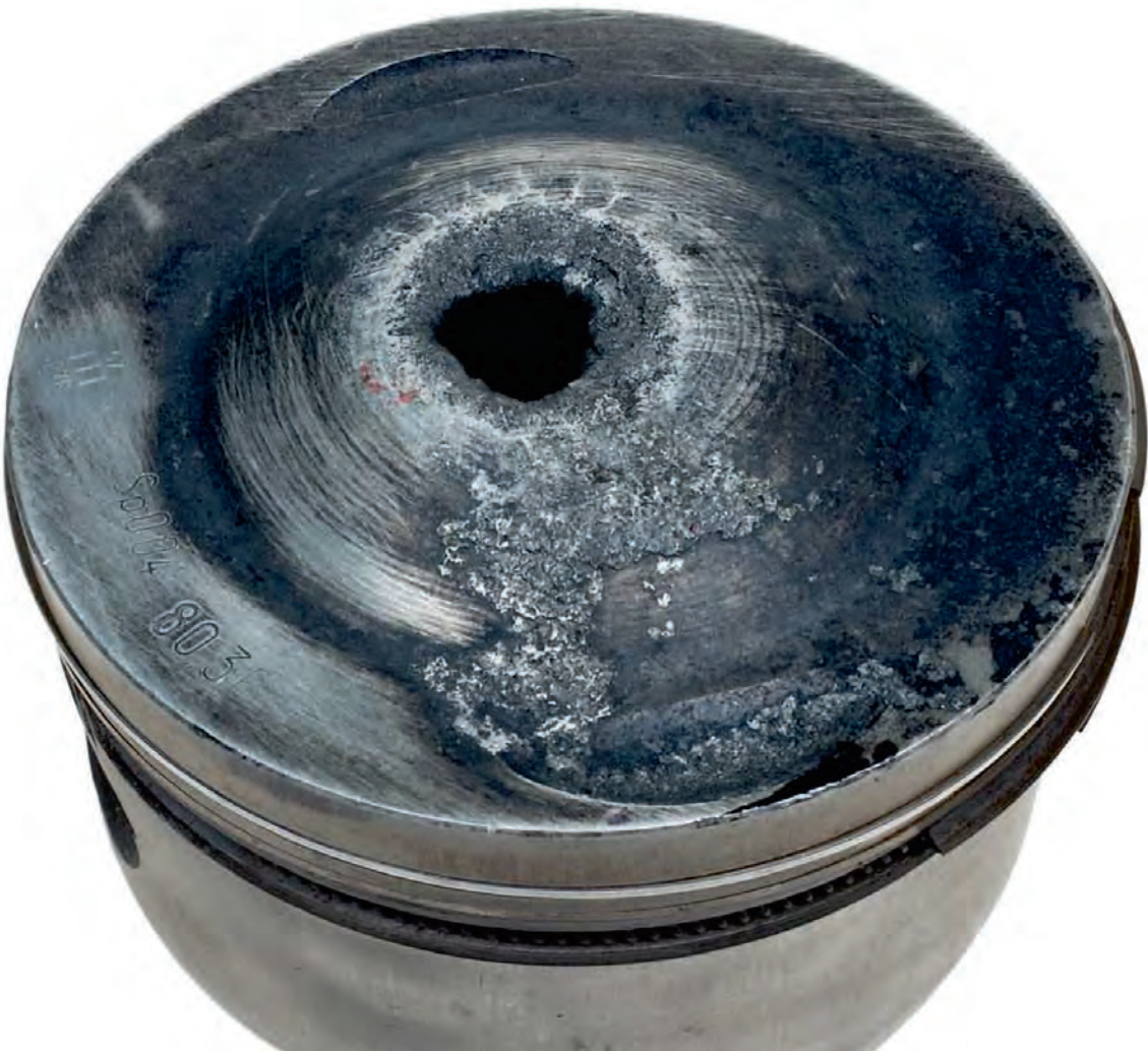
Fig. 1 Agujero en la cabeza del pistón causado por el uso de bujías con un grado térmico incorrecto
