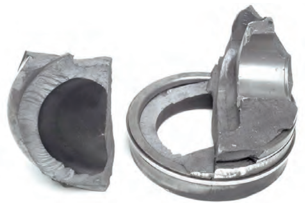
Fig. 1 Pistón de vehículo industrial reventado por un bloqueo hidráulico
