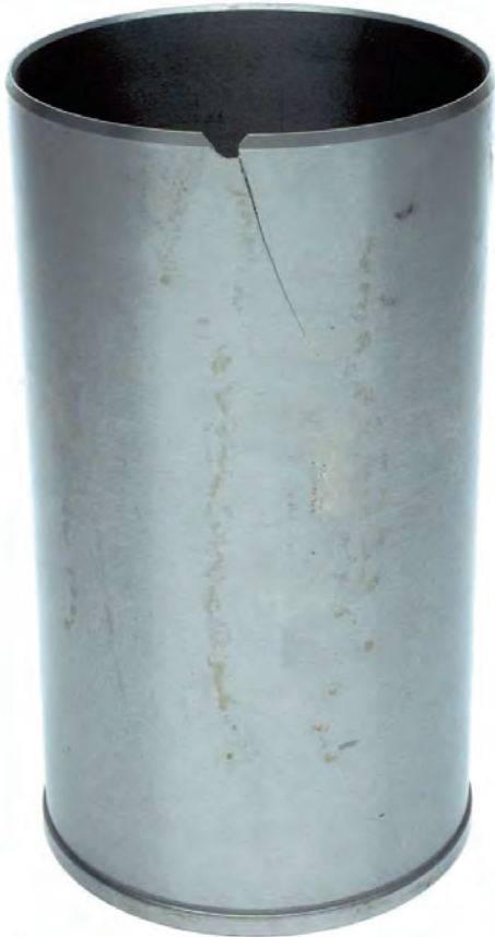
Fig. 2 Extremo inferior de la camisa de cilindro con rotura longitudinal
