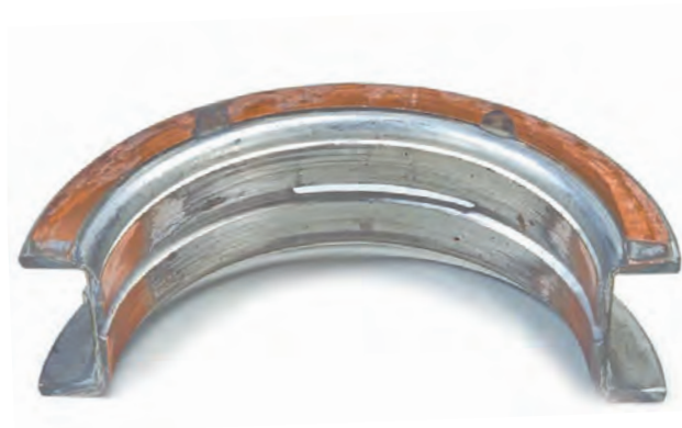
Fig. 1a Desgaste en la superficie de rodadura cerca de la junta de separación del cojinete
