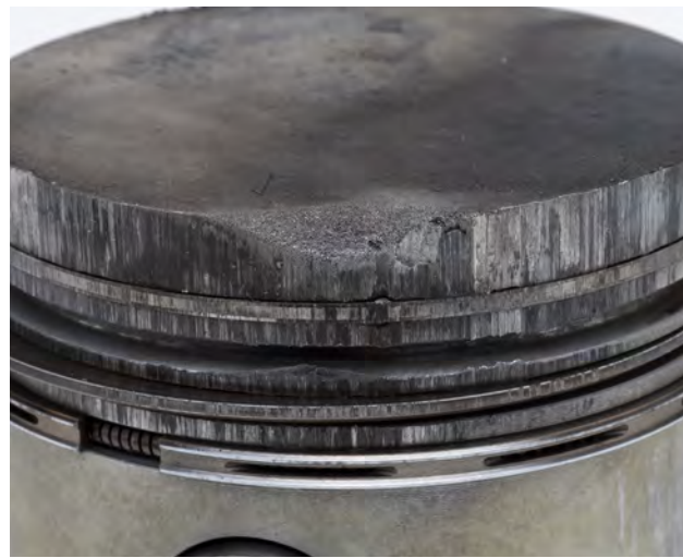
Fig. 1 Rastros de erosión en el pistón de gasolina
