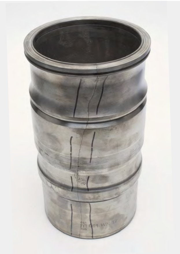
Fig. 1 Fisura longitudinal en la camisa de cilindro
