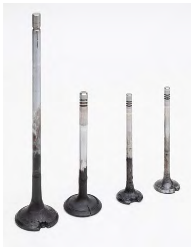
Fig. 2 Fisuras y fundiciones en diferentes etapas
