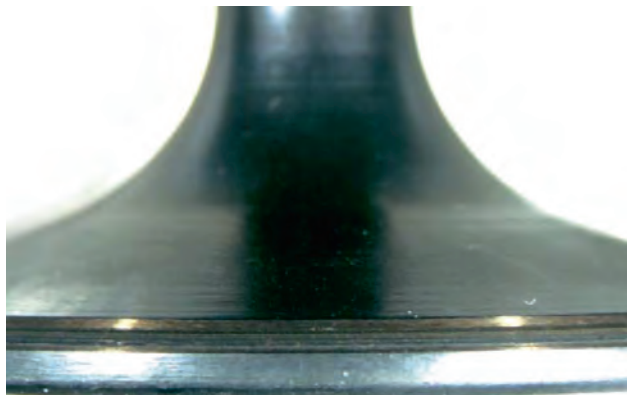
Fig. 2 A modo de comparación: platillo de válvula sin deformaciones
