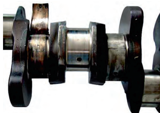
Fig. 3 Cojinetes soldados al cigüeñal
