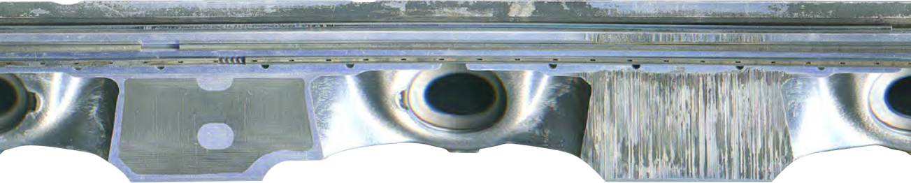
Fig. 2 Vista de gripado unilateral
