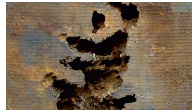
Fig. 1b Primer plano de la camisa de cilindro con bordes afilados y agujeros que se agrandan hacia adentro
