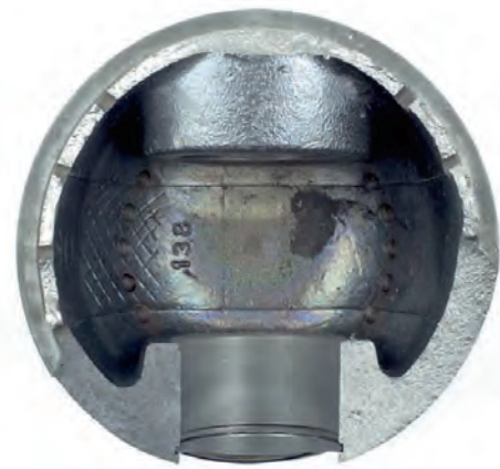
Fig. 3 Pistón roto transversalmente a la altura del eje del bulón de pistón
