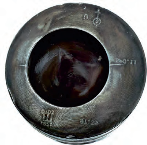
Fig. 3a Fisuras en el borde de la cavidad
