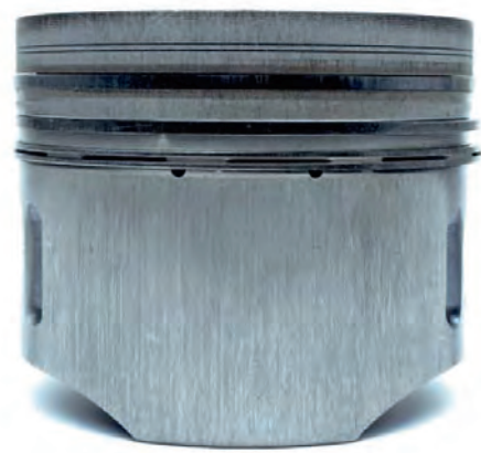
Fig. 1 Desgaste por suciedad en el pistón: estrías pronunciadas en sentido longitudinal
