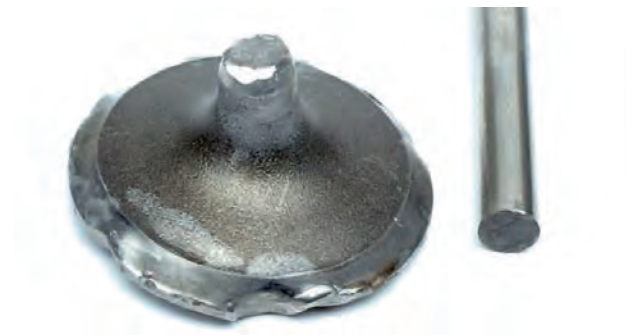
Fig. 2a Platillo de válvula roto
