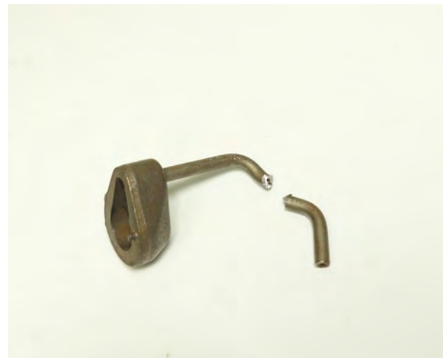
Fig. 4 Boquilla de refrigeración rota
