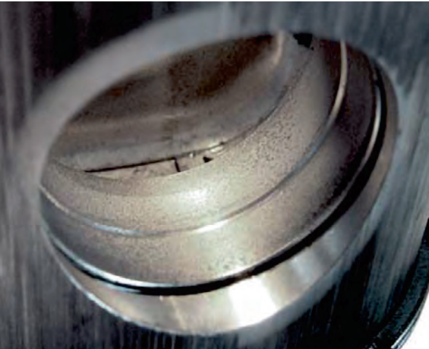
Fig. 1 Marcas en el orificio debido a aceite de motor diluido
