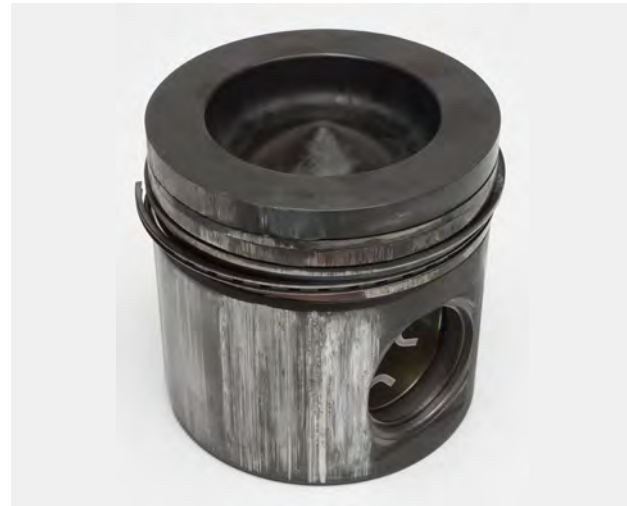
Fig. 2 Fundición en el cordón de fuego y gripado en la falda
