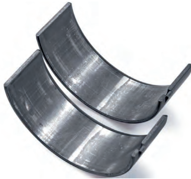
Fig. 1 Bordes exteriores de cojinete desgastados
