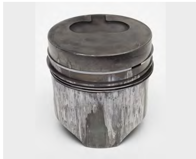
Fig. 1 Gripado en la falda de pistón
