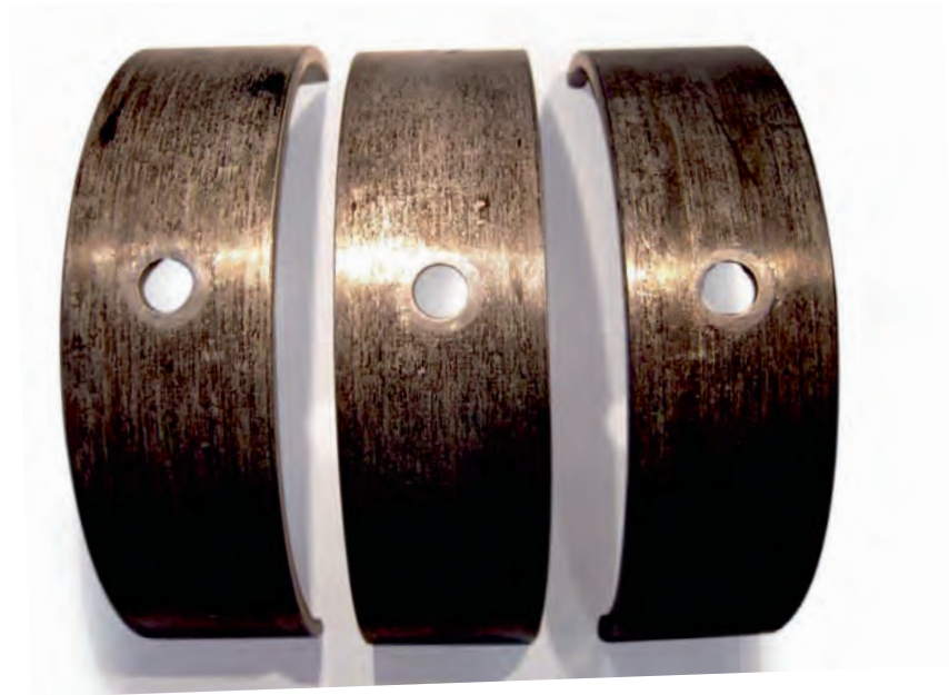
Fig. 1 Puntos pulidos en la parte exterior de los cojinetes
