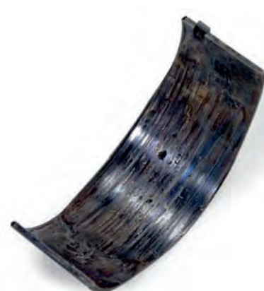
Fig. 2 Cojinete muy desgastado
