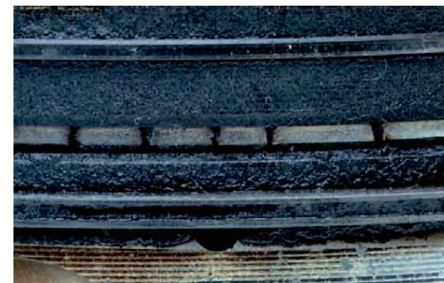
Fig. 2b Primer plano de una rotura de segmento
