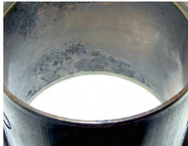
Fig. 2 Casquillo de biela dañado
