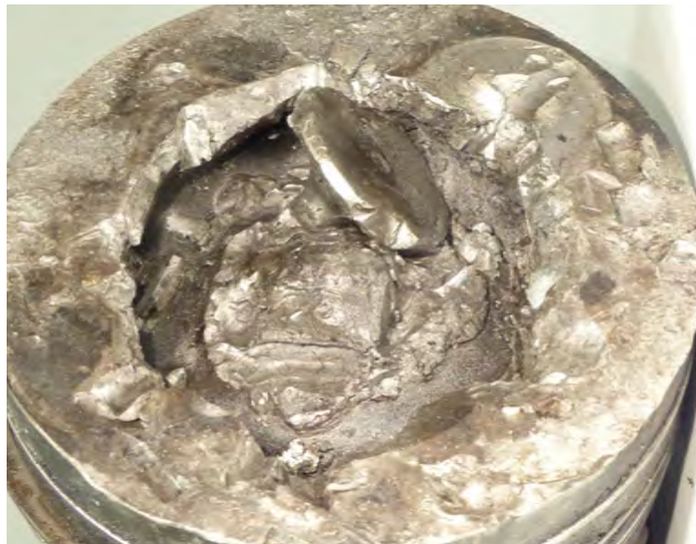
Fig. 1 Platillo de válvula roto y empotrado en el pistón
