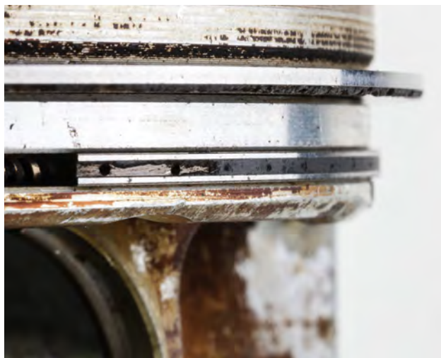
Fig. 2 Segmento de engrase obstruido
