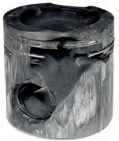
Fig. 3 Pistón de diésel quemado
