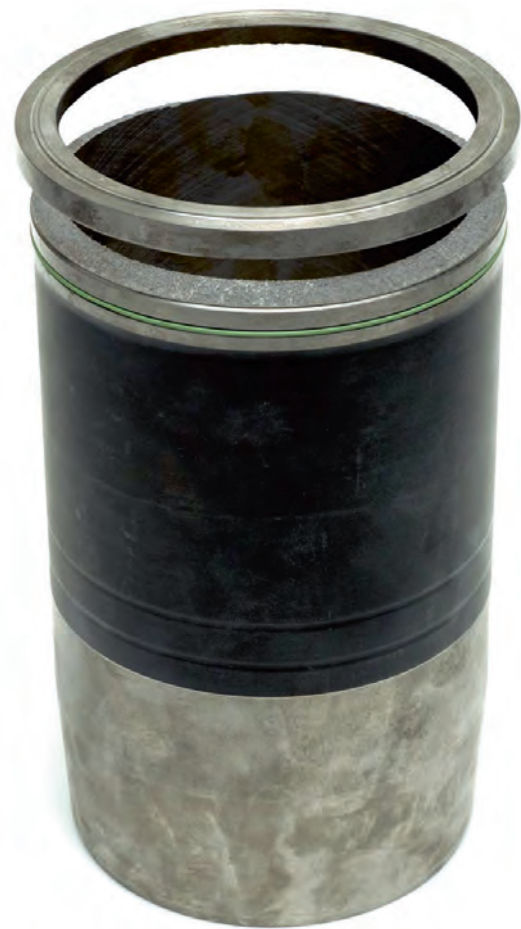
Fig. 1 Collarín de camisa de cilindro roto
