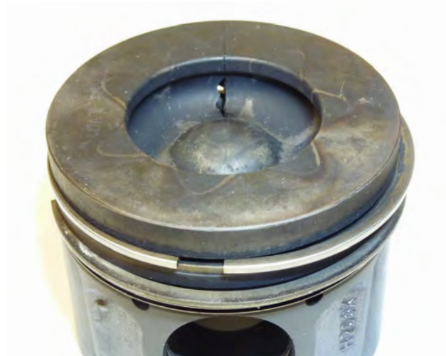
Fig. 1 Fisuras en el borde de la cavidad
