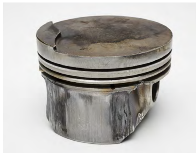
Fig. 2 Gripado lateral del pistón junto al orificio
