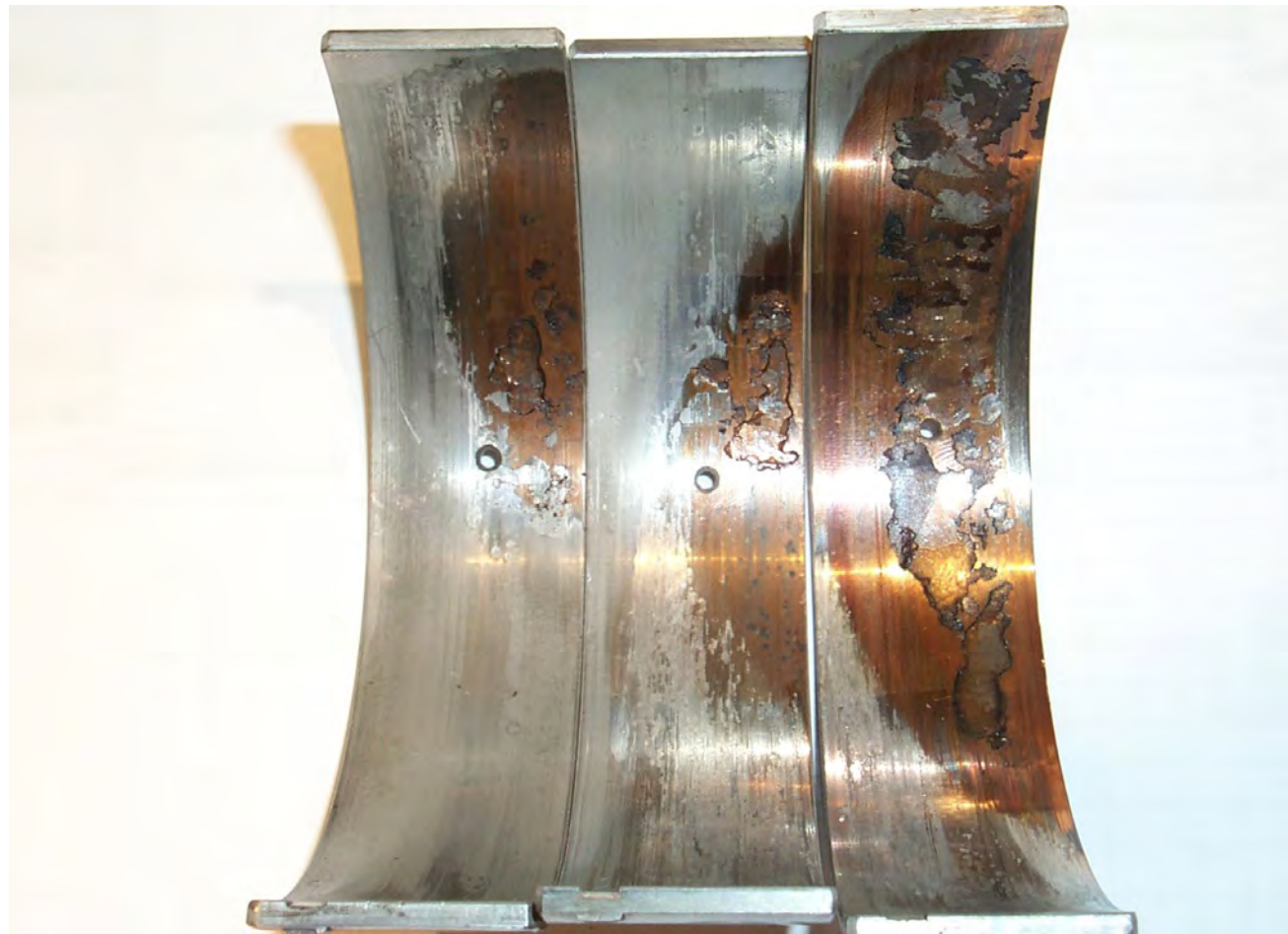
Fig. 1 Desprendimiento de material causado por sobrecarga mecánica o capacidad de carga insuficiente de la película de aceite
