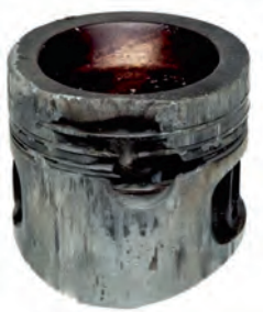
Fig. 2 Cordón de fuego fundido en el pistón de gasolina
