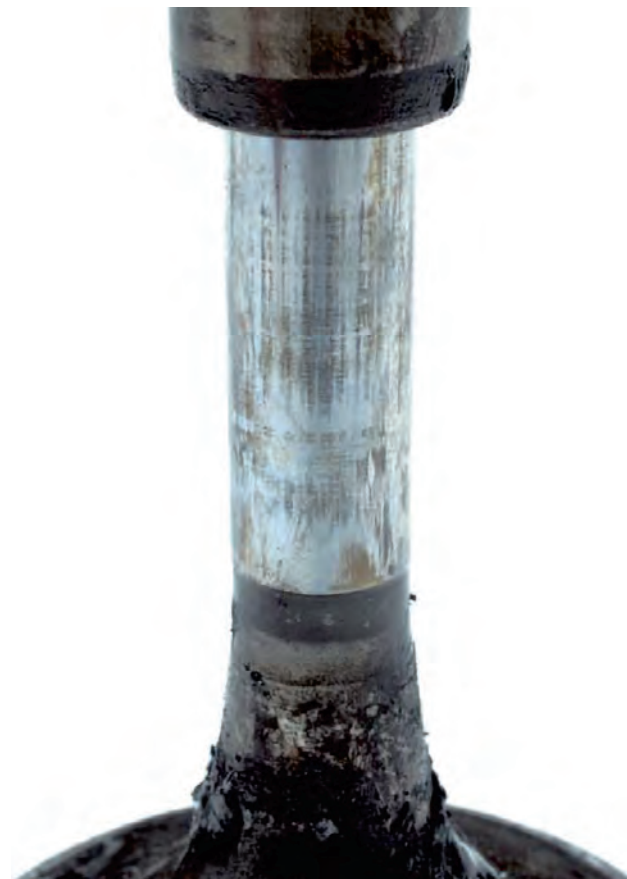
Fig. 1b Gripado y estrías en el vástago de válvula
