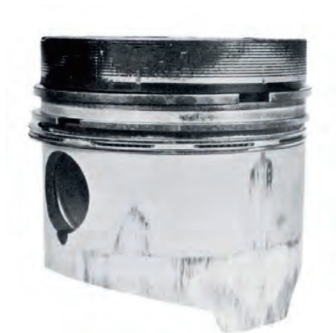
Fig. 1 Gripado en la falda inferior del pistón debido al estrangulamiento de la camisa
