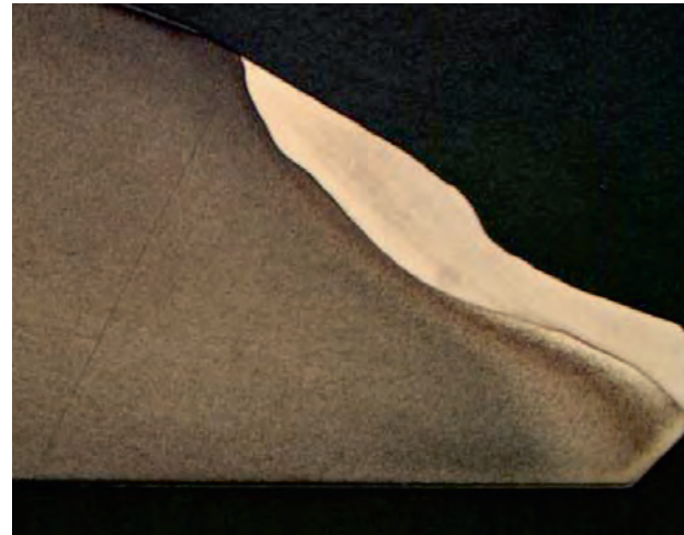
Fig. 3 Superficie de sellado extremadamente desgastada (blindaje de estelita)
