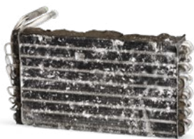
Sem manutenção do sistema de A/C
