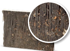
Sem manutenção do sistema de A/C
