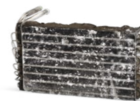
Bez konserwacji klimatyzacji
