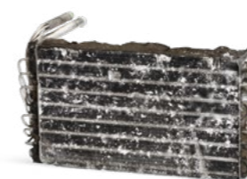
Senza manutenzione del sistema A/C
