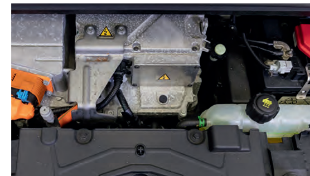
Komponenty wysokiego napięcia w komorze silnika
