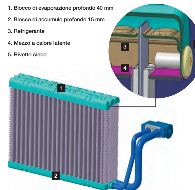
Rappresentazione schematica – evaporatore ad accumulo
