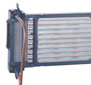
Riscaldatore ausiliario ad alta tensione/elettrico
