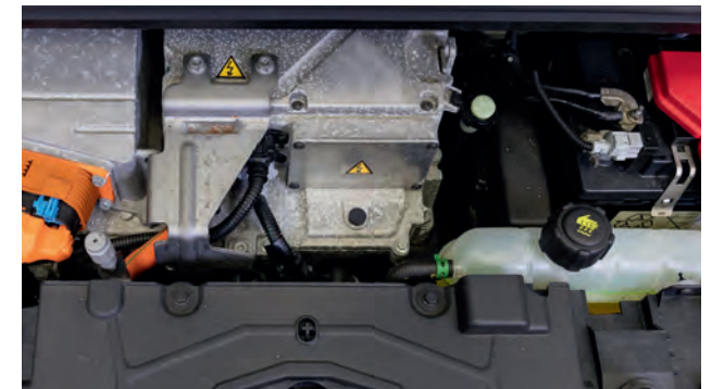
Componenti ad alta tensione del vano motore
