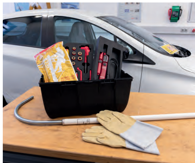
Strumenti per gli interventi su impianti ad alta tensione
