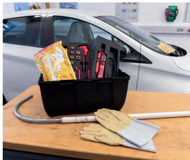
Outillage pour les interventions sur le système haute tension
