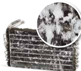
Brez vzdrževanja klimatske naprave
