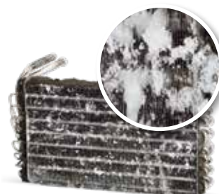
Fără întreținerea climatizării
