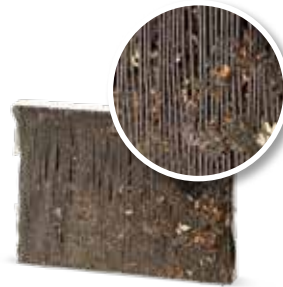
Sem manutenção do ar-condicionado
